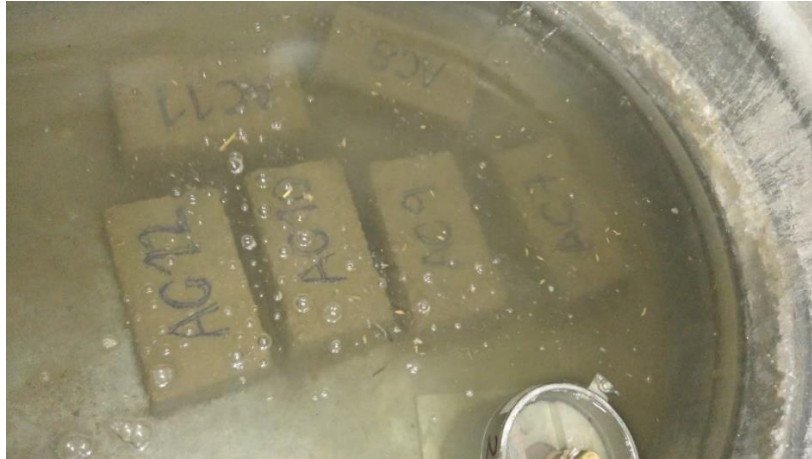
Figura 29. Adobes convencionales sumergidos en el tanque para curado de probetas de concreto.
