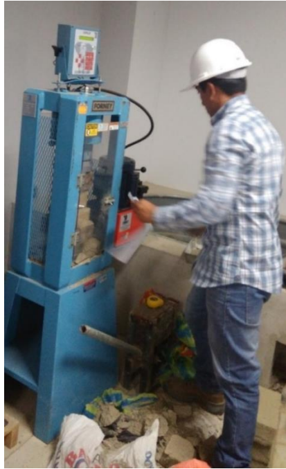
Figura 21. Ensayo de compresión en cubos.
