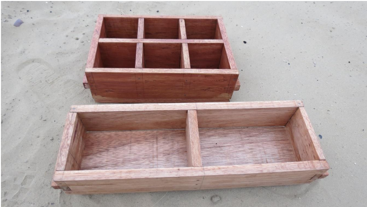
Figura 4. Moldes o gaveras utilizados para elaboración del adobe.
