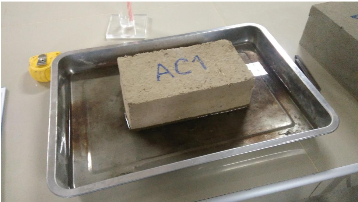
Figura 26. Especímen A.C.1 sometido a la prueba de succión
