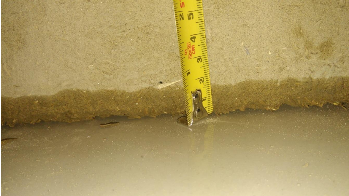
Figura 27. Medición del ascenso capilar en espécimen de adobe convencional. En la figura 27 se observa el ascenso capilar de 1.5cm registrado en unidades de adobe convencional durante la prueba de succión
