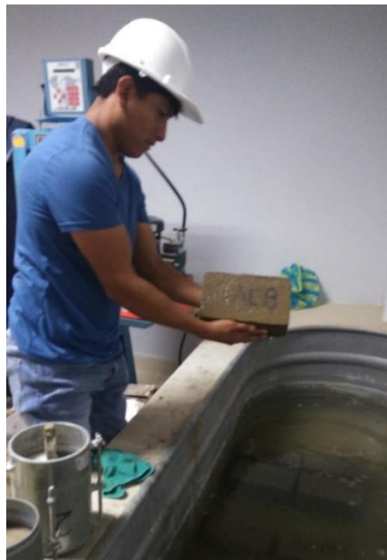
Figura 32. Extracción de espécimen A.C.8 finalizado la prueba de absorción. En la figura 32 muestra el espécimen A.E.8 retirado del tanque de curado para concreto, este mantiene su forma y cohesión aun en el estado saturado en el que se encuentra.
