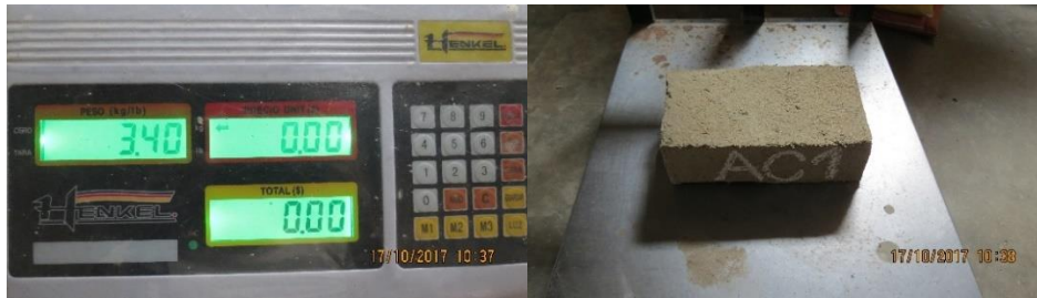
Figura 14. Espécimen A.C.1 utilizado en el control de peso por pérdida de humedad. El peso mostrado en la figura 14 corresponde al espécimen A.C.1 la balanza arrojó un valor de 3.40 kg.
