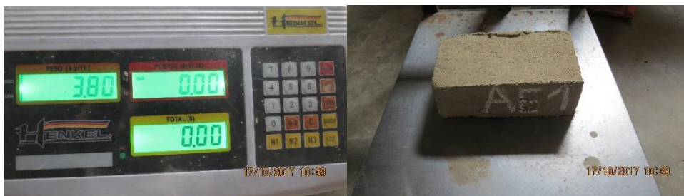
Figura 16. Espécimen A.E.1 utilizado en el control de peso por pérdida de humedad. El peso mostrado en la figura 16 pertenece al espécimen A.E.1 la balanza arrojó un valor de 3.80 kg., tomados con fecha 17/10/2017.
