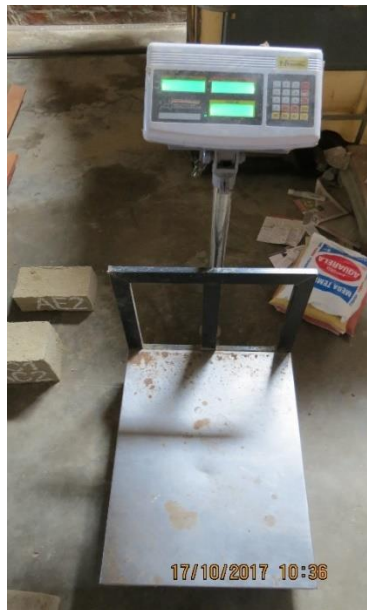
Figura 13. Balanza utilizada para el control de peso por pérdida de humedad. La balanza que se observa en la figura 13, fue utilizada para el control de peso por pérdida de humedad, cuyos valores de peso en la balanza son en kilogramos (Kg.)
