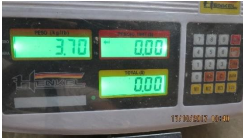
Figura 17. Espécimen A.E.2 utilizado en el control de peso por pérdida de humedad. El peso mostrado en la figura 17 corresponde al espécimen A.E.2 la balanza arrojo un valor de 3.70 kg., tomados con fecha 17/10/2017.
