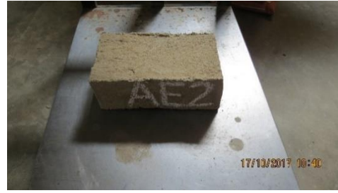
Figura 17. Espécimen A.E.2 utilizado en el control de peso por pérdida de humedad. El peso mostrado en la figura 17 corresponde al espécimen A.E.2 la balanza arrojo un valor de 3.70 kg., tomados con fecha 17/10/2017.
