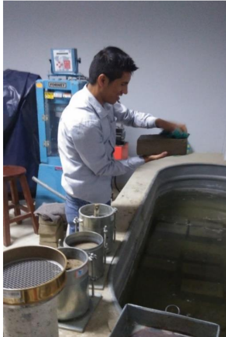
Figura 31. Secado de adobes estabilizados finalizado la prueba de absorción. Concluida la prueba de absorción se extrajo los especímenes tal como se muestra en la figura 31, los mismos que se secaron con un paño húmedo para que luego de 5 minutos se proceda a pesar.
