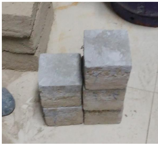
Figura 18. Cubos de adobe convencional utilizados para el ensayo de compresión. En la figura 18 se observan los cubos de adobe convencional con una capa de yeso y cemento para nivelar la superficie del mismo, con la finalidad de que la carga sea aplicada de manera uniforme.
