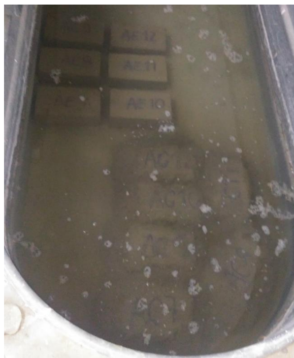
Figura 30. Estado final de adobes tras el ensayo de absorción.
