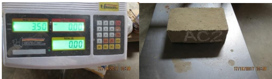
Figura 15. Espécimen A.C.2 utilizado en el control de peso por pérdida de humedad. El peso mostrado en la figura 15 pertenece al espécimen A.C.2 la balanza arrojó un valor de 3.50 kg.
