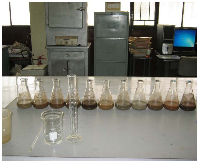
Fuente: Desarrollo de investigación. (Laboratorio de minería y medio ambiente FIGMM – UNI) Figura N° 15: Prueba NAG lista para realizar mediciones.
