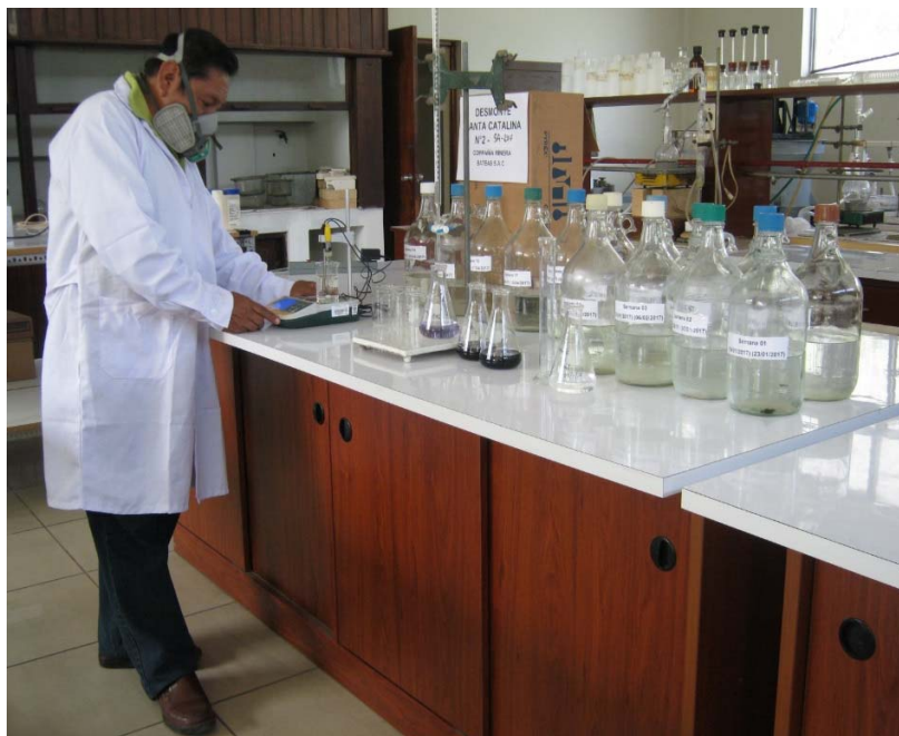
Fuente desarrollo de Investigación Figura N° 23: Midiendo el pH de las soluciones extraídas.
