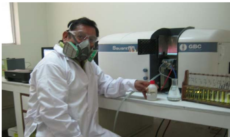
Fuente: Desarrollo de investigación (Laboratorio de minería y medio ambiente FIGMM – UNI). Figura N° 19: Lectura por Absorción Atómica de la composición química del desmonte
