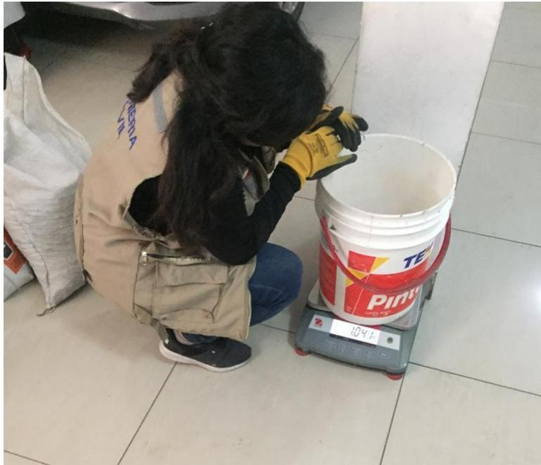
Pesando el balde para tararlo y no afecte el peso de los agregados
