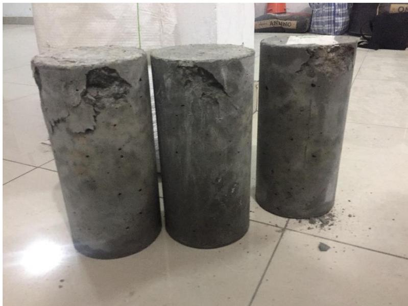
Especímenes sometidos al ensayo de resistencia a la compresión
