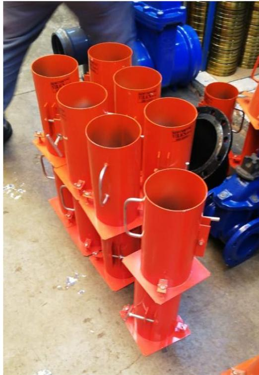
Probetas para ensayo a la compresión
