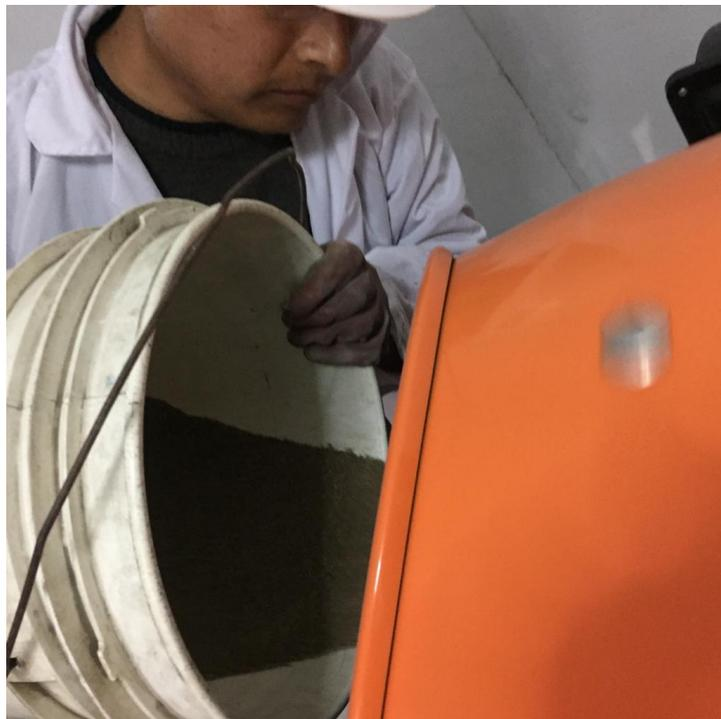
Vaciado de la arena dentro de la mezcladora
