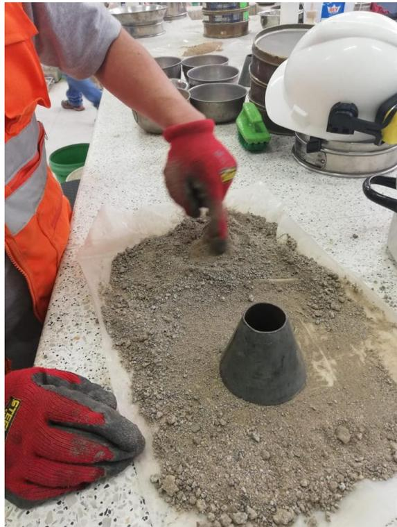
Colocación del agregado en el cono
