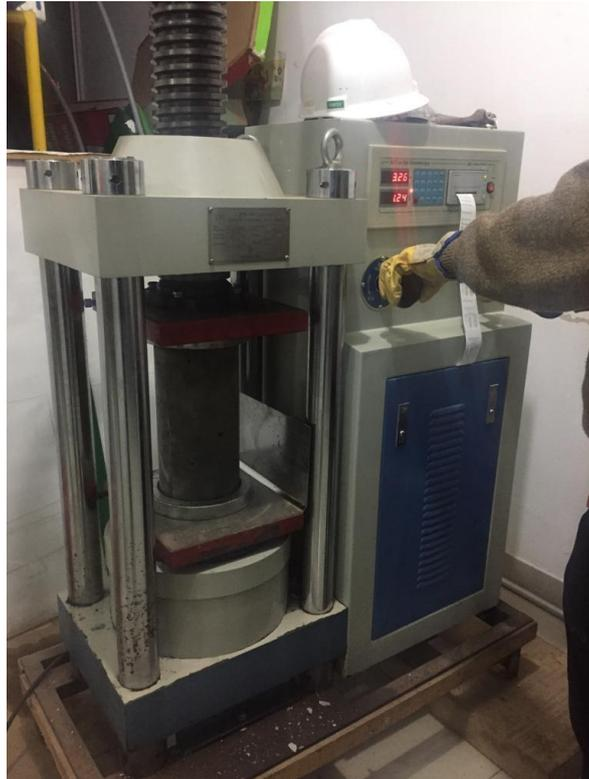
Ensayo de resistencia a la compresión
