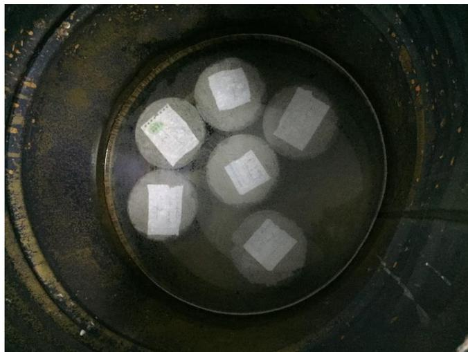
Se saturan las probetas
