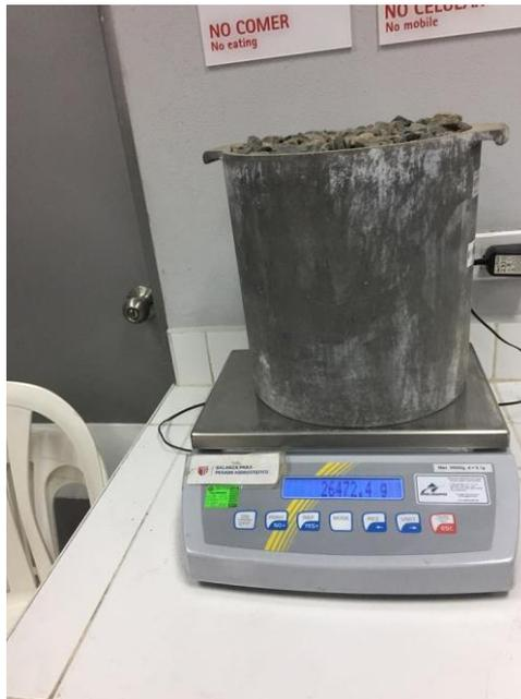
Se pesa la tara con el agregado compactado.
