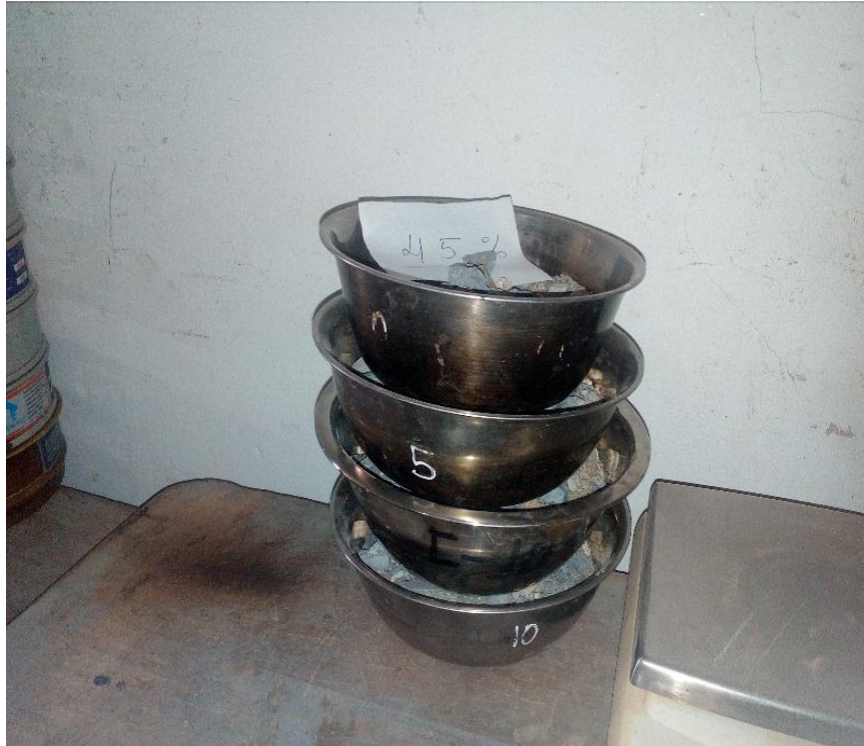
Fotografía 133. Dosificación de los agregados para un 4.5% de Cemento Asfáltico PEN 60/70
