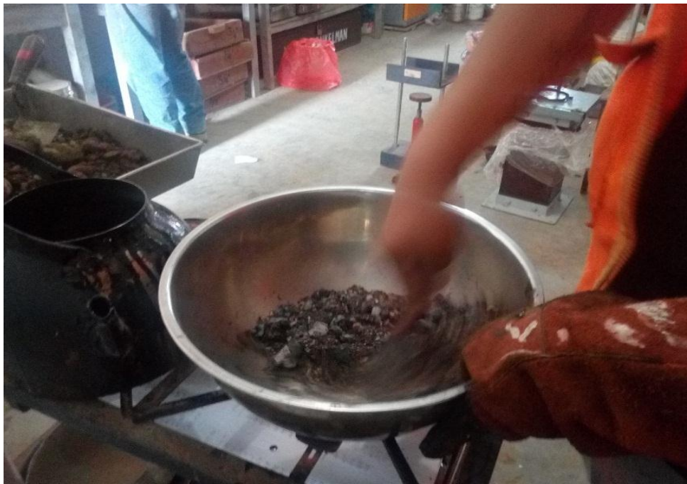
Fotografía 138. Mezclado de los agregados con el Cemento Asfáltico PEN 60/70
