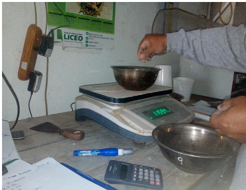
Fotografía 134. Dosificación de los agregados para un 4.5% de Cemento Asfáltico PEN 60/70
