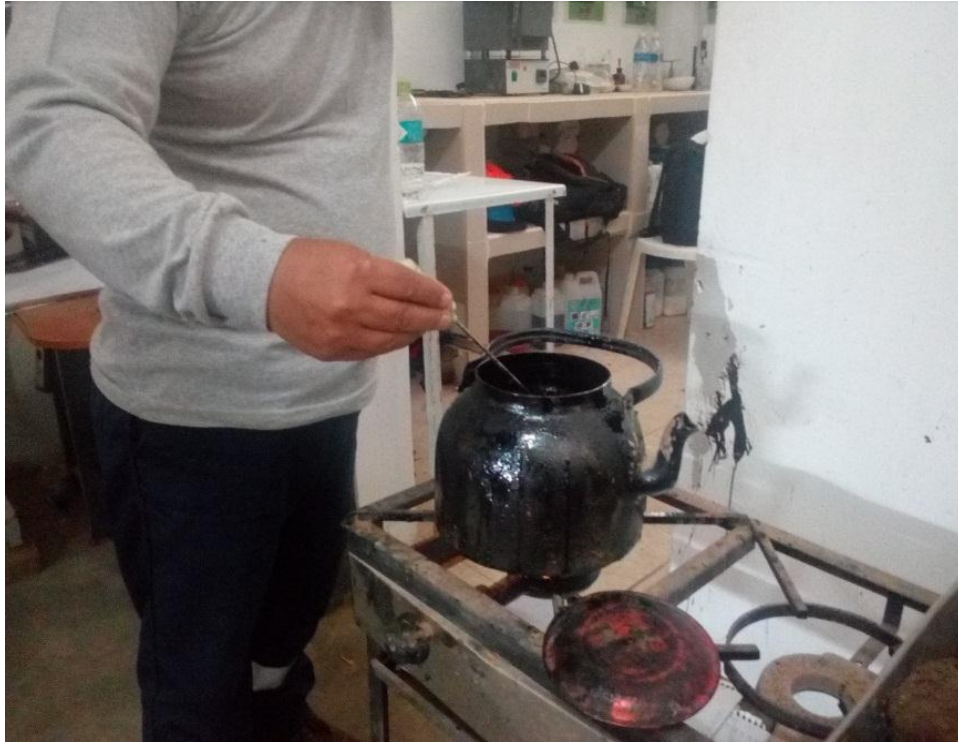
Fotografía 137. Calentado del Cemento Asfáltico PEN 60/70
