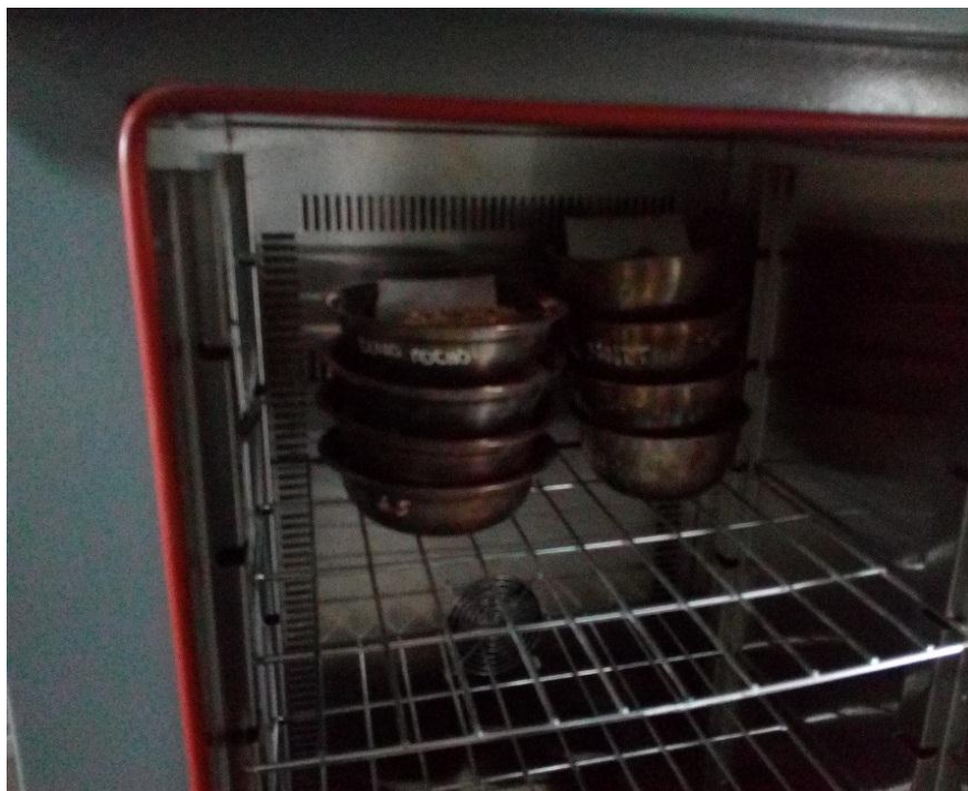
Fotografía 136. Dosificación de los agregados para un 4.5% de Cemento Asfáltico PEN 60/70
