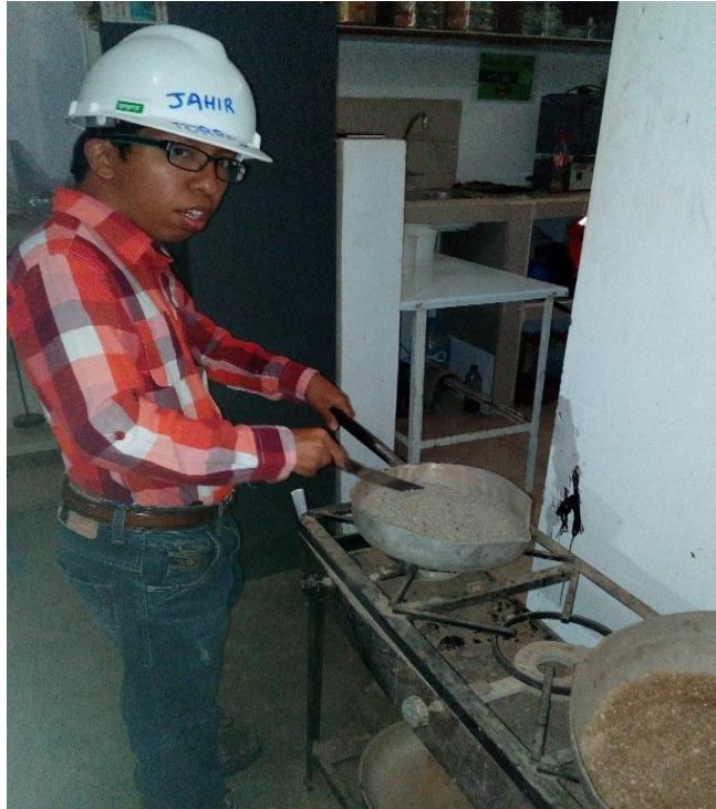
Fotografía 128. Secado de arena chancada
