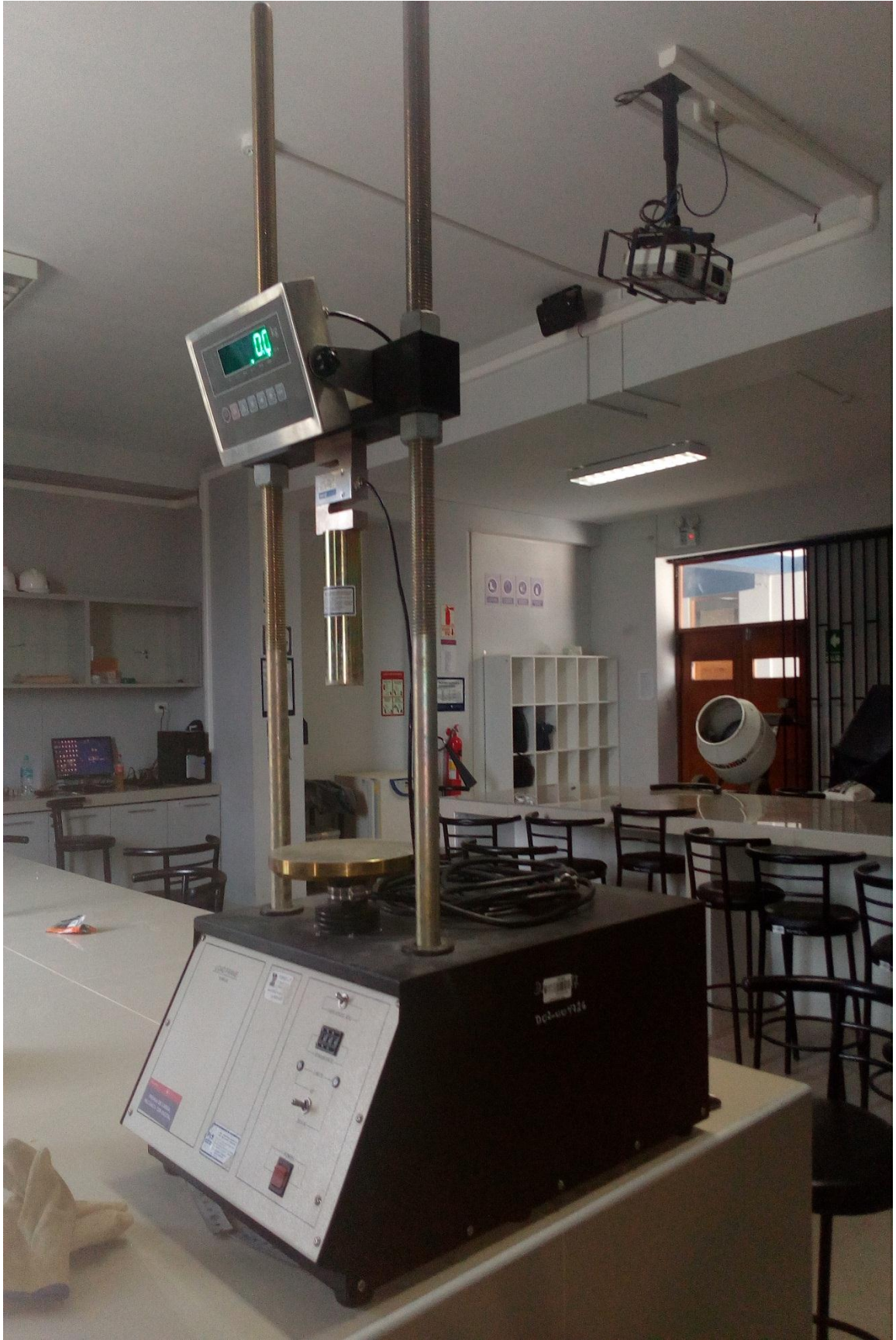
Fotografía 110. Prensa para California Bearing Ratio (CBR)
