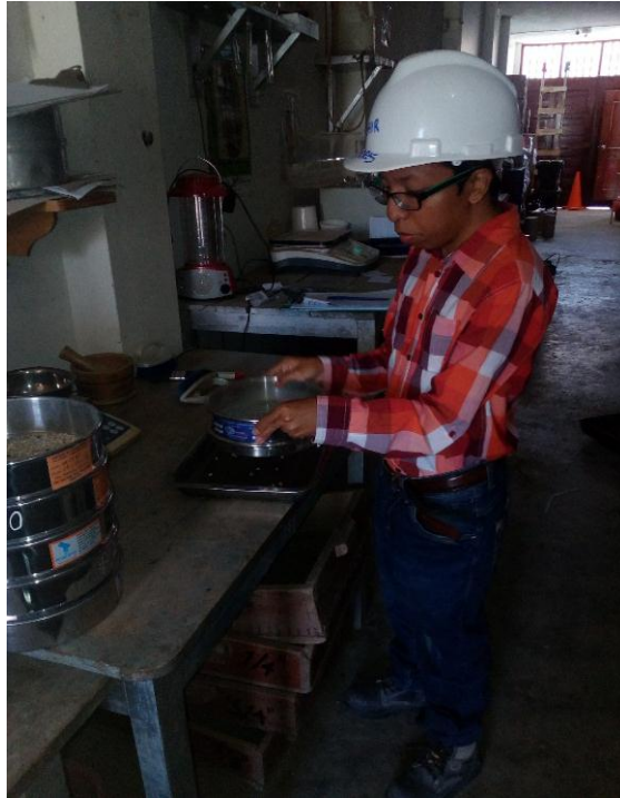
Fotografía 130. Tamizado de la arena chancada
