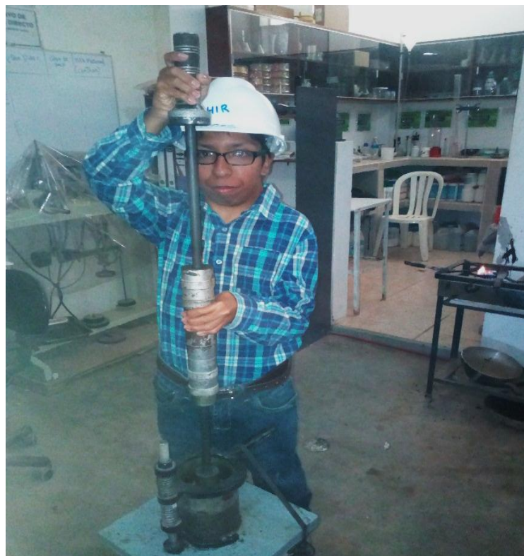
Fotografía 140. Compactación de las briquetas
