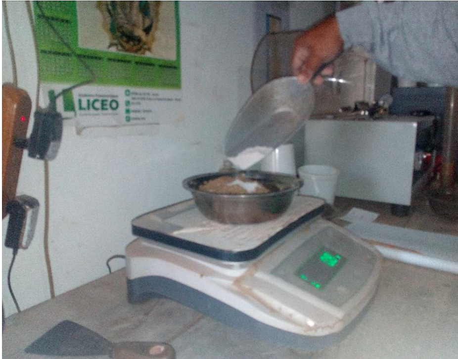
Fotografía 135. Dosificación de los agregados para un 4.5% de Cemento Asfáltico PEN 60/70
