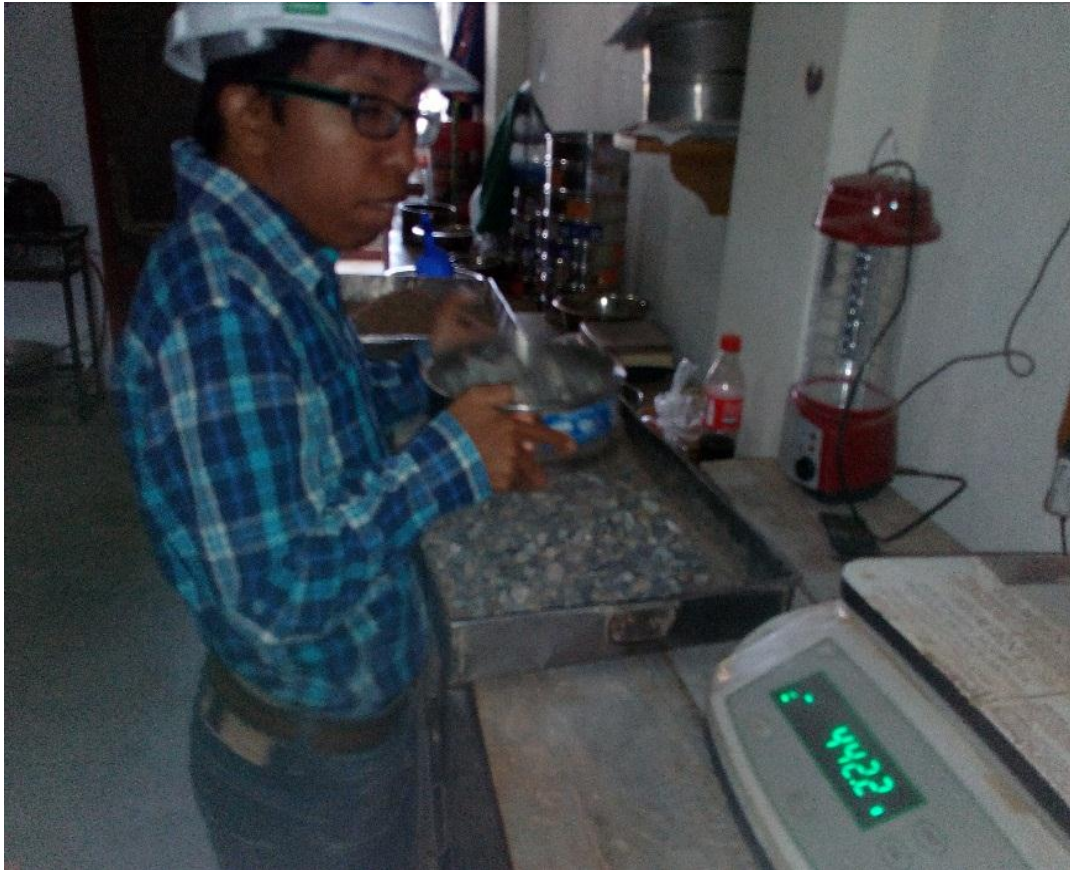
Fotografía 132. Tamizado de mezcla integral
