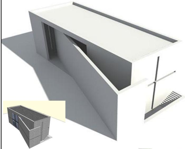
La iglesia es una caja de 6x6x18m traspasada lateralmente por un muro girado 15° con respecto al eje principal de la nave.
