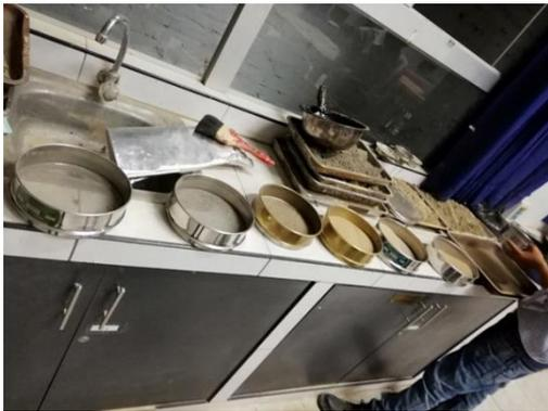
*Muestra seca de terreno natural y realización de ensayo de granulometría según tamizado.*
