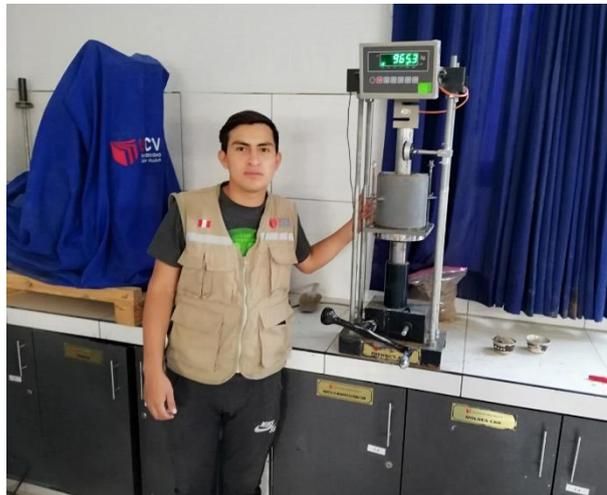
*Realización de CBR de muestra de suelo con Adición de PET reciclado.*
