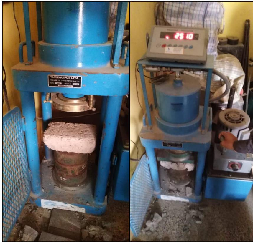
FOTO N° 14: Propiedades Mecánicas: Resistencia a la Compresión
