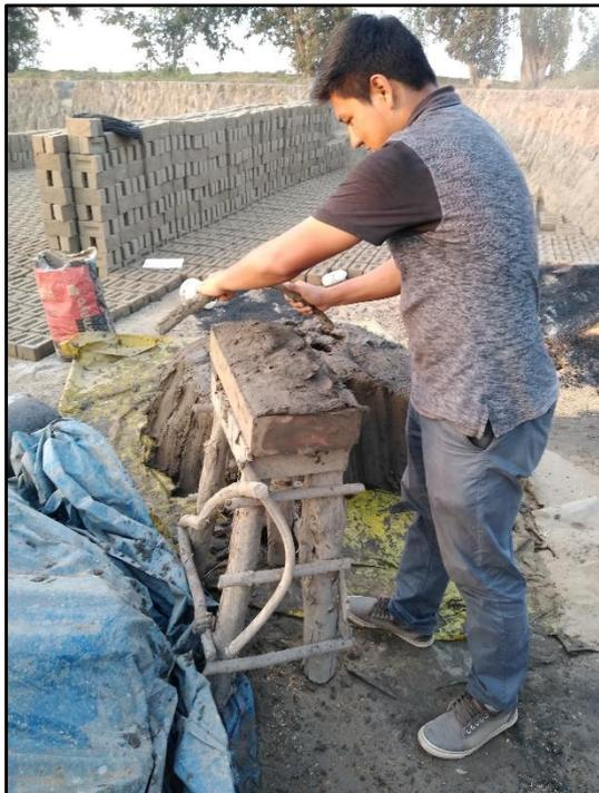
FOTO N° 09: Cortando la parte sobrante de la mezcla
