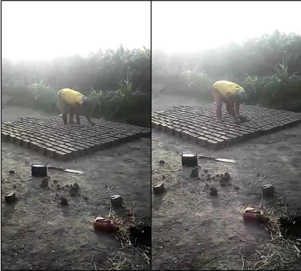
FOTO N° 13: Secado naturalmente por el viento y el sol del ladrillo ecológico
