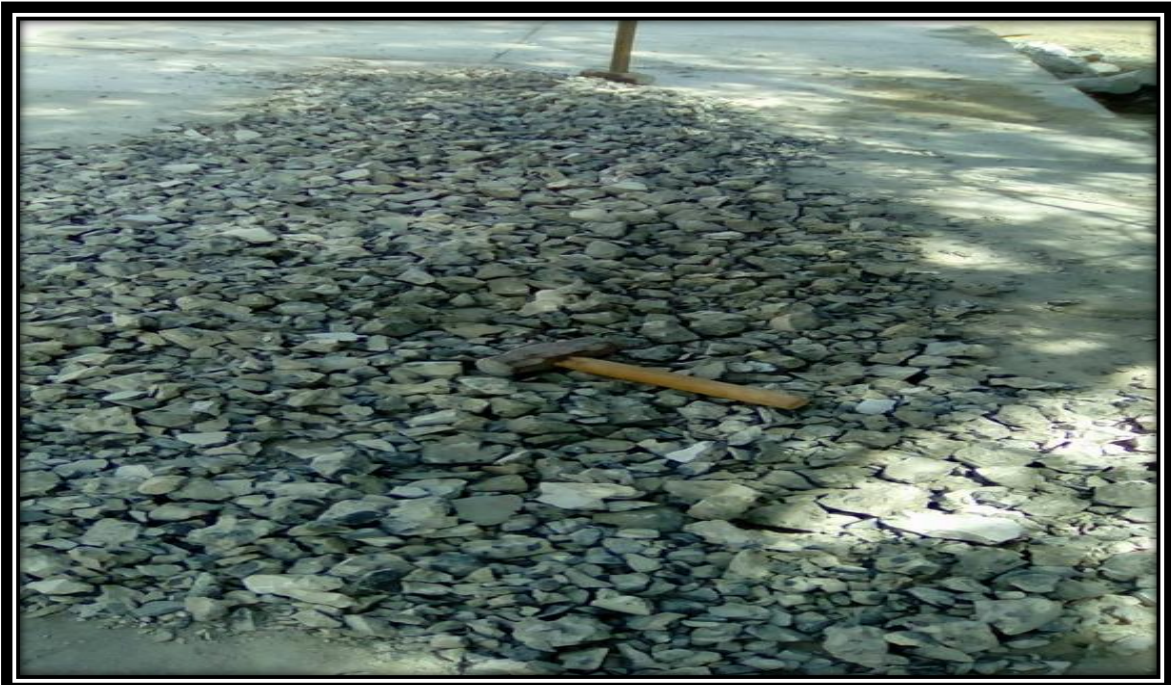
FOTO N° 04: Una vez triturado pasamos a seleccionar el agregado grueso, descartando los finos que se presentan.
