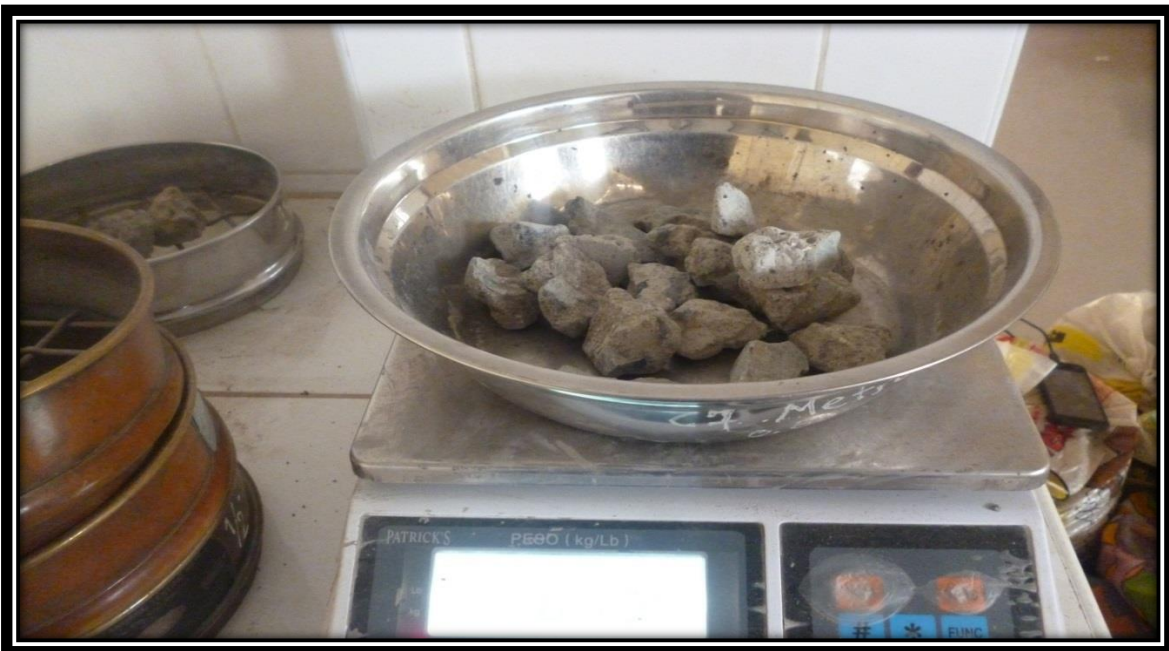
FOTO N° 10: Realizando los ensayos en laboratorio, pesando el residuo de concreto como agregado grueso para saber el % retenido en cada tamiz empleado.
