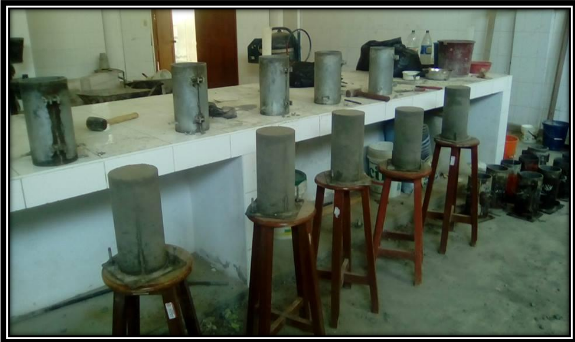
FOTO N° 27: Desencofrado cuidadosamente para no dañar las probetas.
