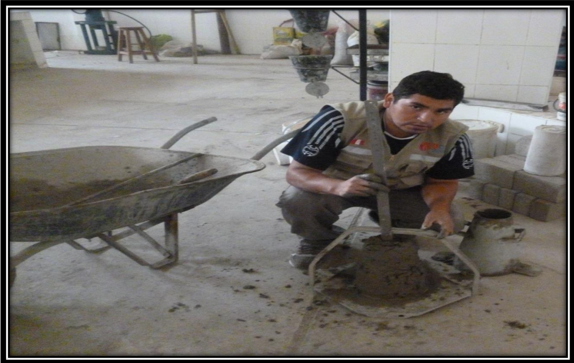
FOTO N° 21: Determinación del SLUMP del diseño de mezcla del residuo de concreto como agregado grueso.
