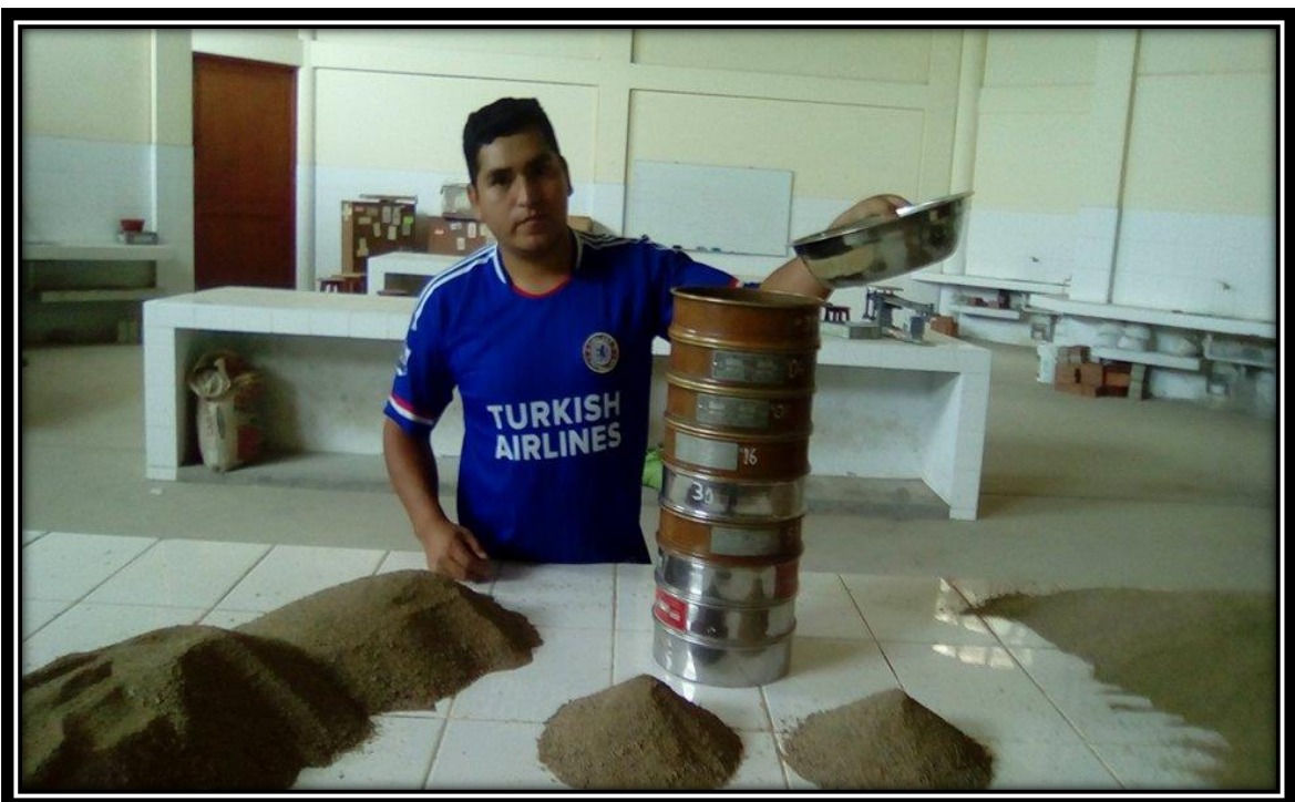
FOTO N° 08: Colocación del agregado fino en las mallas de los tamices para ensayar la granulometría.
