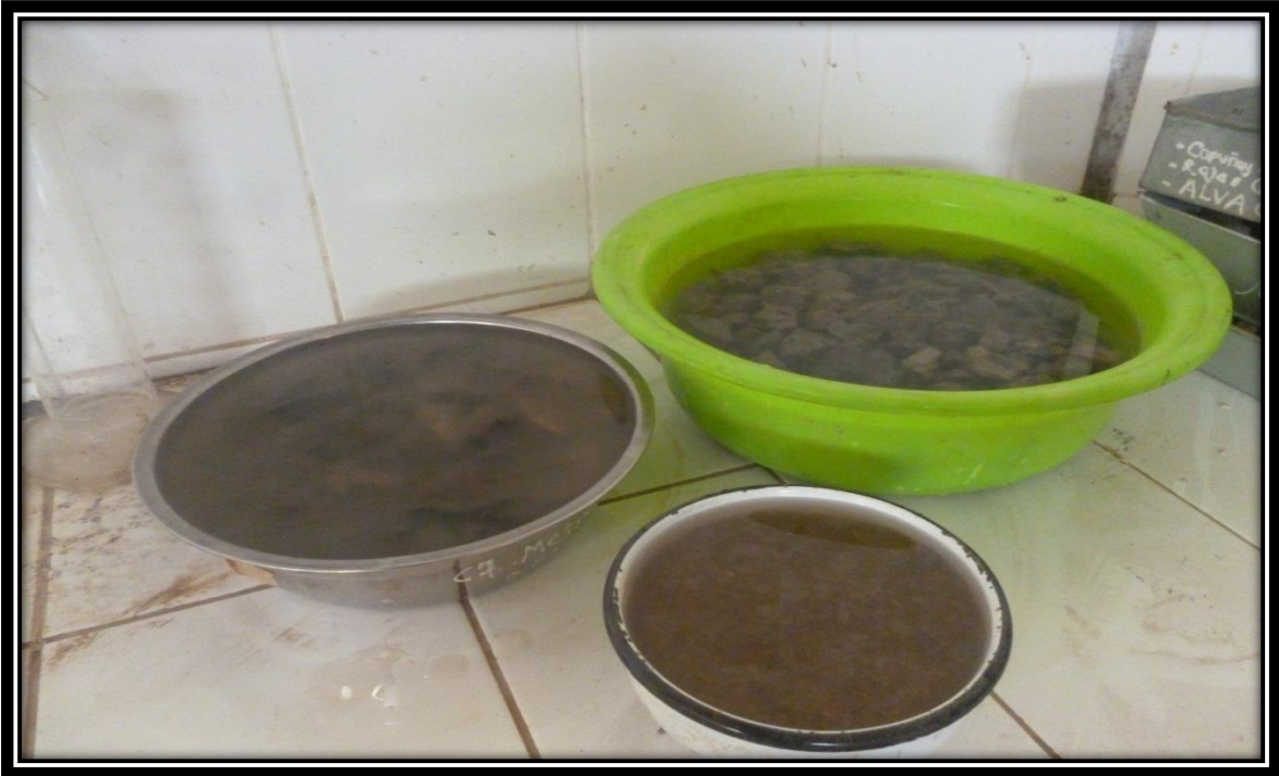
FOTO N° 13: Los materiales gruesos y finos fueron sumergidos en el agua durante 24 horas para determinar la absorción.
