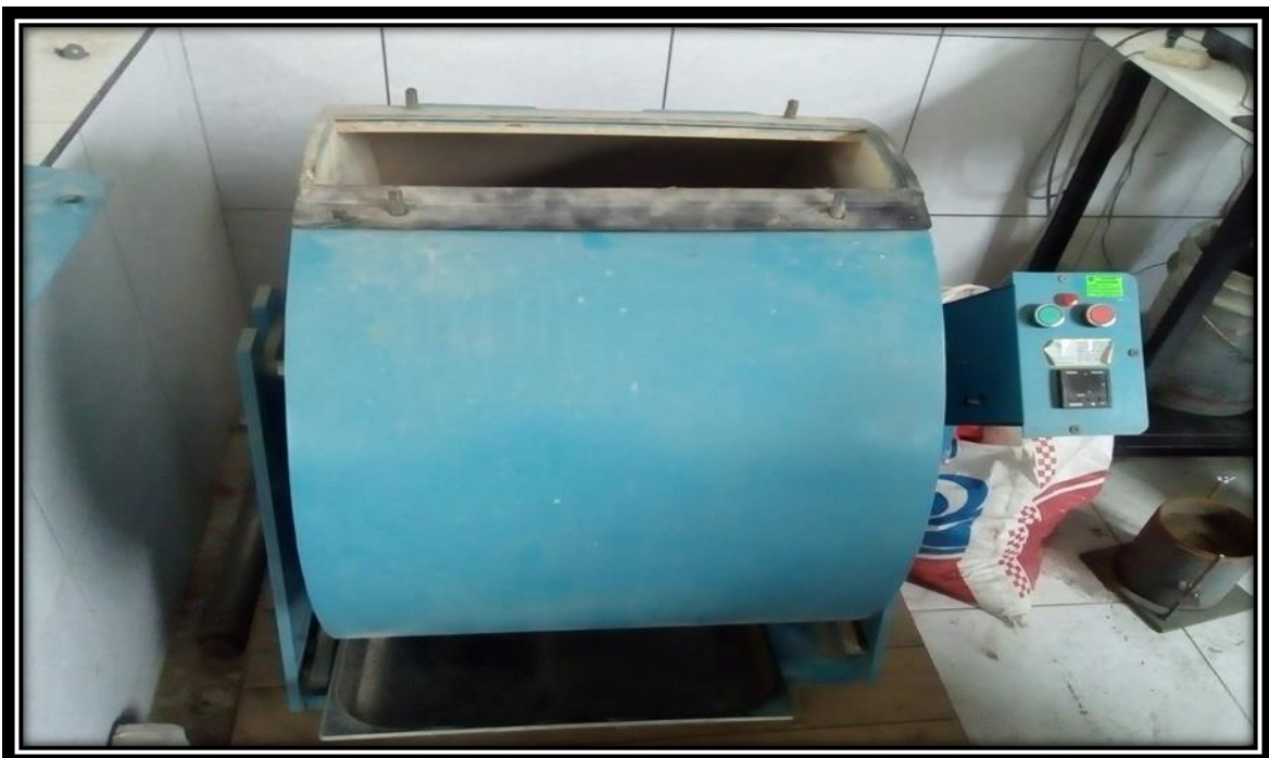
FOTO N° 16: Se observa la máquina de los Ángeles listo para realizar el ensayo de abrasión (desgaste).
