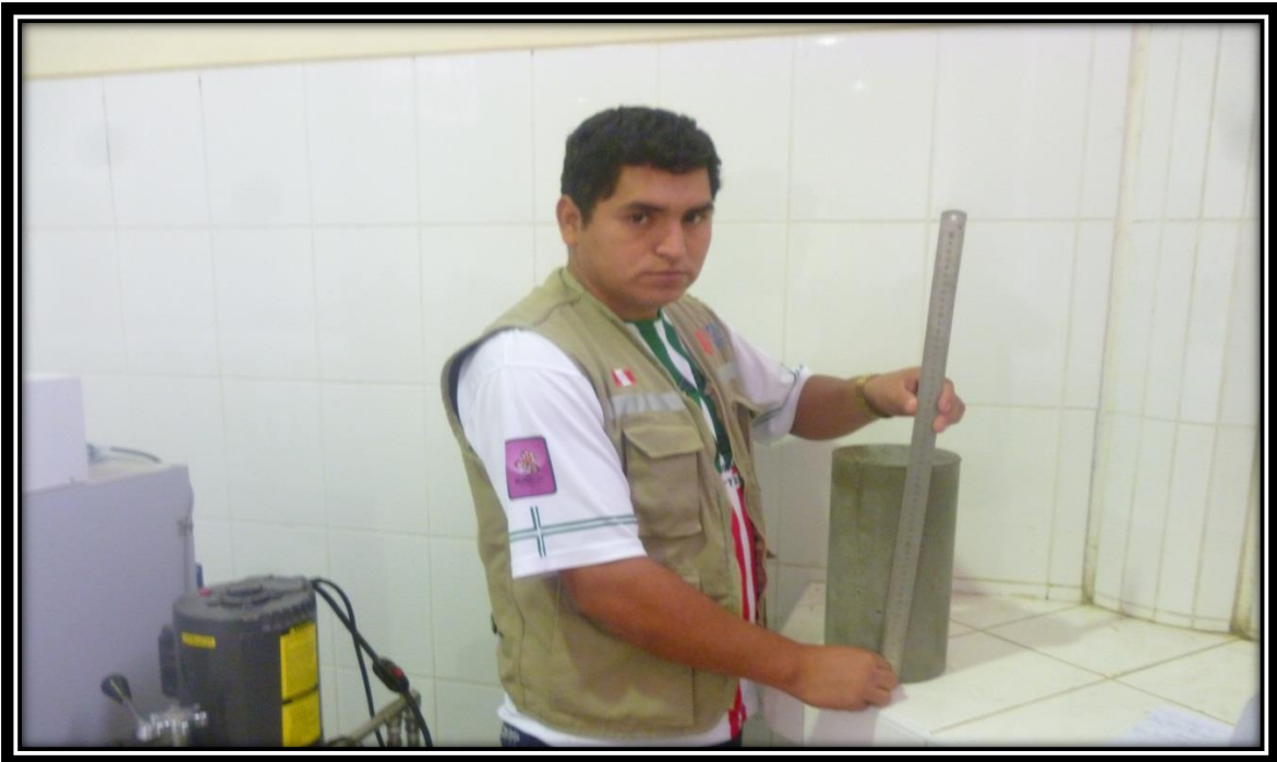
FOTO N° 29: Se está verificando las dimensiones de las probetas antes de la rotura.
