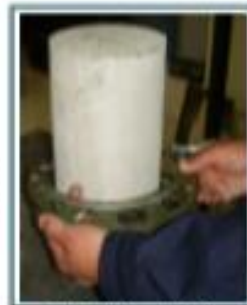
Fig. 2. Medición del diámetro del espécimen.
