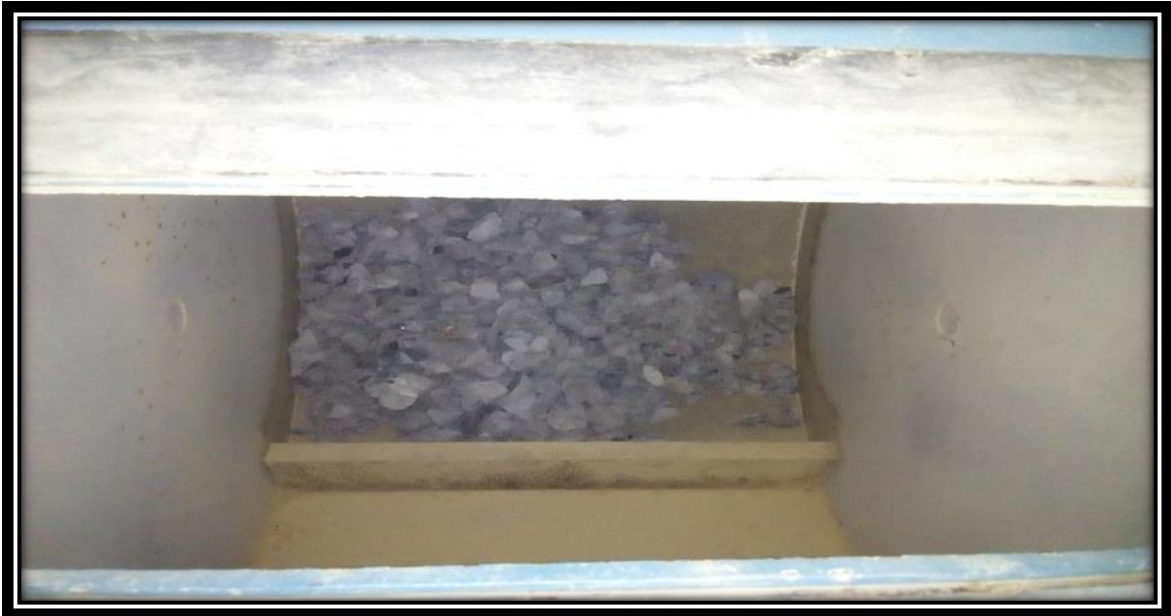
FOTO N° 17: Después de tamizar, se procedió a colocar el material de Residuos de concreto en la maquina los Ángeles un aproximado de 10 kilos de material.
