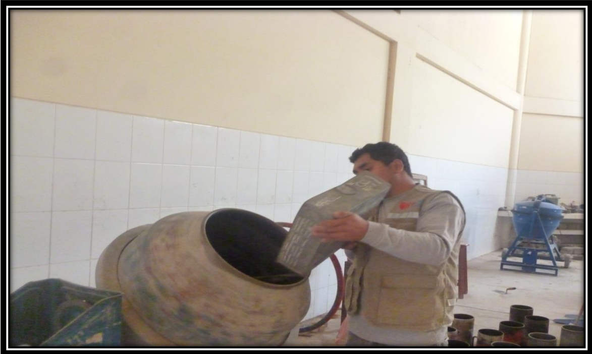
FOTO N° 19: Preparación de la mezcla patrón para determinar la consistencia o fluidez (SLUMP)
