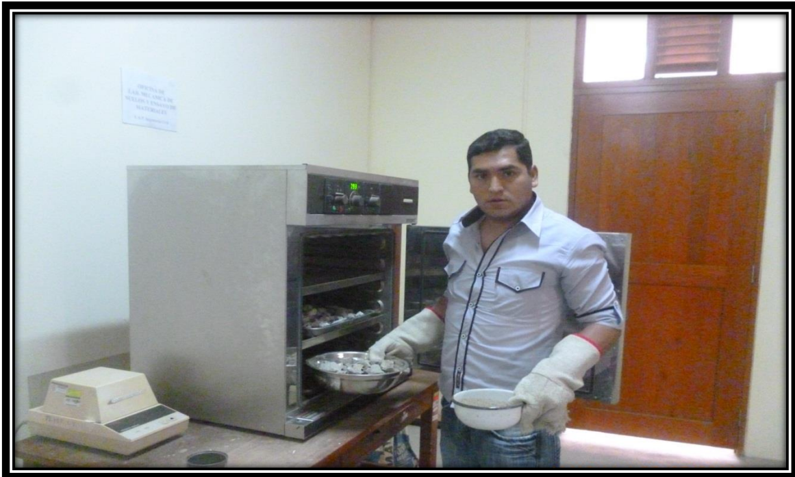
FOTO N° 11: Colocación del residuo de concreto como agregado grueso y agregado fino en el horno a una temperatura de 110 °C, durante 24 horas.
