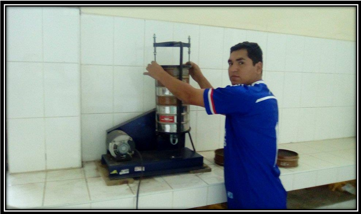
FOTO N° 09: Realizando la vibración del tamizado de los residuos reciclados de concreto, para luego ser reutilizados como agregado grueso.
