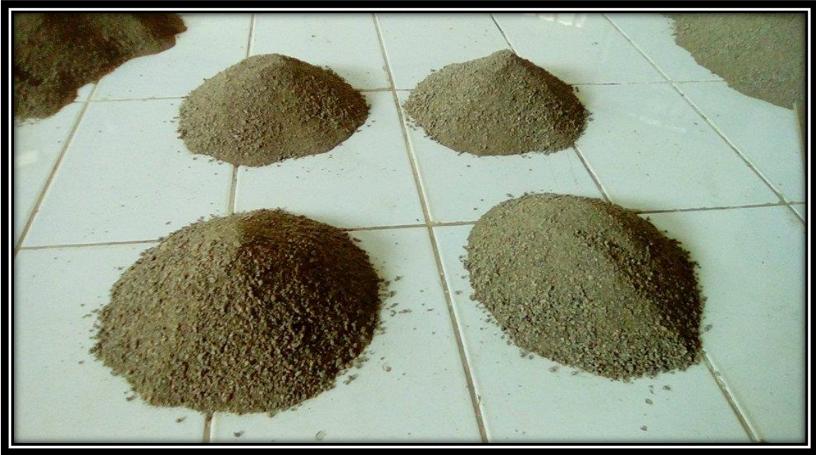
FOTO N° 07: El cuarteo del agregado fino para luego pasar a realizar el ensayo de la granulometría.
