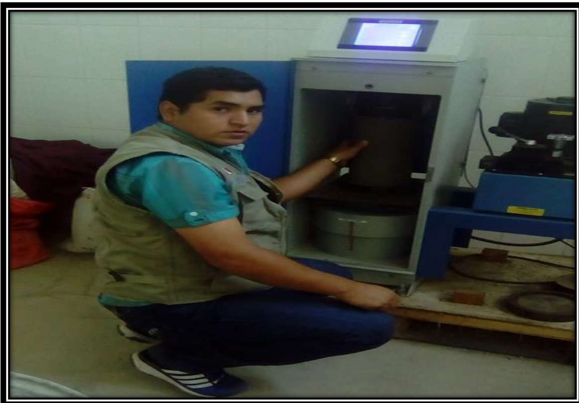
FOTO N° 32: Realizando los ensayos de resistencia a compresión de residuos de concreto como agregado grueso.
