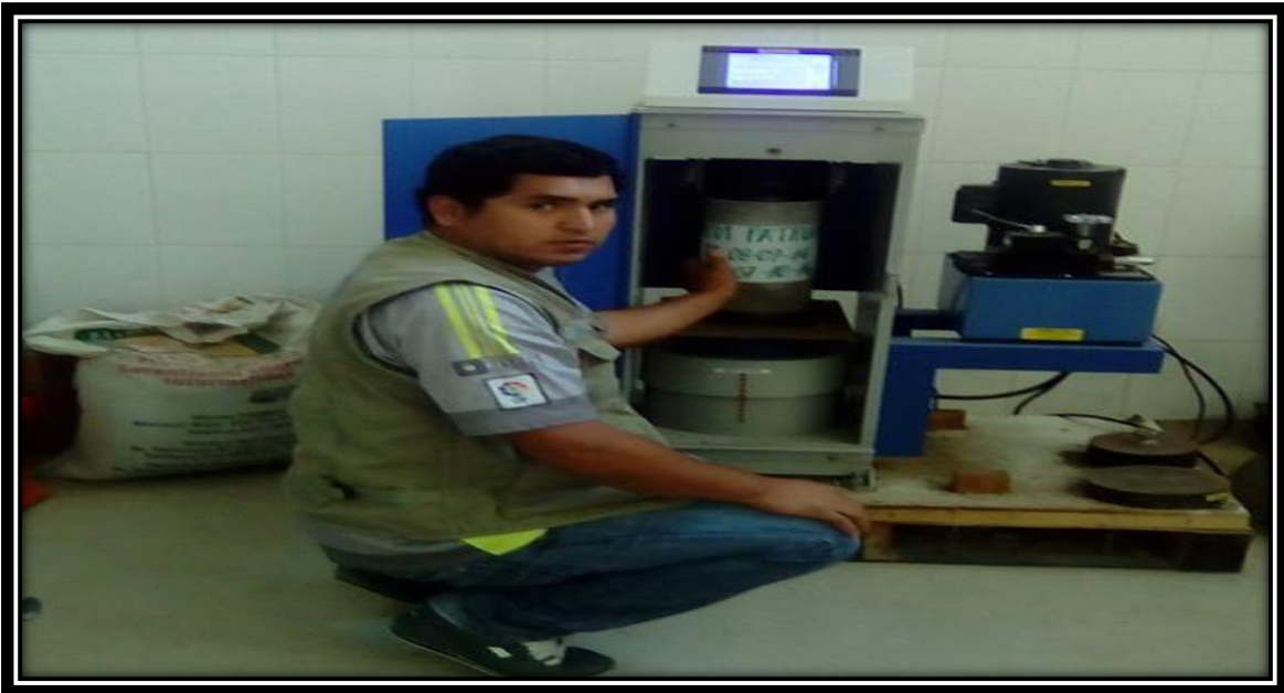
FOTO N° 31: Realizando los ensayos de resistencia a compresión de la muestra patrón.
