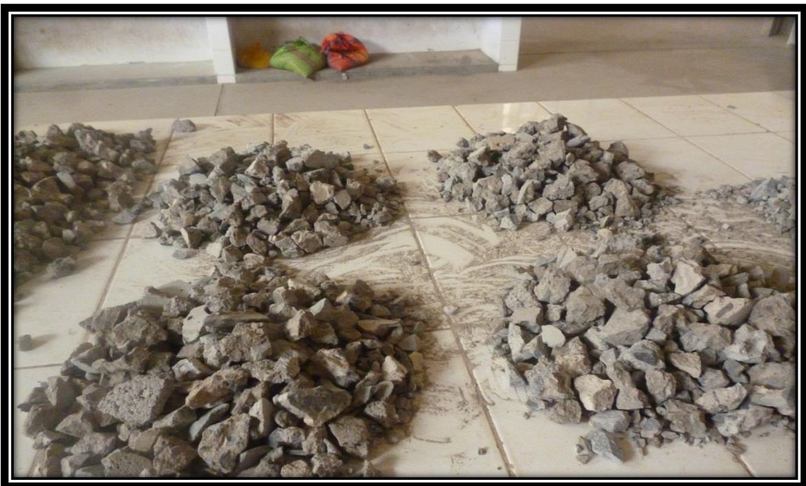
FOTO N° 06: Cuarteo del agregado grueso de residuos de concreto, para luego realizar los ensayos de la granulometría.
