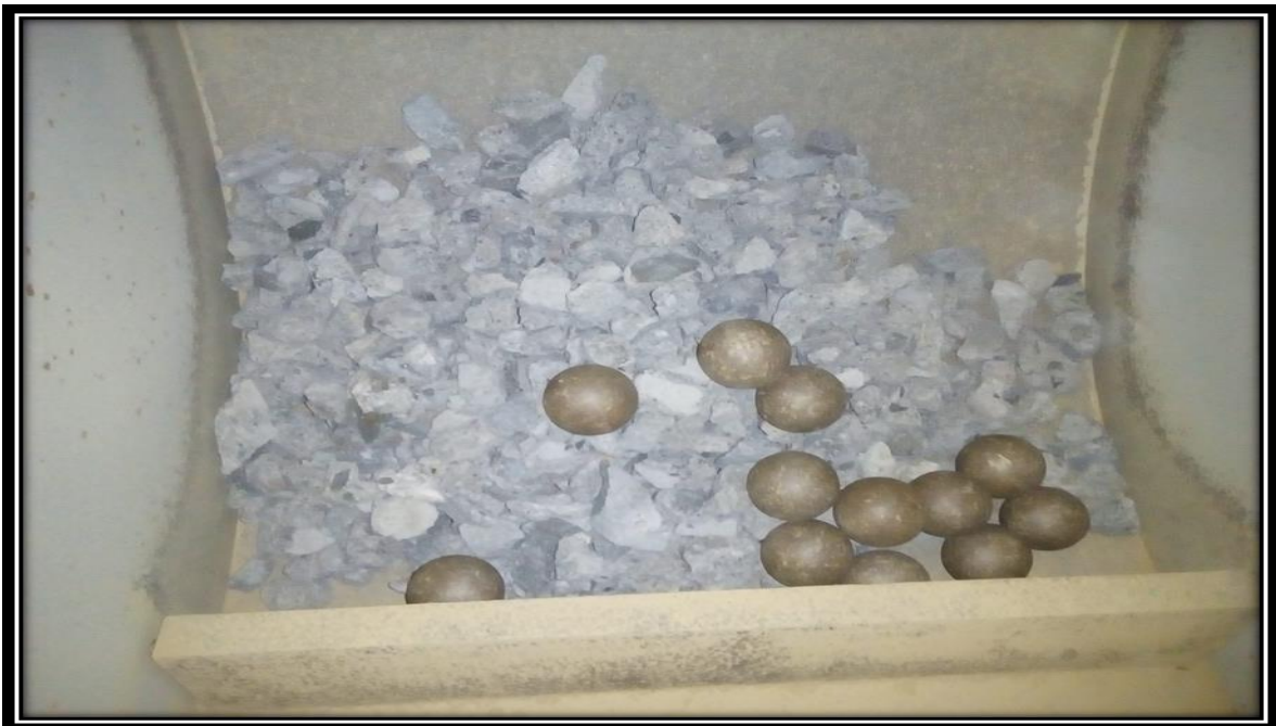
FOTO N° 18: Se observa el material de residuos de concreto en la máquina de los Ángeles junto a las 12 esferas, para la revolución y obtener el porcentaje de desgaste.
