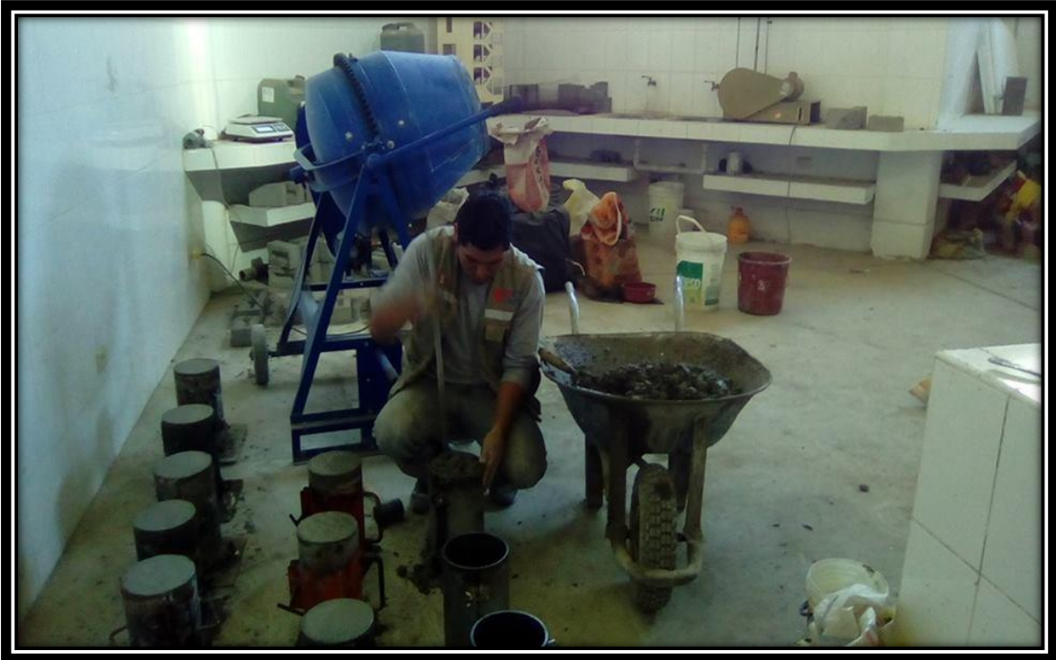
FOTO N° 25: Chuseando el concreto para evitar las cangrejas en las probetas.
