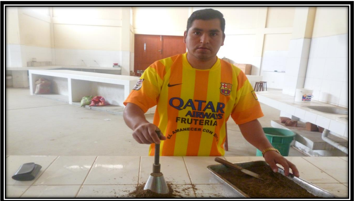
FOTO N° 14: Ensayo para determinar que el agregado fino este seco.
