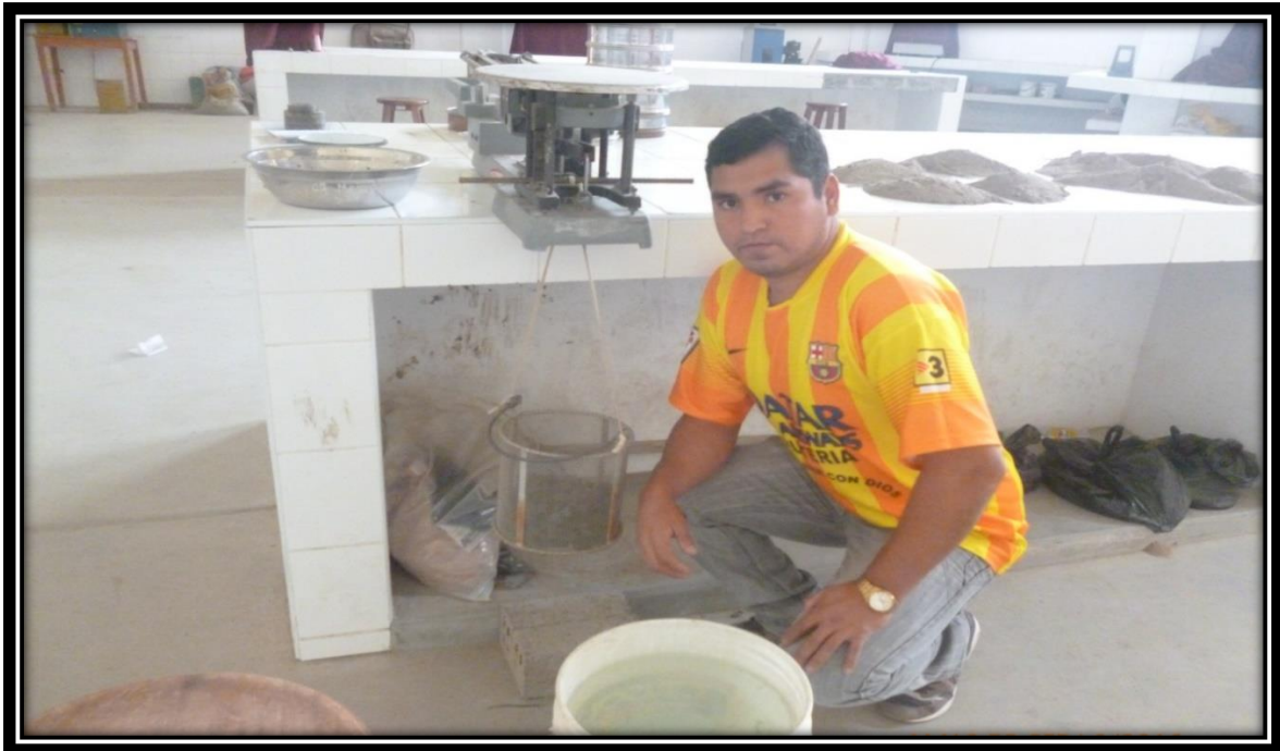
FOTO N° 15: Realizando el peso sumergido del residuo de concreto como agregado grueso.
