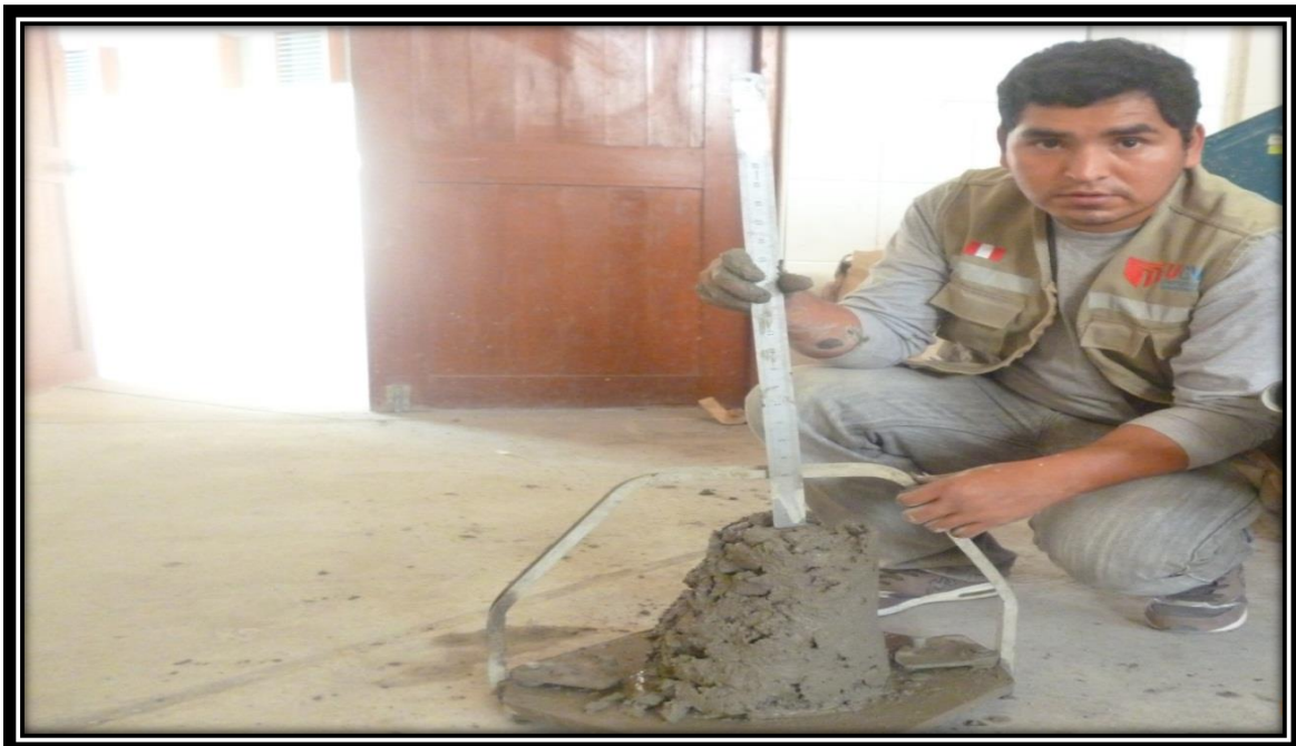
FOTO N° 20: Determinación del SLUMP del diseño de mezcla patrón.
