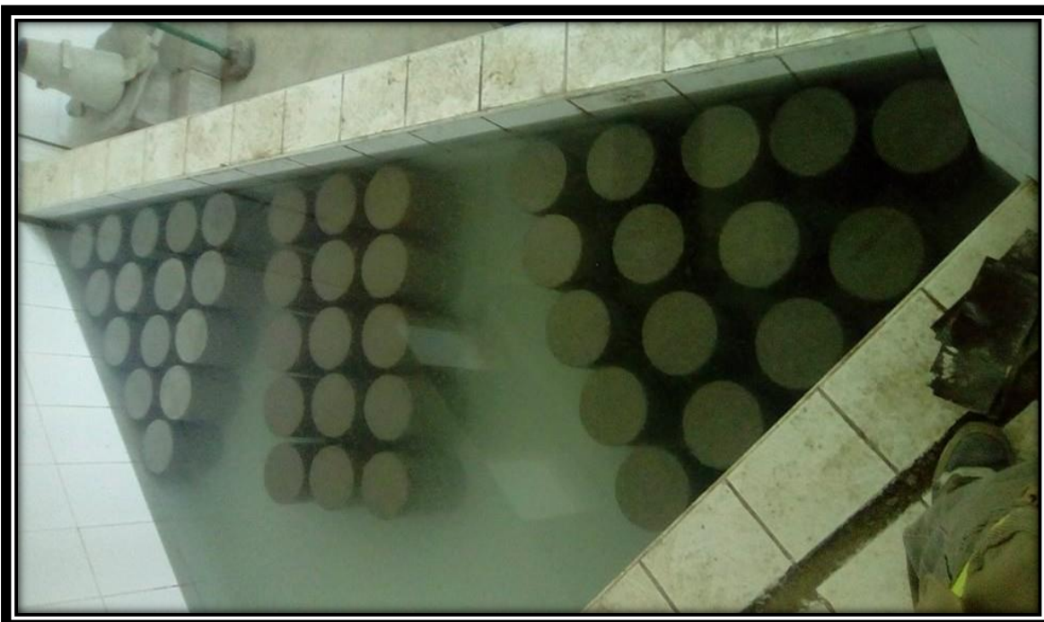
FOTO N° 28: Se observa el curado de las probetas durante 7, 14 y 28 días, para una buena resistencia.
