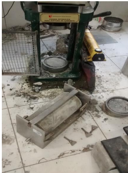
Foto : Ruptura del concreto tracción con sustitución 9 % a los 28 días
