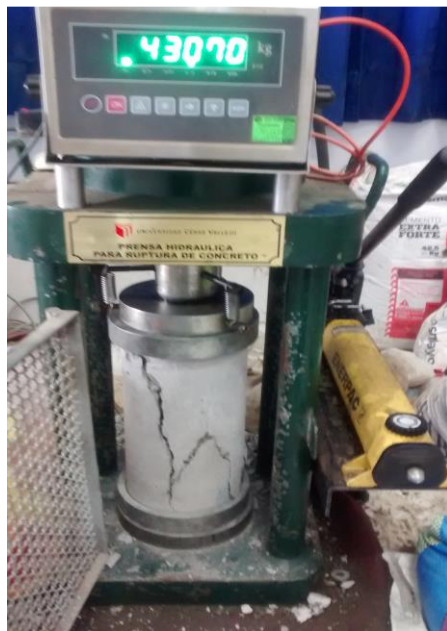
Foto N10: Resistencia a la compresión Ruptura del concreto patrón f'_c = 210 kg/cm 2 a los 28 días
