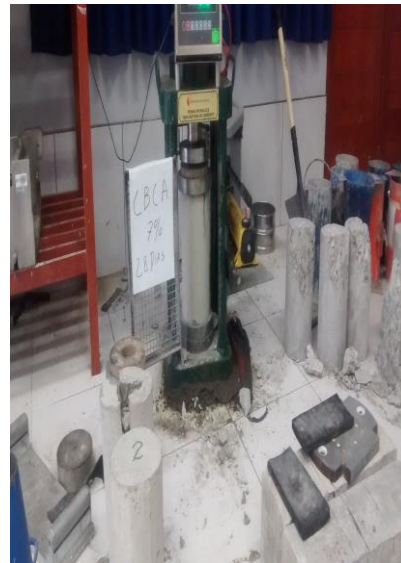
Foto : Ruptura del concreto compresión con sustitución 7 % a los 28 días
