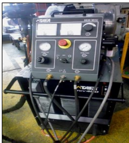
Figura 12 Máquina metalizadora – Vista frontal. Fuente: Praxair (2018)
