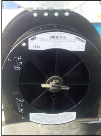
Figura 24 Alambre de metalizado \varnothing 1/16" 1.6M 75B Fuente: Instalaciones de Ipsycom Ingenieros SAC
