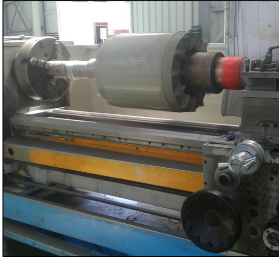
Figura 1 Ubicación del motor eléctrico para recuperar desgaste del eje. Fuente: Registro fotográfico IPSYCOM INGENEROS SAC
