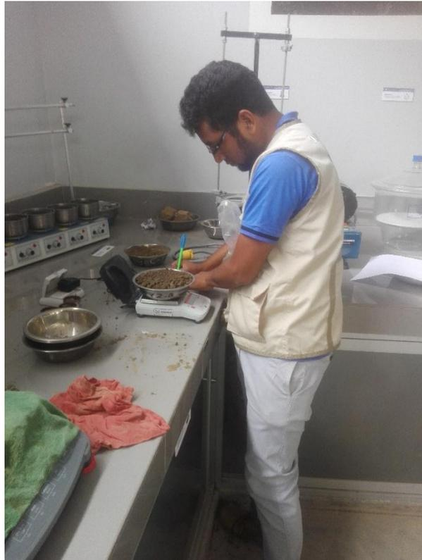
*Figura 34. Peso de la muestra para el análisis granulométrico, Universidad Cesar Vallejo Chiclayo, 2018*
