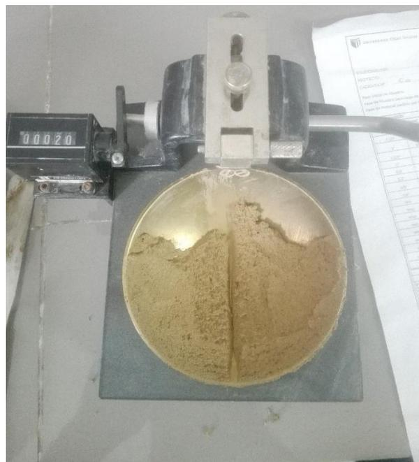
*Figura 37. Ensayo de Limite Liquido, Universidad Cesar Vallejo Chiclayo, 2018*
