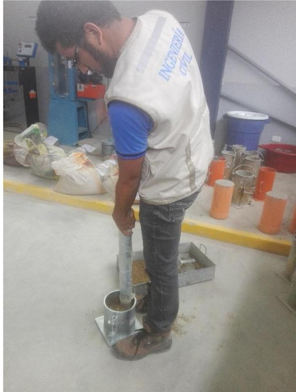
*Figura 38. Ensayo de Proctor Modificado, Universidad Cesar Vallejo Chiclayo, 2018*
