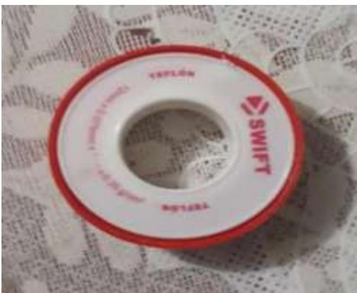
FIGURA: Cinta teflón utilizado para evitar la fuga del biodiesel el momento de decantar
