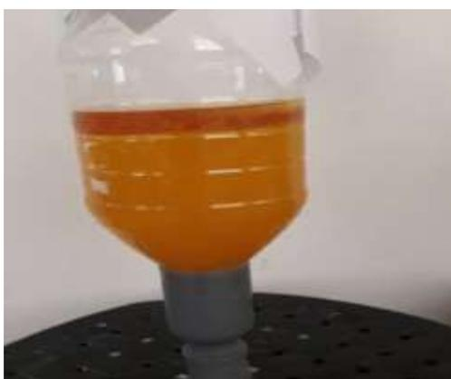
FIGURA: separación de fases del biodiesel
