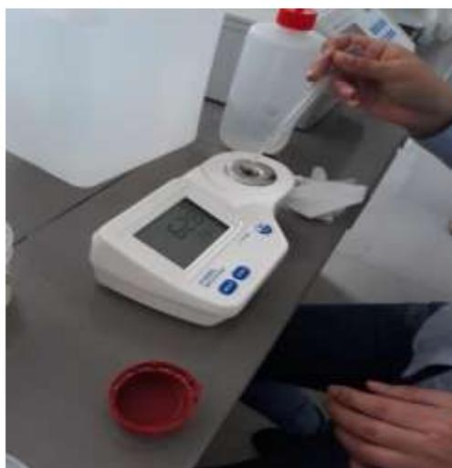
FIGURA: medida del índice de refracción
