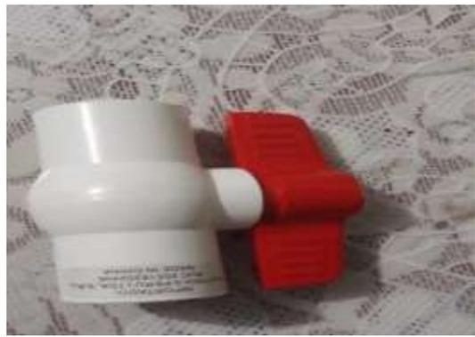
FIGURA: Llave de paso para decantar, biodiesel
