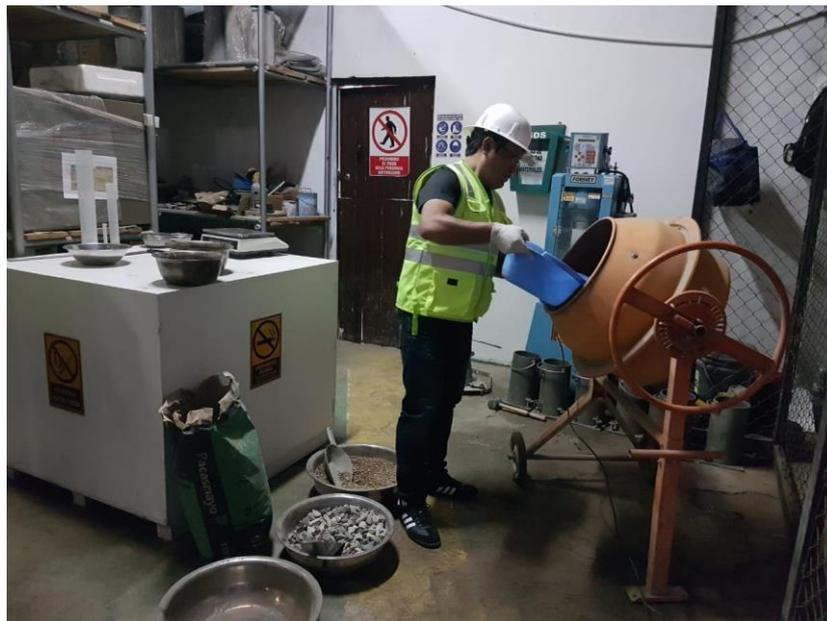
**Figura 16:** Introducción de agua en mezcladora tipo trompo.
