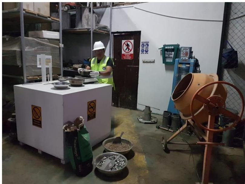
**Figura 14:** Control de peso, según dosificación, de muestra de agregado para preparación de mezcla.
