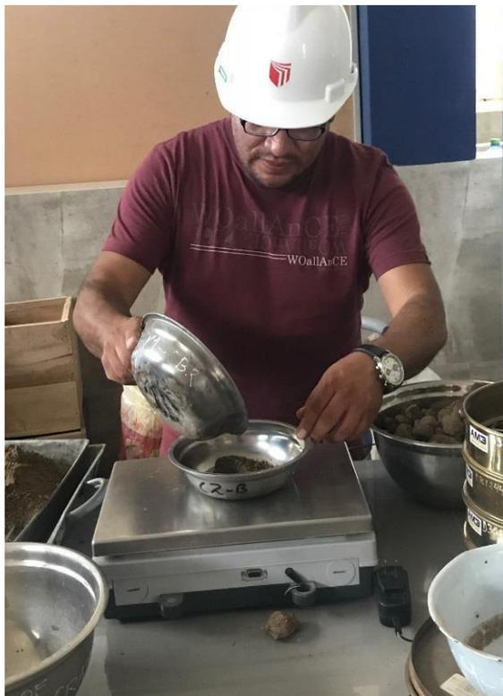
**Figura 12:** Control de peso de agregado para ensayos de densidad natural.
