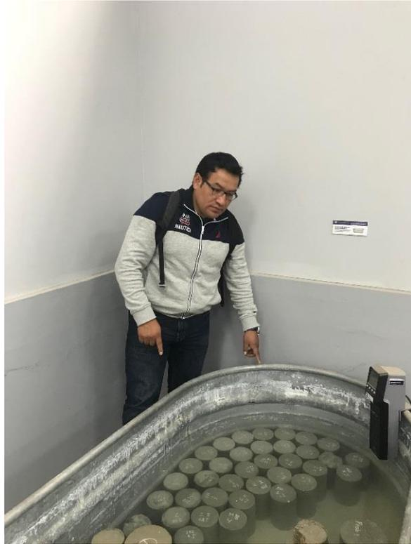
**Figura 25:** Curado de probetas.
