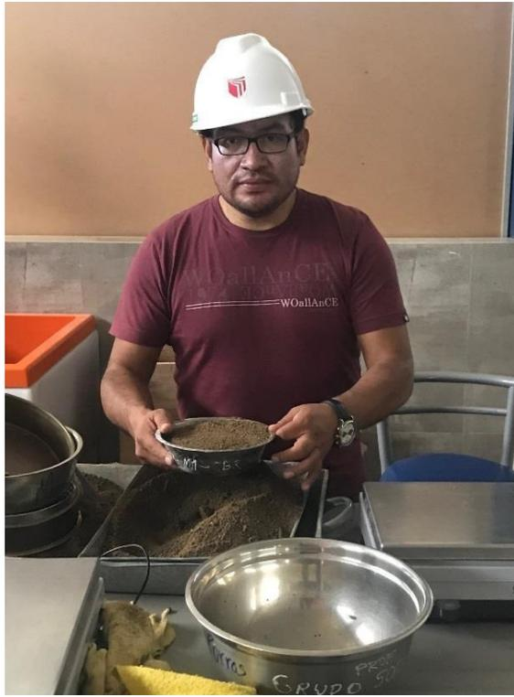
**Figura 11:** Selección de agregados fina para mezcla de concreto dosificada.
