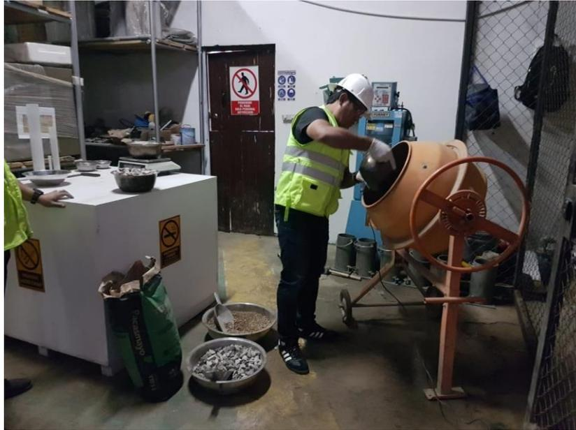
**Figura 15:** Introducción de agregado en mezcladora tipo trompo.
