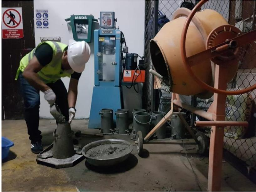
**Figura 21:** Preparación de ensayo de asentamiento.
