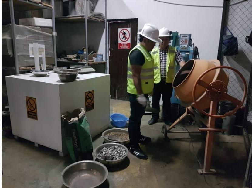
**Figura 17:** Preparación de mezcla de concreto, dosificada
