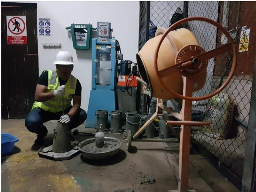
**Figura 22:** Chuseado durante el ensayo de asentamiento.
