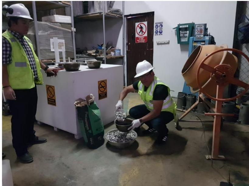
**Figura 13:** Selección de agregados para preparación de mezcla de concreto.
