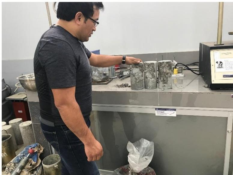
**Figura 28:** Apreciación de fisuración en las probetas sujetas a la rotura.
