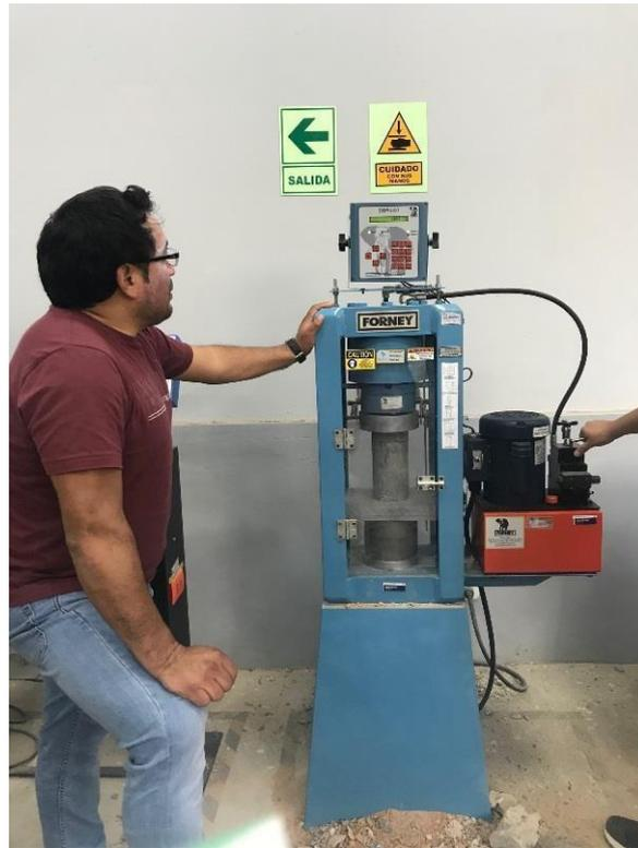
**Figura 27:** Aplicación de carga con compresora durante el ensayo de resistencia a la compresión.
