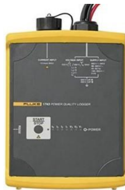
FIGURA 10 Vista del equipo analizador de potencia Fluke 1743
