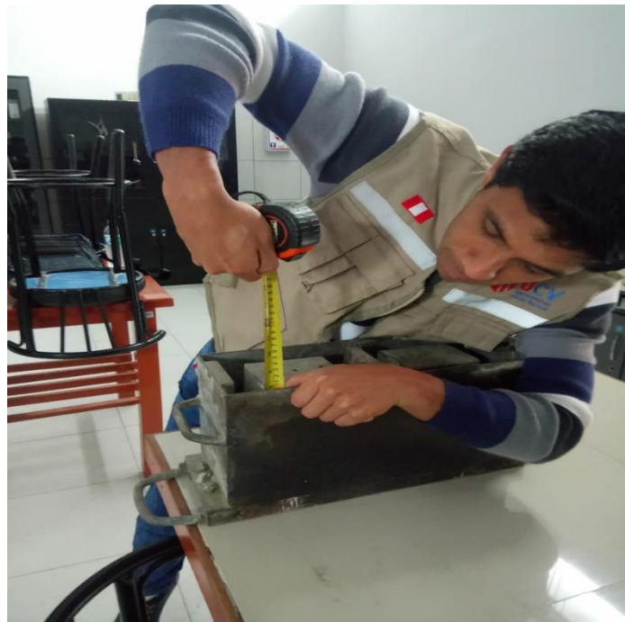
Fig.14: Medidas del Bloque de concreto
