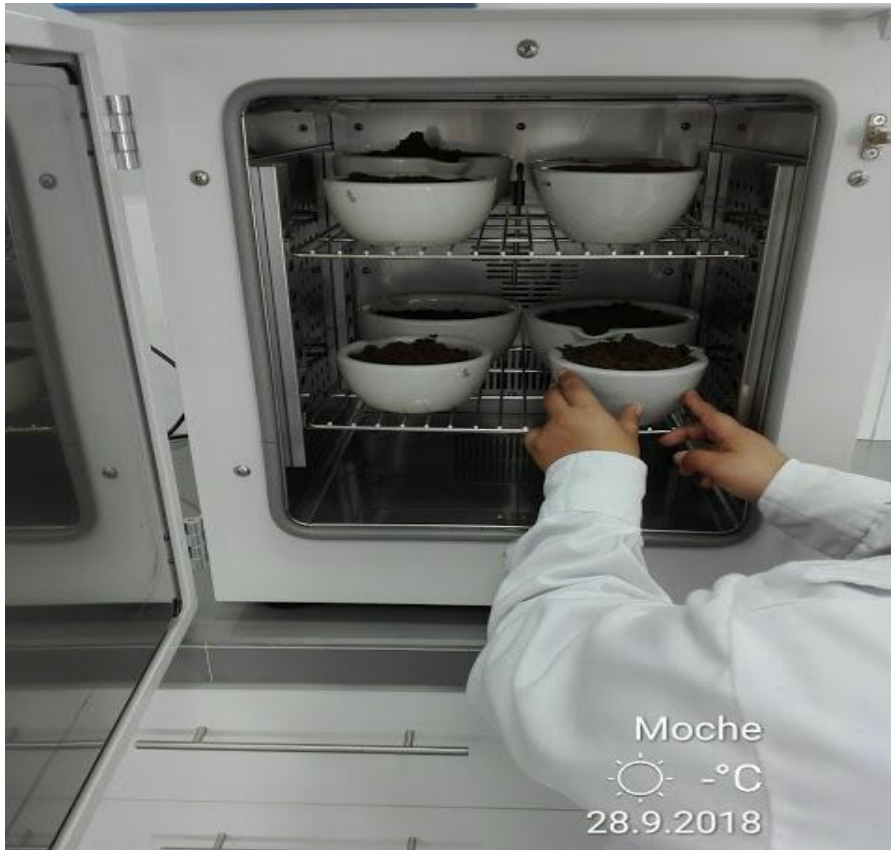
Figura 17: Esterilización del suelo homogenizado en una estufa a 150°.
