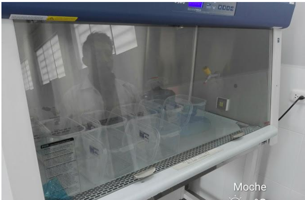
Figura 19: Esterilización de material con rayos UV para la eliminación de carga microbiana.
