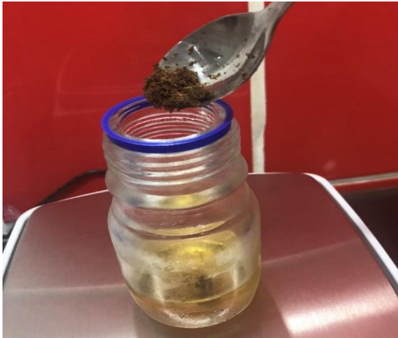
Figura 7: Pesado de muestra de suelo contaminado con petróleo en BHI.
