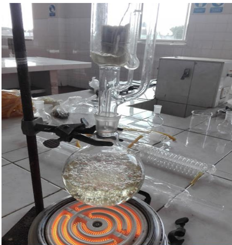
Figura 24: Aplicación del Método de Soxhlet, Extracción de grasas y aceites.
