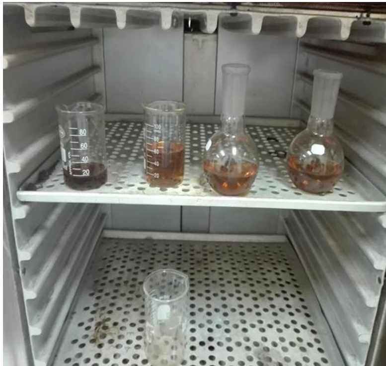
Figura 25: Las muestras en la estufa a una temperatura de 60°C para la evaporación del Ether de petróleo.
