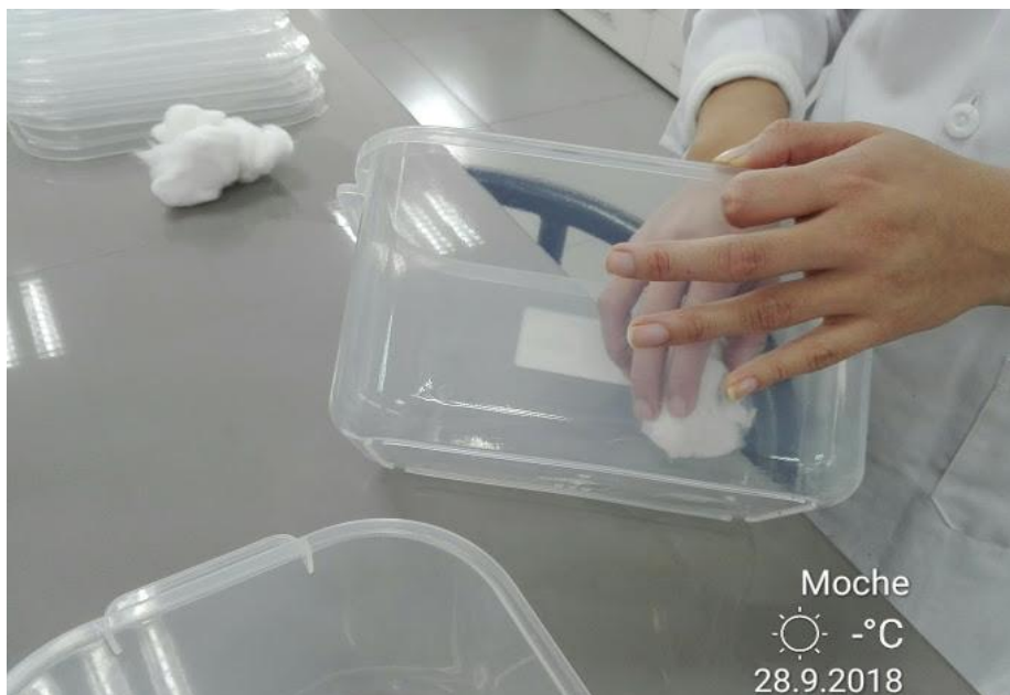
Figura 18: Esterilización con alcohol de 96° a los depósitos para eliminación de microorganismos.
