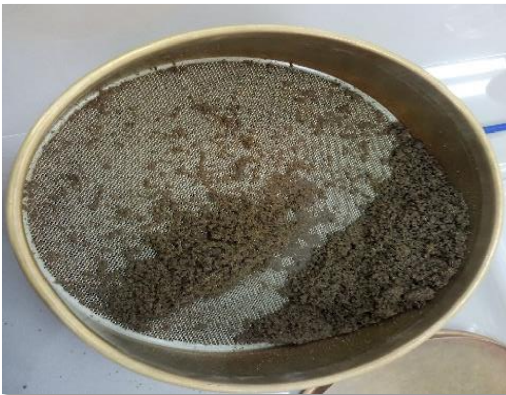
Figura 16: Tamizado de la muestra de suelo con un tamiz N° 20.
