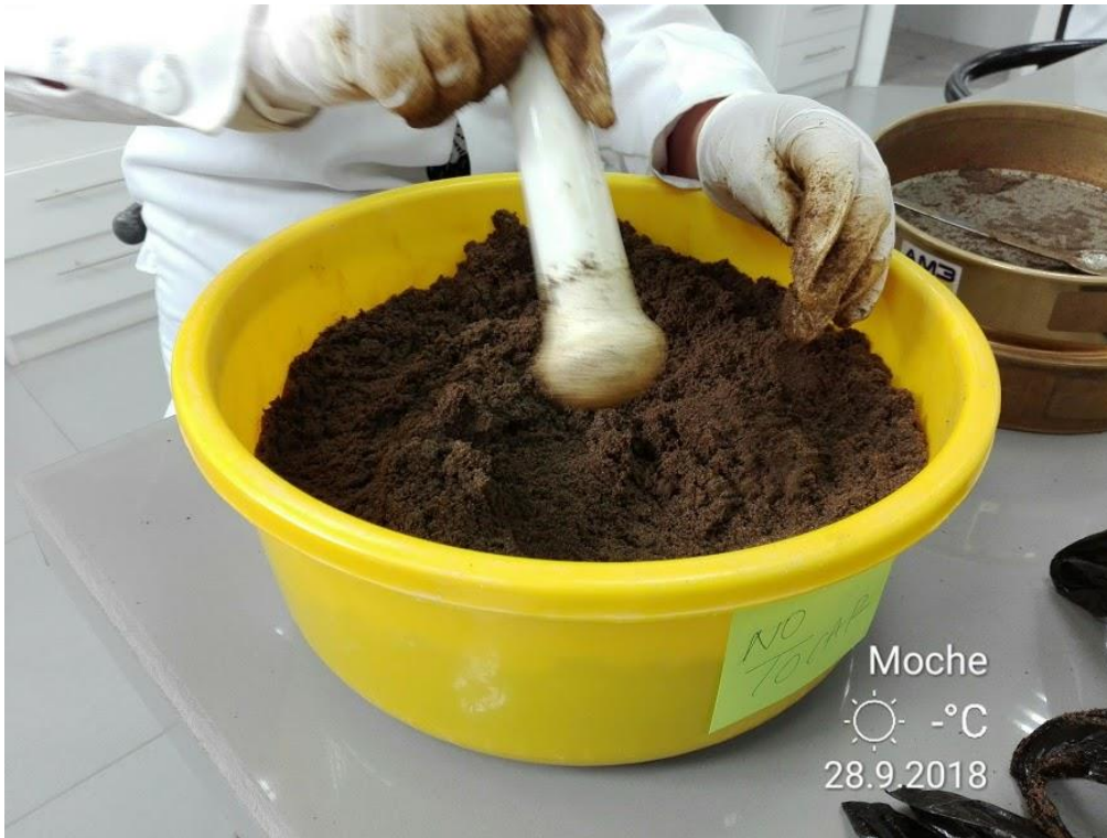
Figura 16: Tamizado de la muestra de suelo con un tamiz N° 20.
