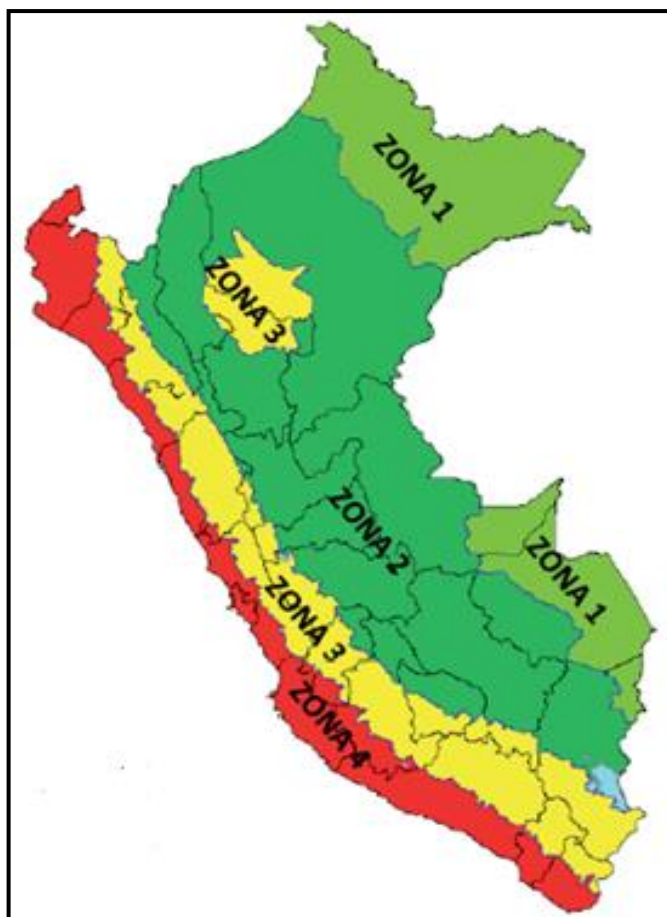
Figura 2. Zonas Sísmicas de Perú según la norma e.030 del 2016. Fuente: norma e.030 del 2016
