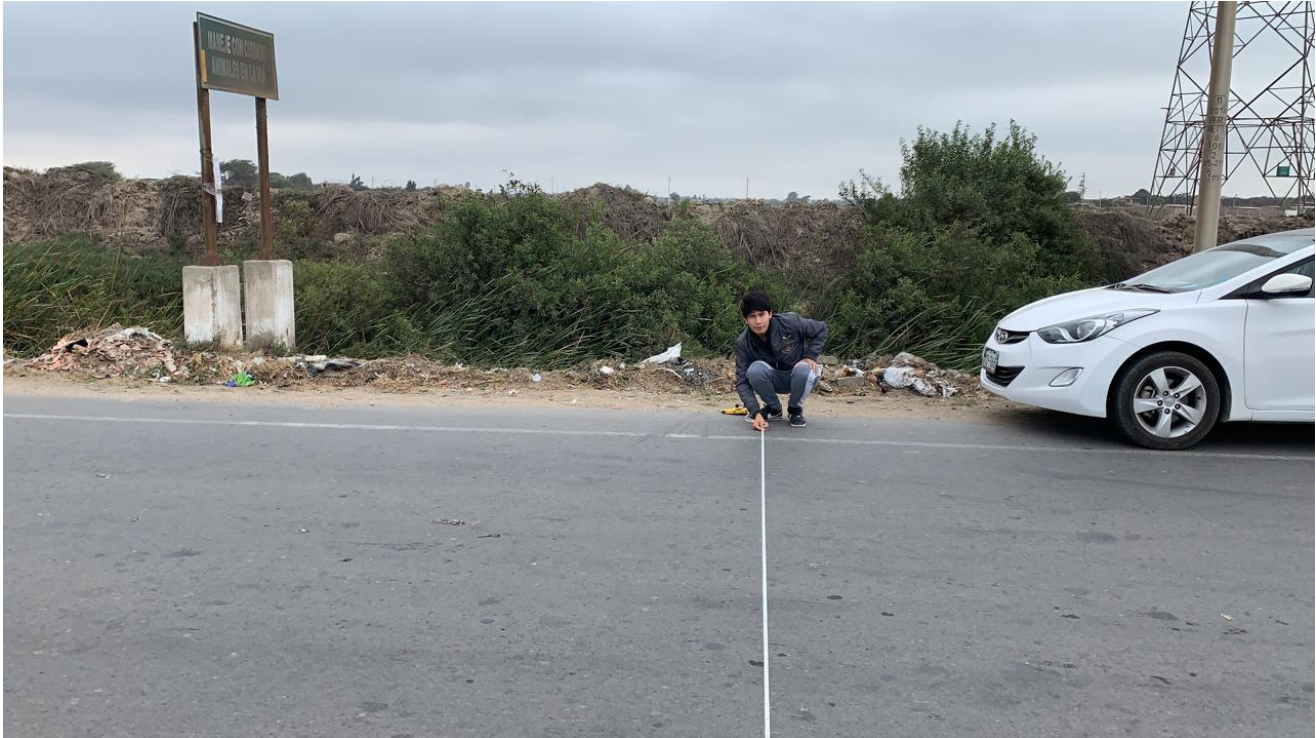
Figura 5. Medición del ancho de la carretera
