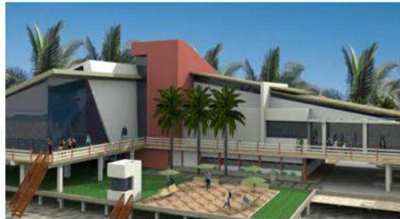
**Áreas Exteriores:** En áreas al descubierto de recorridos se usarán cubiertas con sombras proporcionadas por vegetación (palmeras), cubre suelos para que el calor no refleje y pérgolas.
