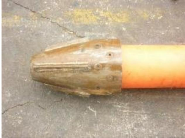
*Figura 20.* Cabezal empernado a la tubería HDPE.
