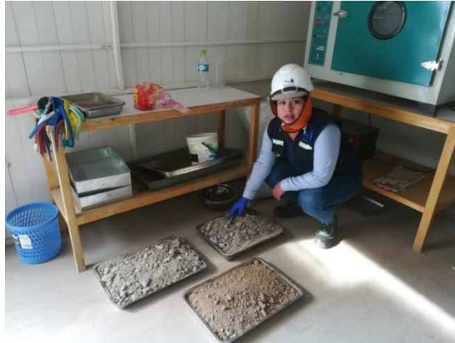
Peso de la muestra para el ensayo granulométrico y tamizado
