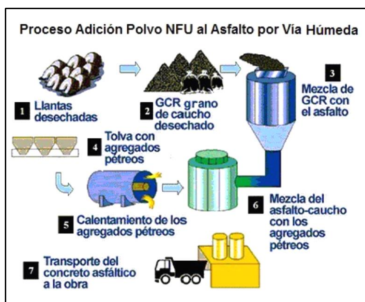
Ilustración 17. Fases del procedimiento de mezcla asfáltica con polvo del caucho de Neumático reciclado
