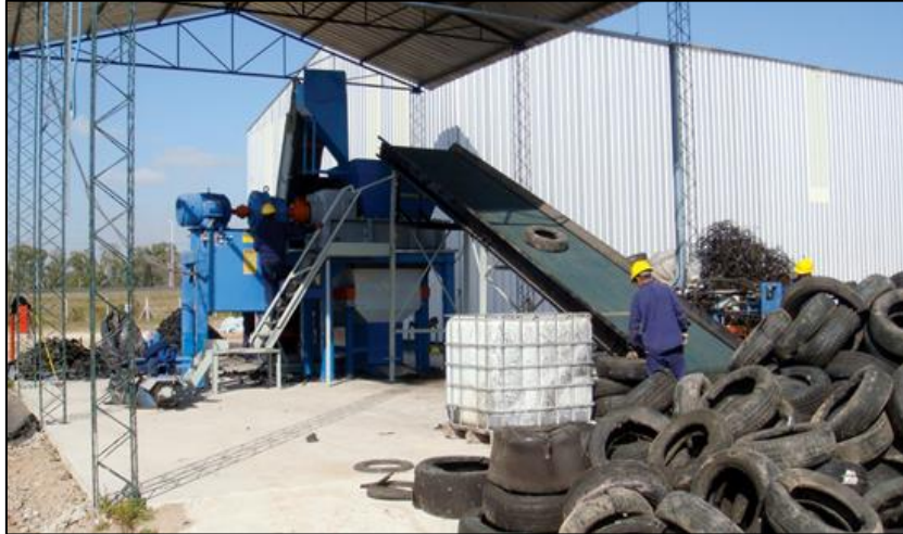
Ilustración 15. Faja transporta neumáticos al triturador primario
