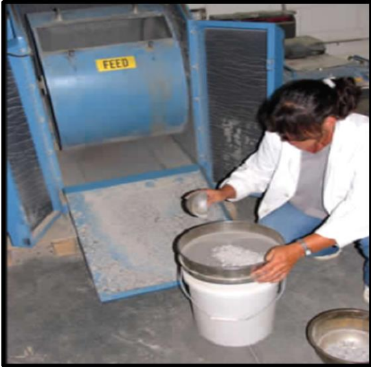
Cilíndrico metálico, para realizar la prueba de desgaste de los Ángeles
