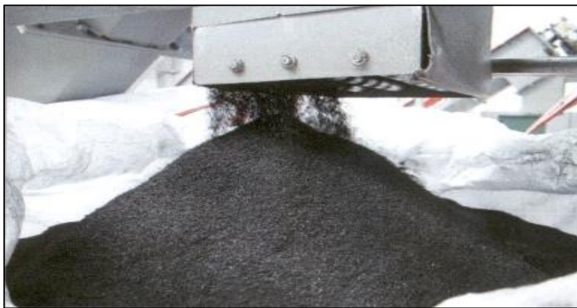
Ilustración 16. Producto final de molienda de desechos de neumáticos
