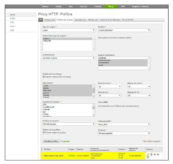
Figura 37. Configuración libre navegación
