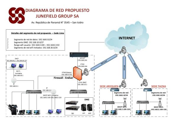
Figura 18. Diseño lógico de la red
