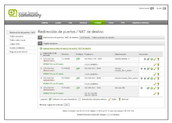
Figura 20. Redirección de puertos / tráfico de entrada
