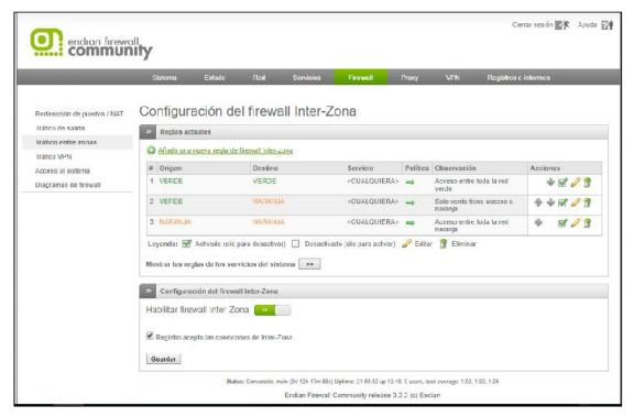
Figura 22. Configuración firewall entre zonas
