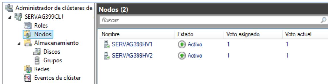
Figura 87: Nodos (servidores físicos) enlazados al clúster.
