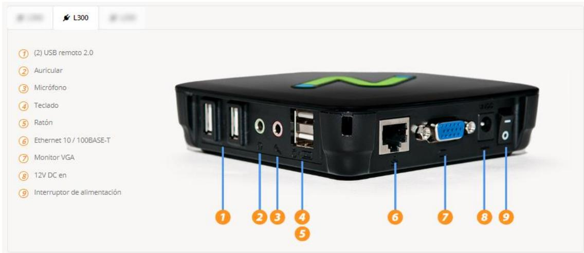
Figura 22: Conexiones Modelo NComputing L300
