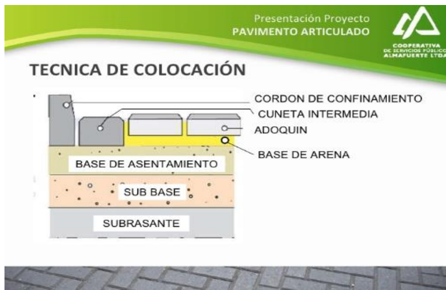
Figura 1: Estructura de pavimento con adoquines de concreto
