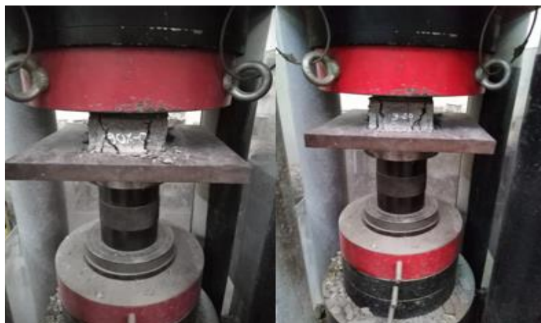
Figura 17: Ensayo de resistencia a la compresión en adoquines
