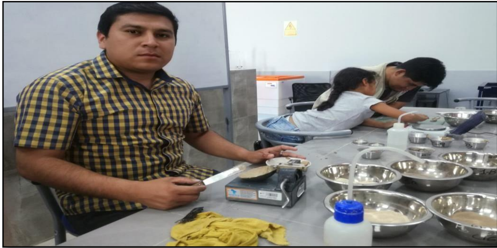
Figura 4. Laboratorio de Ingeniería Civil de la Universidad Cesar Vallejo, Proceso de límite líquido de las muestras, 2018
