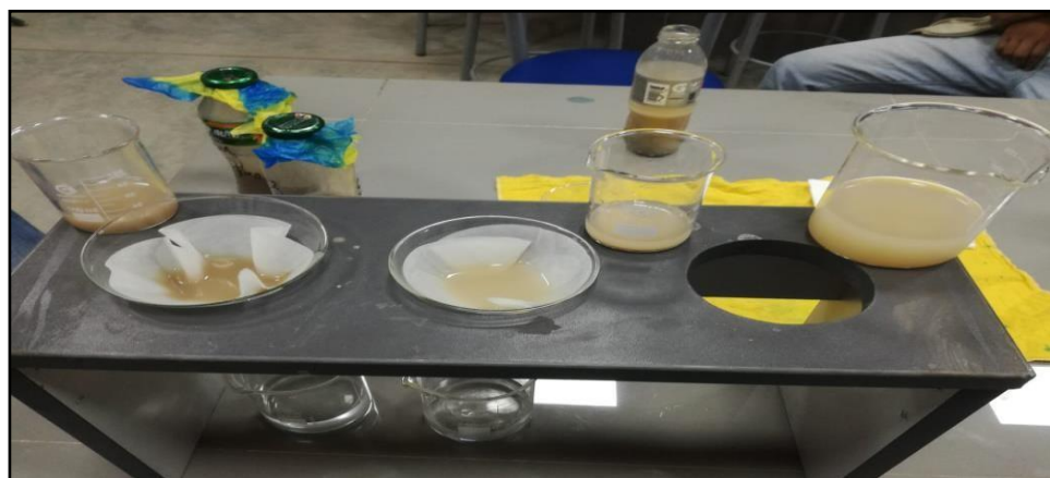
Figura 5. Laboratorio de Ingeniería Civil de la Universidad Cesar Vallejo, Proceso de destilación de sales de las muestras, 2018
