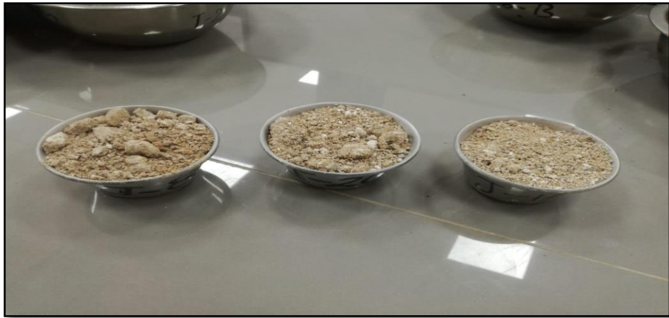
Figura 2 . Laboratorio de Ingeniería Civil de la Universidad Cesar Vallejo, Proceso de secado en horno de la muestra, 2018
