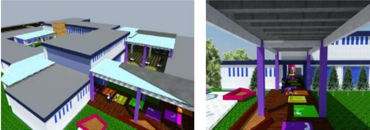
La edificación usa ventanas pequeñas para evitar el ingreso excesivo del sol, usa dobles pieles que ayudan a que se integre con el diseño y estructuras metálicas en ambientes donde se quiere cubrir luces muy grandes, sean espacios abiertos sin cerramientos verticales, con el uso de estructuras metálicas genera importancia al ambiente.
