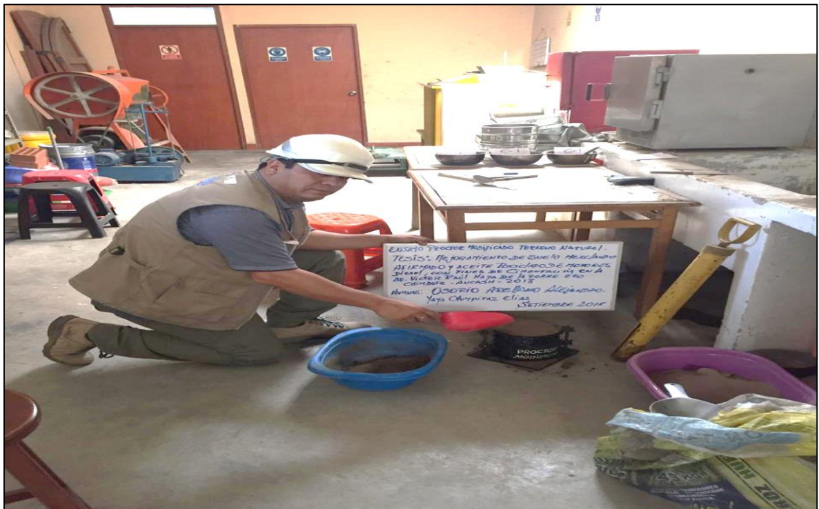
ENSAYO DE PROCTOR MODIFICADO TERRENO NATURAL
