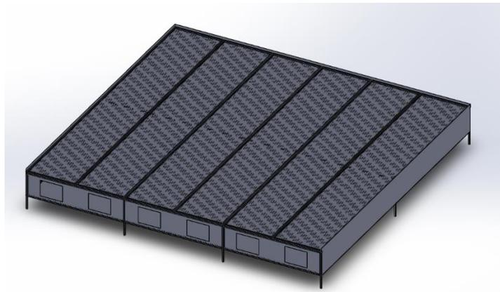
La mesa será estática la suma de los agujeros de todos los bastidores que será removibles no está soldado a la estructura será la calculada en el ítem de tiempo de secado 89556 con un radio de 3 mm. La mesa está diseñada para que al llenarse tenga una capa de 8 cm de espesor obedeciendo a lo calculado anteriormente.
