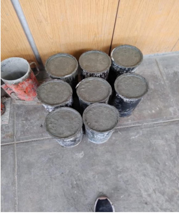
8 Probetas realizadas con agregados reciclados al 25% agregado reciclado
