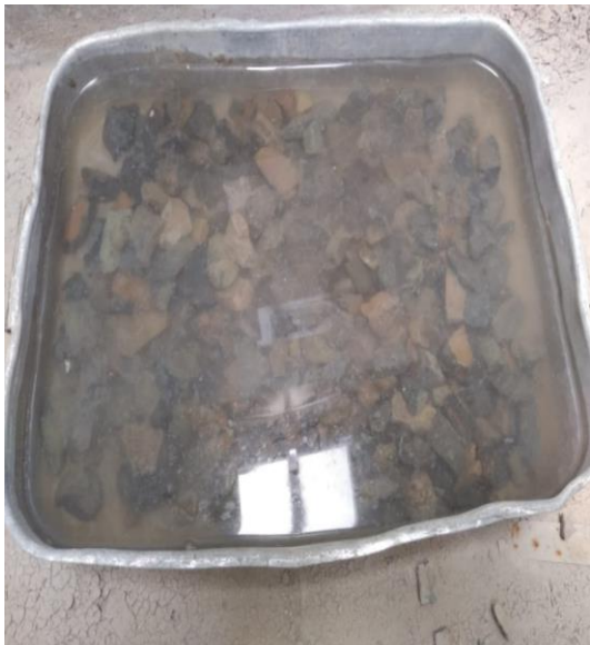
Separación de una muestra de agregado grueso y dejarla sumergida por 24 horas
