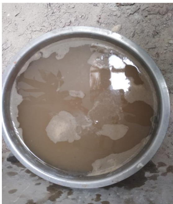
Separación de una muestra de agregado fino y dejarla sumergida por 24 horas
