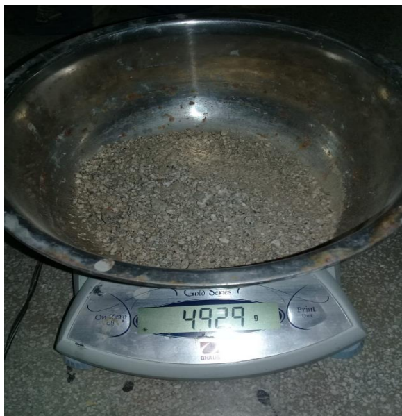
Determinación de contenido de humedad peso seco
