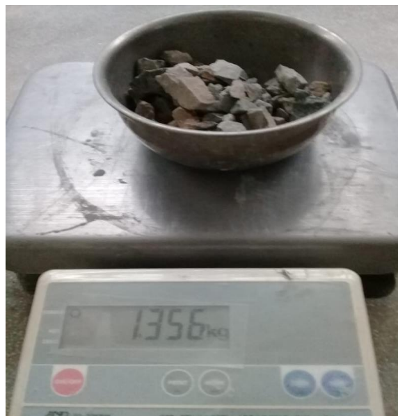
Determinación de contenido de humedad peso seco
