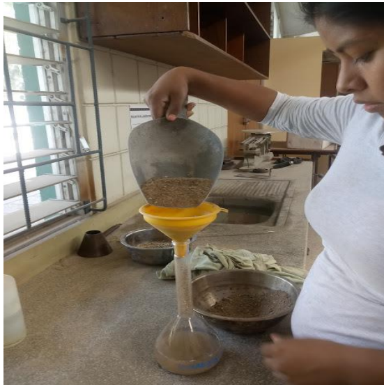
Picnómetro + agua + muestra
