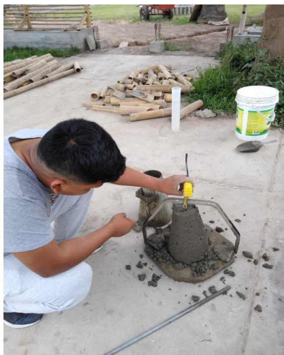
Prueba de revenimiento
