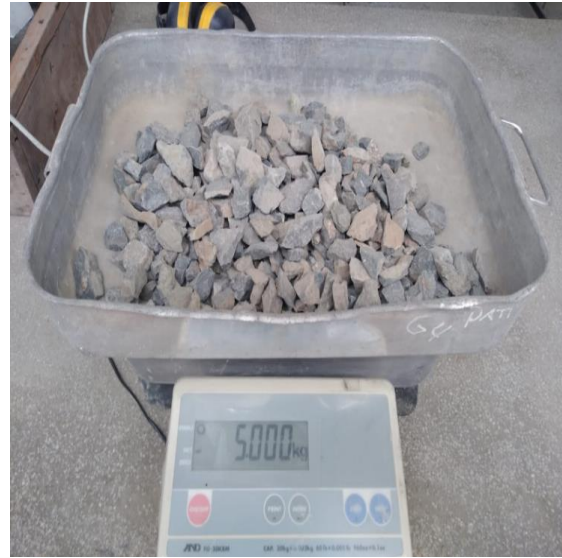
Aparte se seleccionó material para ser secado y hallar el contenido de humedad
