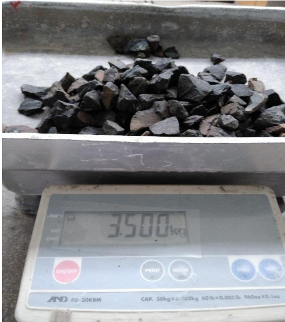
Selección de 3500 kg. De muestra saturada con superficie seca
