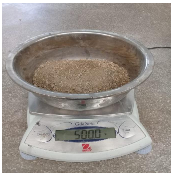
Muestra saturada con superficie seca del agregado fino selección de 5000 g.
