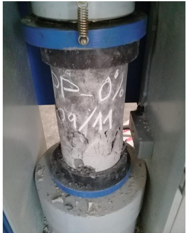
Rotura de probeta Patrón con 0% de agregado reciclado
