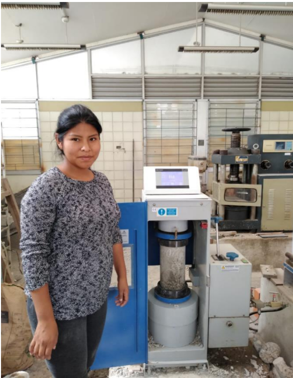
Rotura de probeta
