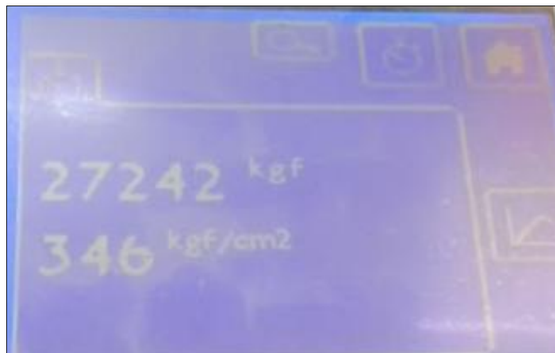
Figura 44. Probeta 1 del F'c en 7 días para el Diseño 2
