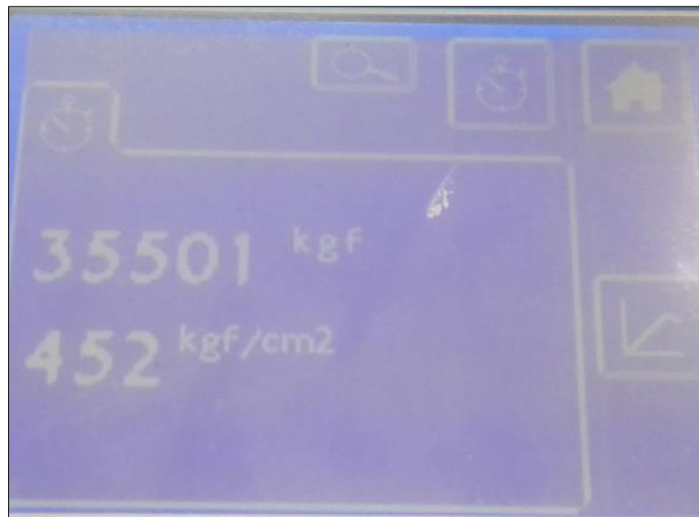
Figura 42. Probeta 1 del F'c en 28 días para el Diseño 1
