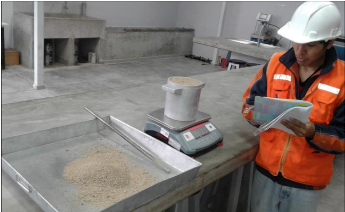
Figura 20. Peso Unitario Suelto y Compactado de la Arena Gruesa
