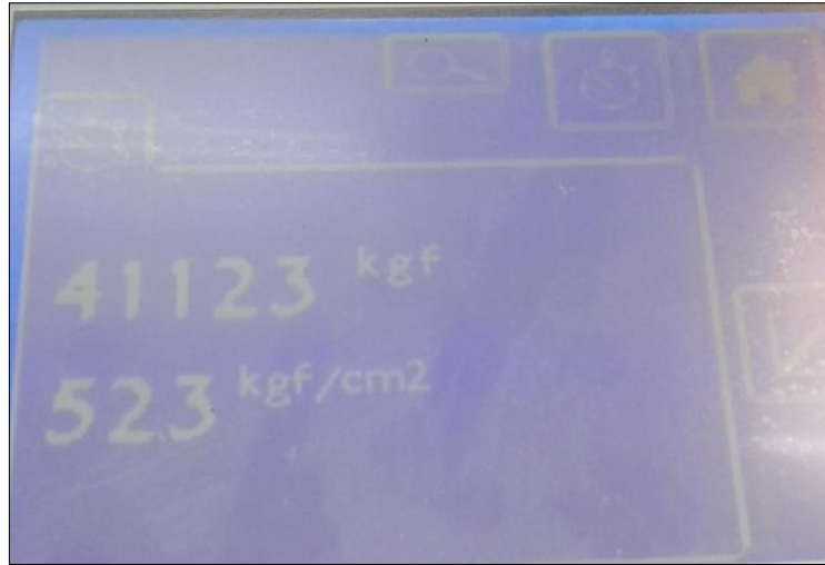
Figura 49. Probeta 2 del F'c en 28 días para el Diseño 2
