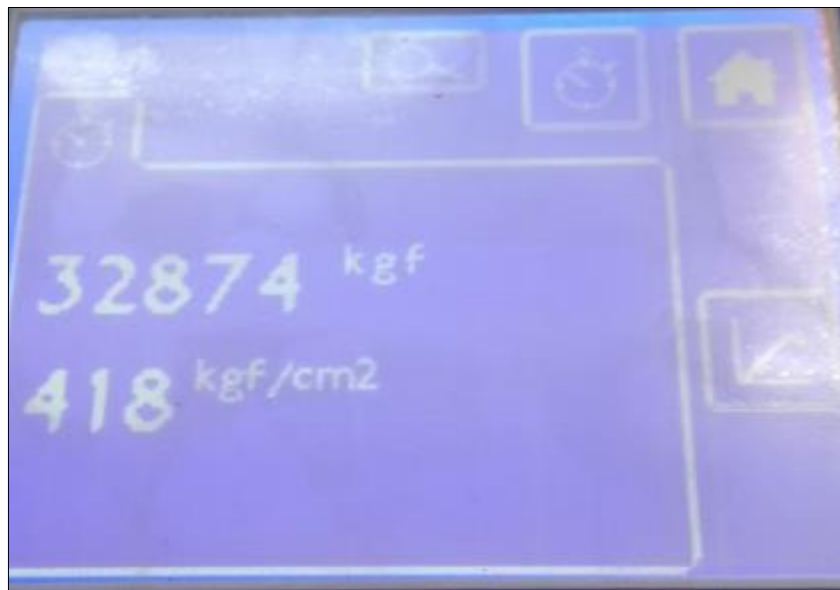
Figura 46. Probeta 1 del F'c en 14 días para el Diseño 2
