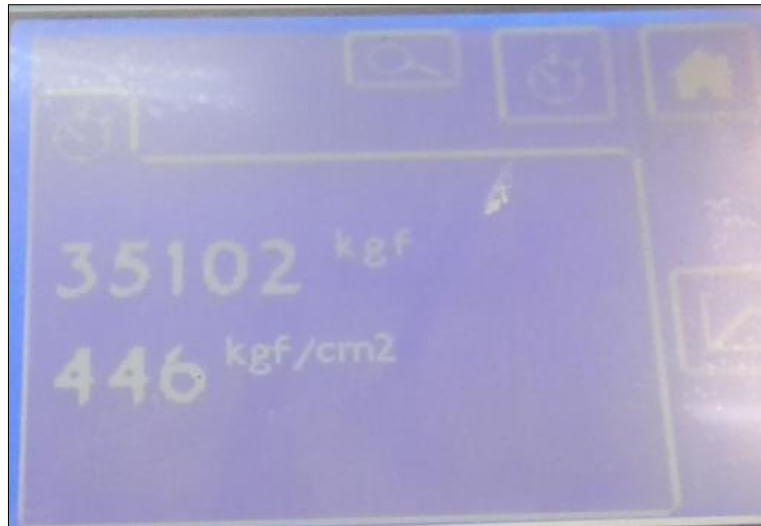
Figura 43. Probeta 2 del F'c en 28 días para el Diseño 1
