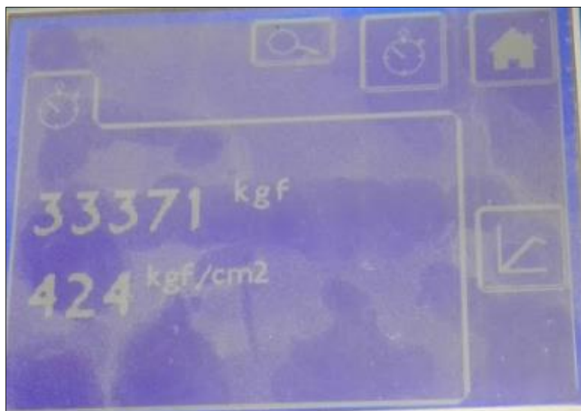
Figura 40. Probeta 1 del F'c en 14 días para el Diseño 1
