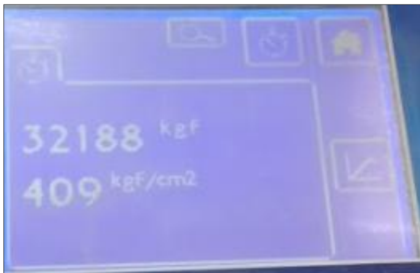
Figura 38. Probeta 1 del F'c en 7 días para el Diseño 1
