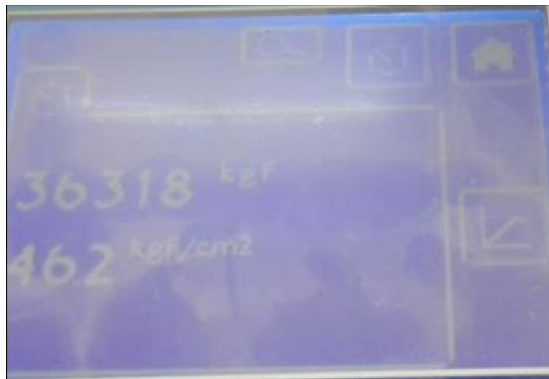
Figura 52. Probeta 1 del F'c en 14 días para el Diseño 3
