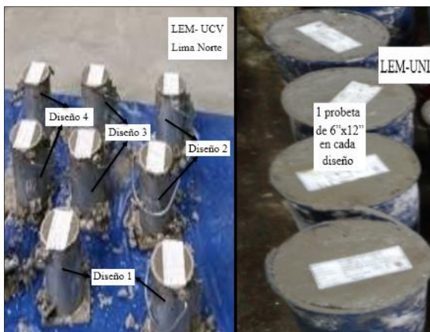
Figura 15. Testigos de los diseños del concreto
