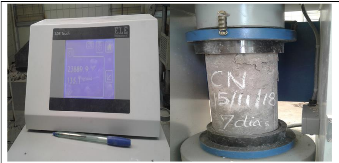
Figura 141. Resistencia de 135 kg/cm 2 y las fallas mostradas en los testigos. Fuente: Elaboración propia.
