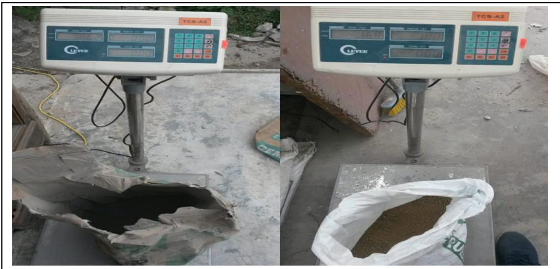
Figura 111. Peso del cemento y agregado fino para la mezcla. Fuente: Elaboración propia.
