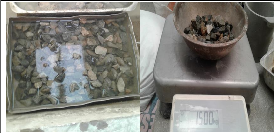
Figura 47. Muestra sumergida durante 24 h y tomando 1500 g de agregado grueso. Fuente: Elaboración propia.
