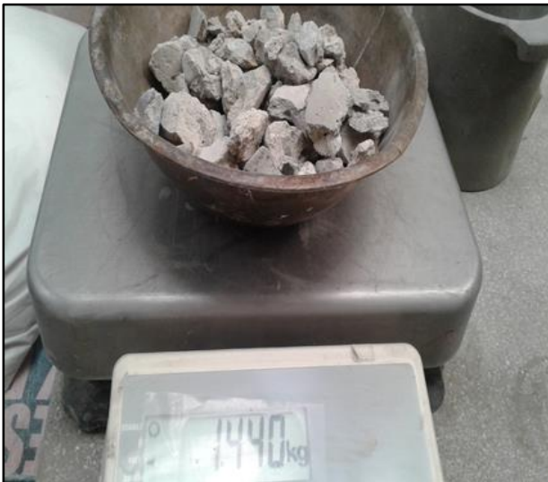
Figura 78. Enrasado de la muestra, obteniendo el peso de la muestra suelta. Fuente: Elaboración propia.
