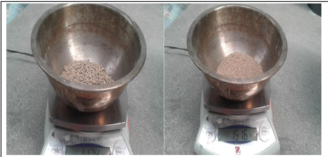
Figura 18. 119.5 y 151.6 g de muestras retenidas en las mallas N° 8 y N° 16. Fuente: Elaboración propia.
