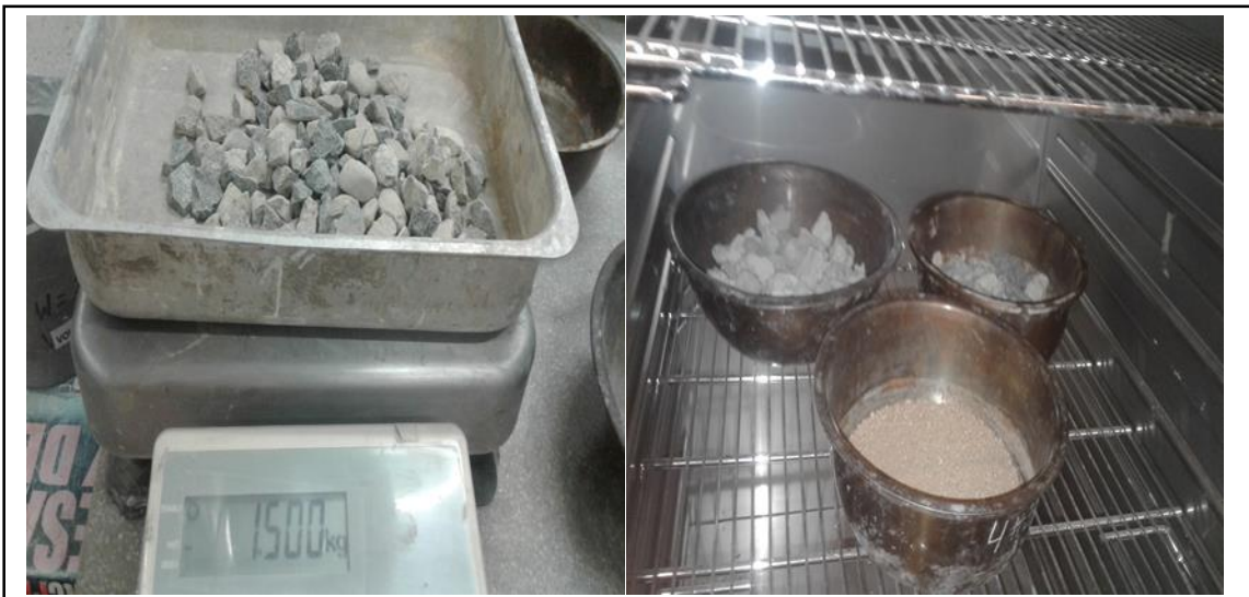
Figura 56. Peso de la muestra húmeda y secado en el horno a una temperatura de 110 \pm 5^\circ\text{C} . Fuente: Elaboración propia.
