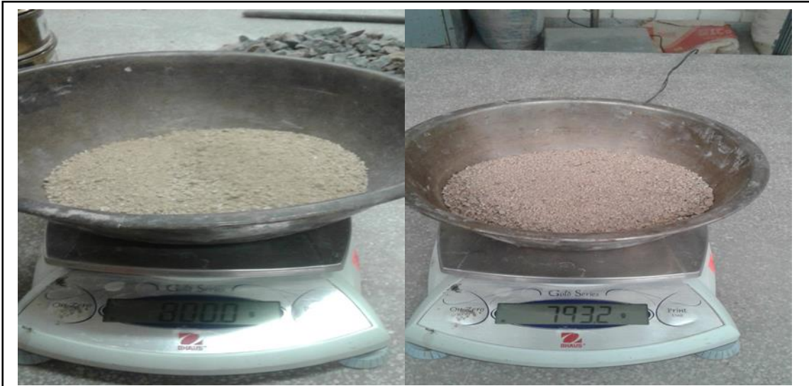
Figura 38. Peso de la muestra húmeda y peso de la muestra seca luego de retirar del horno. Fuente: Elaboración propia.
