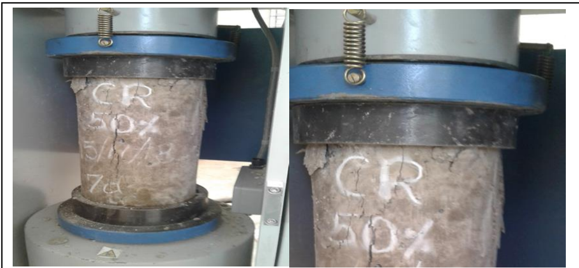
Figura 145. Fallas de los testigos. Fuente: Elaboración propia.
