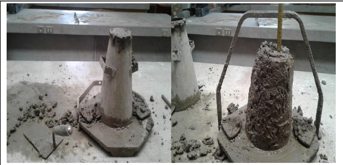
Figura 105. Mezcla vertida en el cono de abrams y obtención del slump de 3". Fuente: Elaboración propia.
