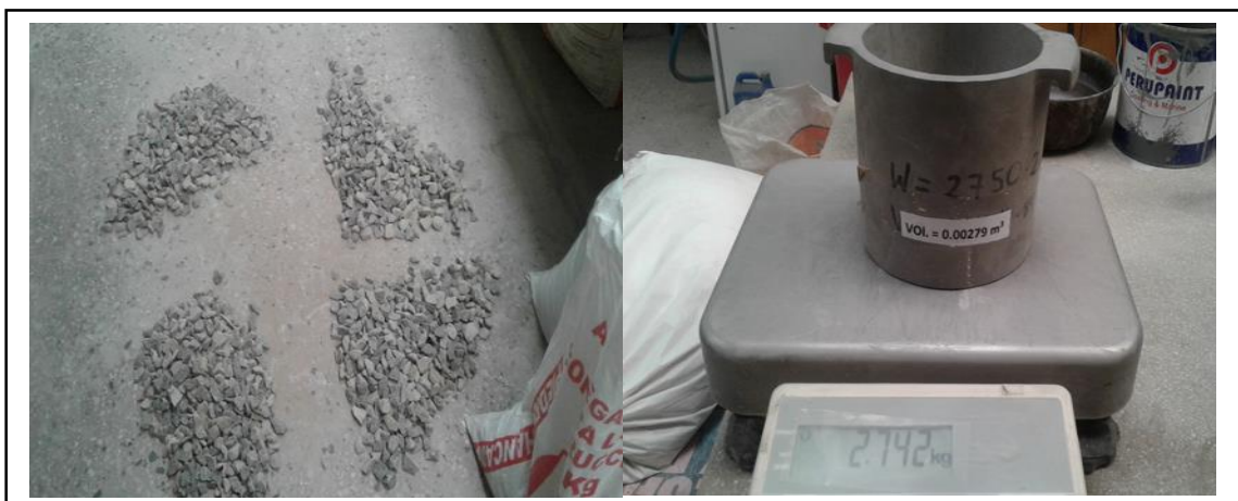
Figura 51. Cuarteo del material y peso del cilindro. Fuente: Elaboración propia.
