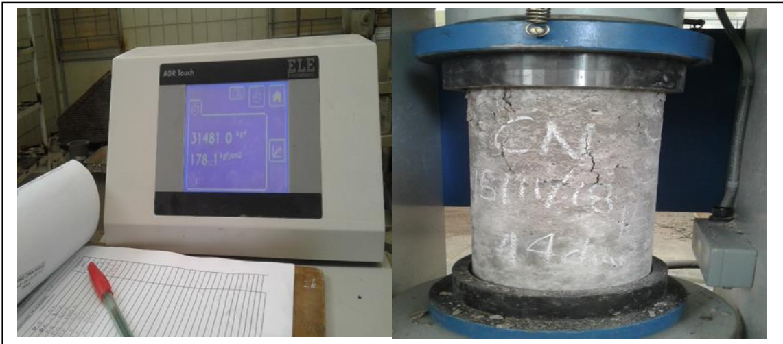
Figura 151. Resistencia de 178.1 kg/cm 2 y las fallas mostradas en el testigo. Fuente: Elaboración propia.
