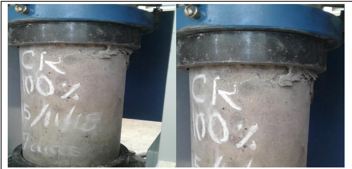
Figura 147. Fallas encontradas en los testigos. Fuente: Elaboración propia.
