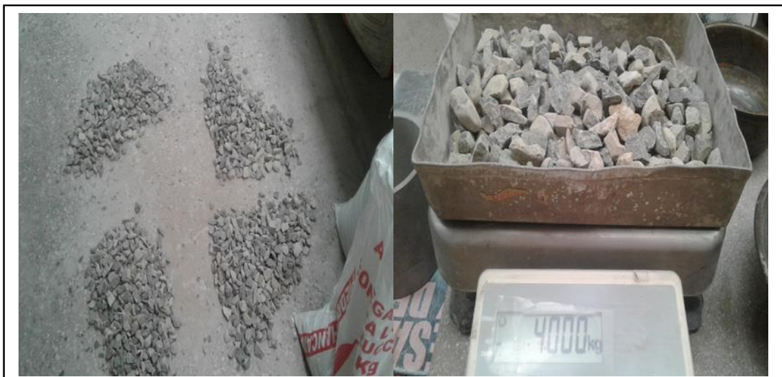
Figura 46. Cuarteo del material y tomando muestra de 4000 g de agregado grueso. Fuente: Elaboración propia.
