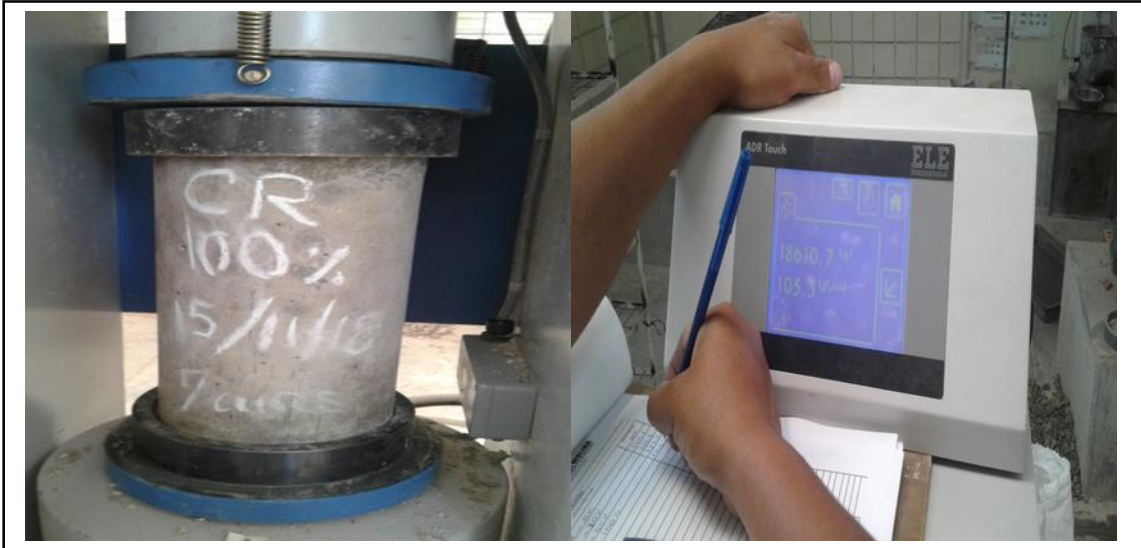
Figura 146. Testigos de resistencia a compresión con 100% de a.g. reciclado con una resistencia registrada de 105.3 kg/cm 2 . Fuente: Elaboración propia.
