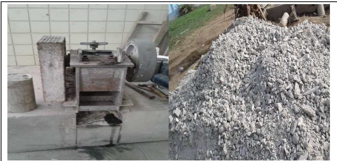
Figura 60. Trituración secundaria a través de la trituradora y obtención del agregado reciclado. Fuente: Elaboración propia.
