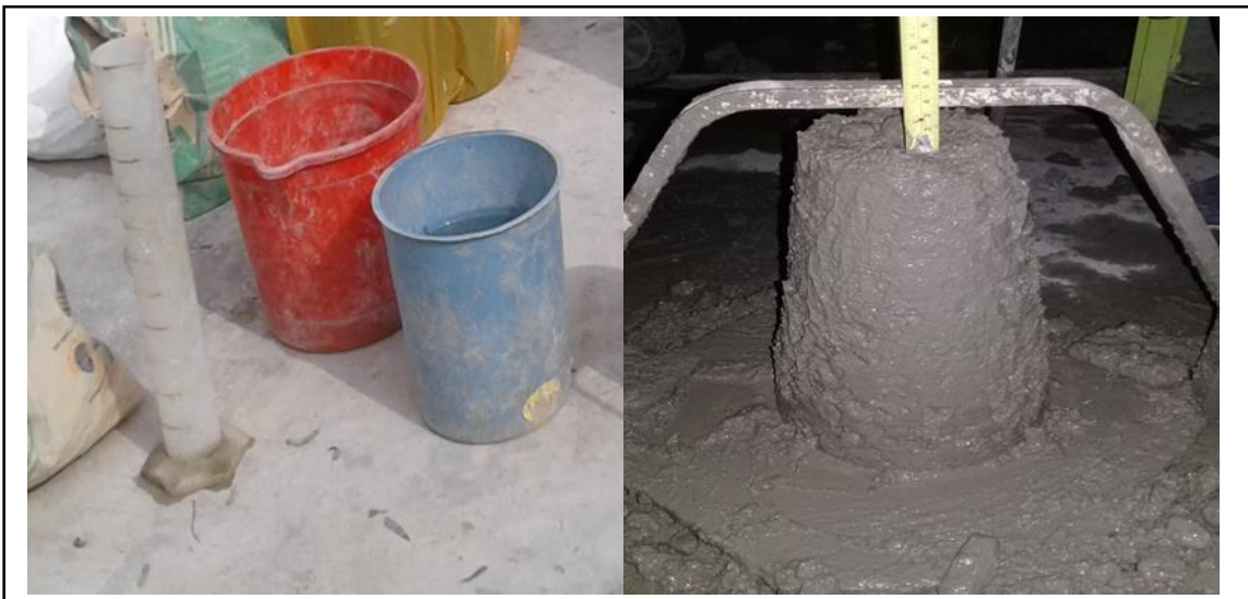
Figura 129. Agua requerida y la verificación del slump deseada. Fuente: Elaboración propia.
