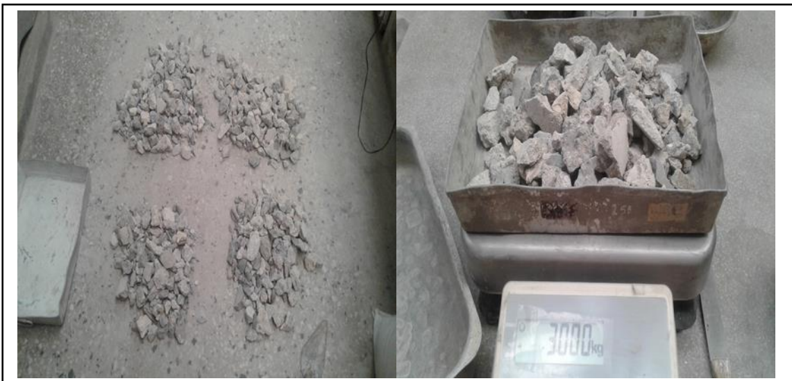
Figura 61. Cuarteo del material reciclado y 3000 g de agregado reciclado. Fuente: Elaboración propia.
