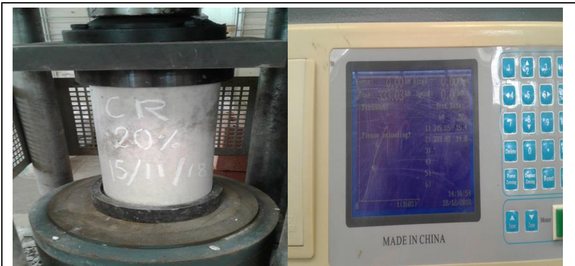
Figura 162. Testigos de resistencia a compresión de 28 días con un 20% de a.g. reciclado y una resistencia de 186 kg/cm 2 . Fuente: Elaboración propia.
