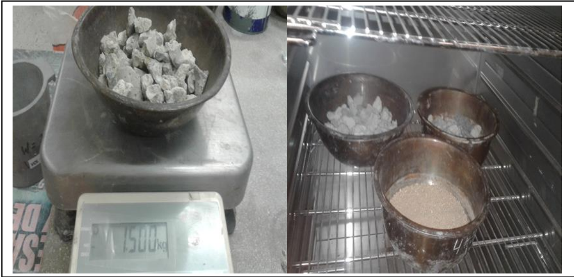
Figura 77. Peso de la muestra húmeda y secado en el horno a una temperatura de 110 \pm 5^\circ\text{C} . Fuente: Elaboración propia.
