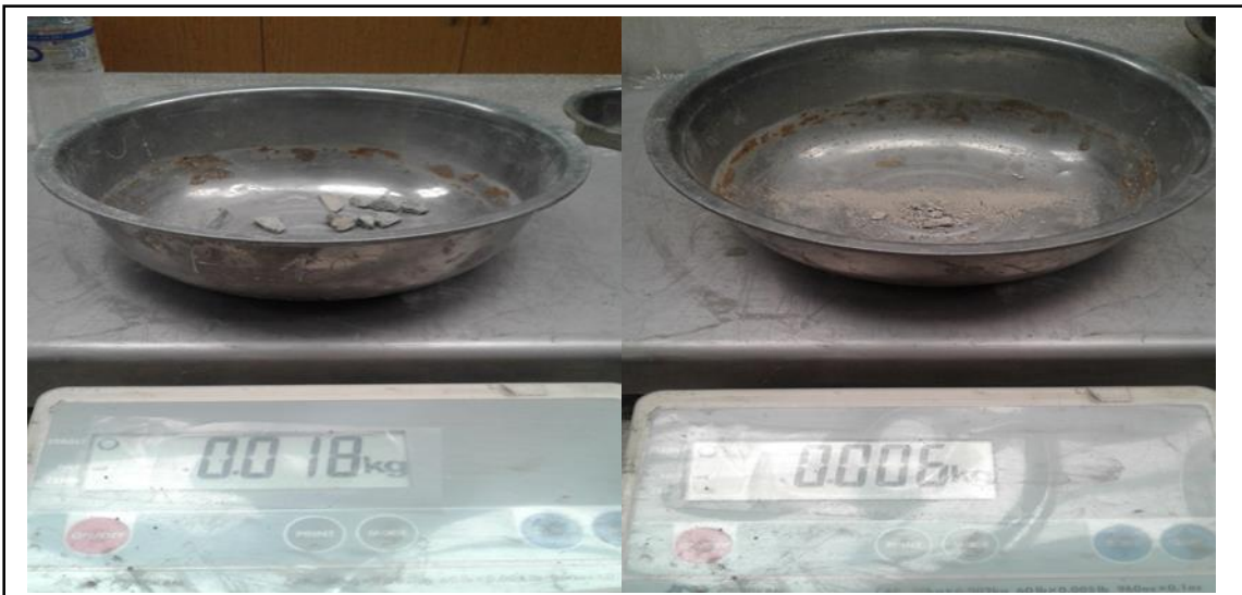
Figura 43. 18 y 6 g de muestra retenida en cada malla de 3/8" y fondo. Fuente: Elaboración propia.
