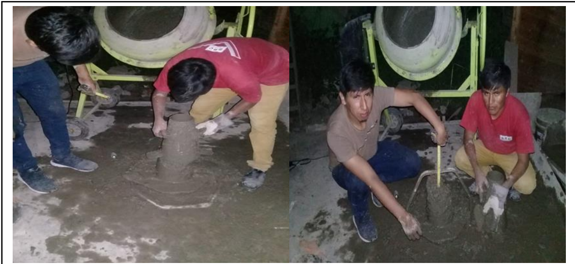
Figura 124. Retiro del cono de abrams para verificar el slump. Fuente: Elaboración propia.
