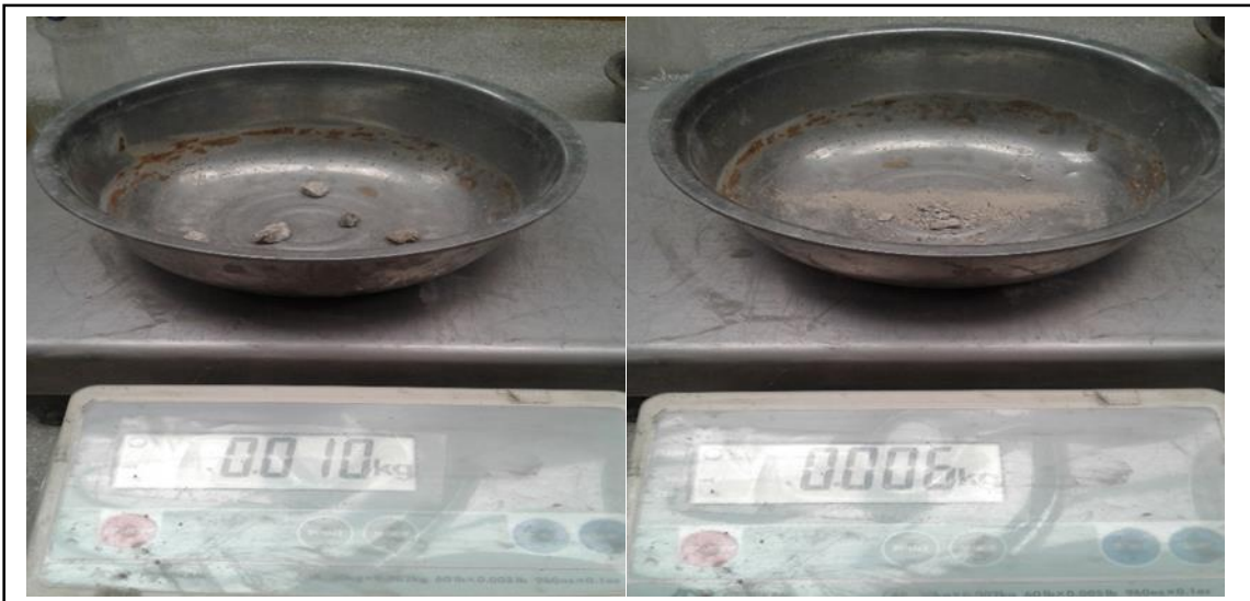
Figura 64. 10 y 6 g de muestras retenidas en la malla 3/8" y en fondo. Fuente: Elaboración propia.
