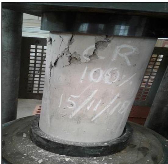
Figura 167. Pequeñas fallas mostradas. Fuente: Elaboración propia.
