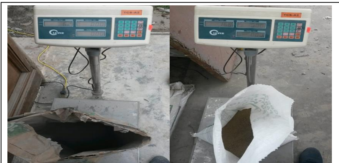
Figura 119. Pesado del cemento y agregado fino requerida para la mezcla. Fuente: Elaboración propia.
