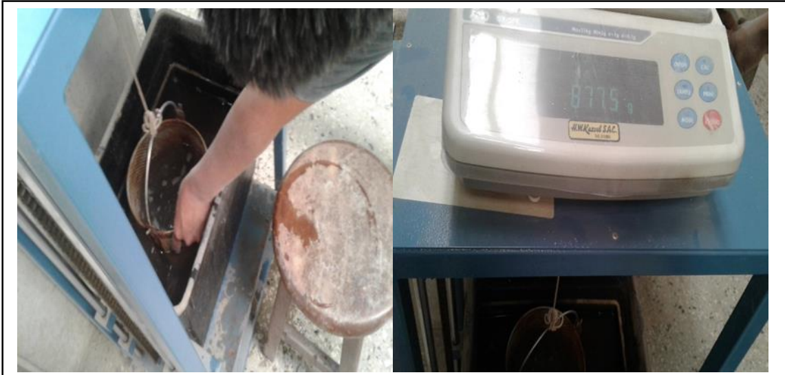
Figura 70. Muestra + cesta sumergida obteniendo el peso sumergido en agua. Fuente: Elaboración propia.
