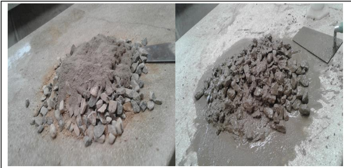
Figura 102. Mezclado del concreto fluida. Fuente: Elaboración propia.
