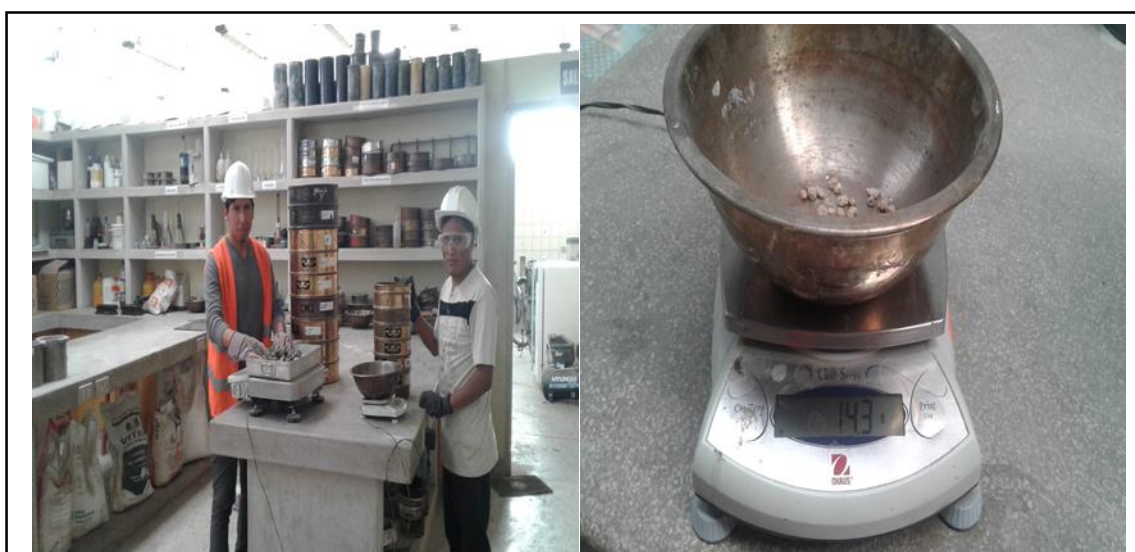
Figura 17. Juego de tamices y 14.3 g de muestra retenida en la malla N° 4. Fuente: Elaboración propia.
