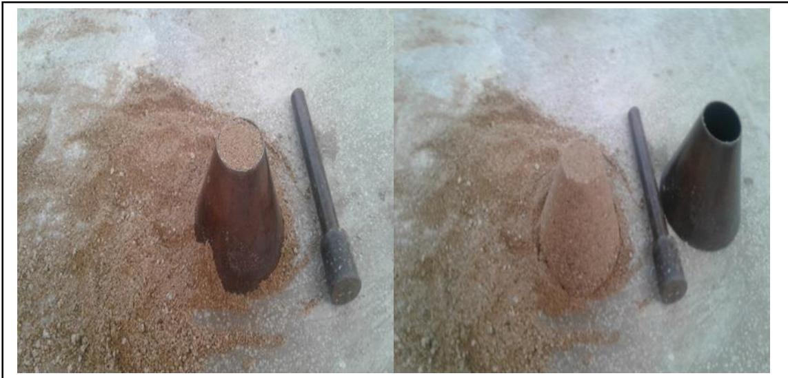
Figura 25. Verter el material en el molde cónico dando golpe 25 veces con la barra metal y retirarlos. Fuente: Elaboración propia.
