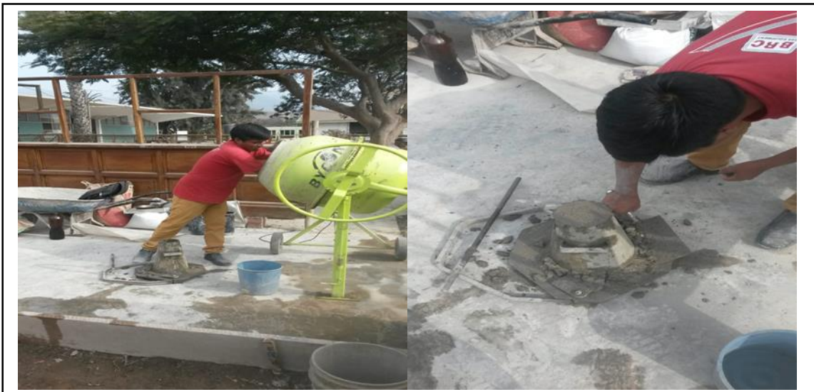
Figura 113. Vertimiento de la mezcla al cono de abrams. Fuente: Elaboración propia.
