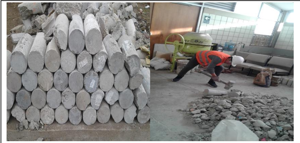
Figura 59. Probetas recicladas y proceso de trituración primaria. Fuente: Elaboración propia.
