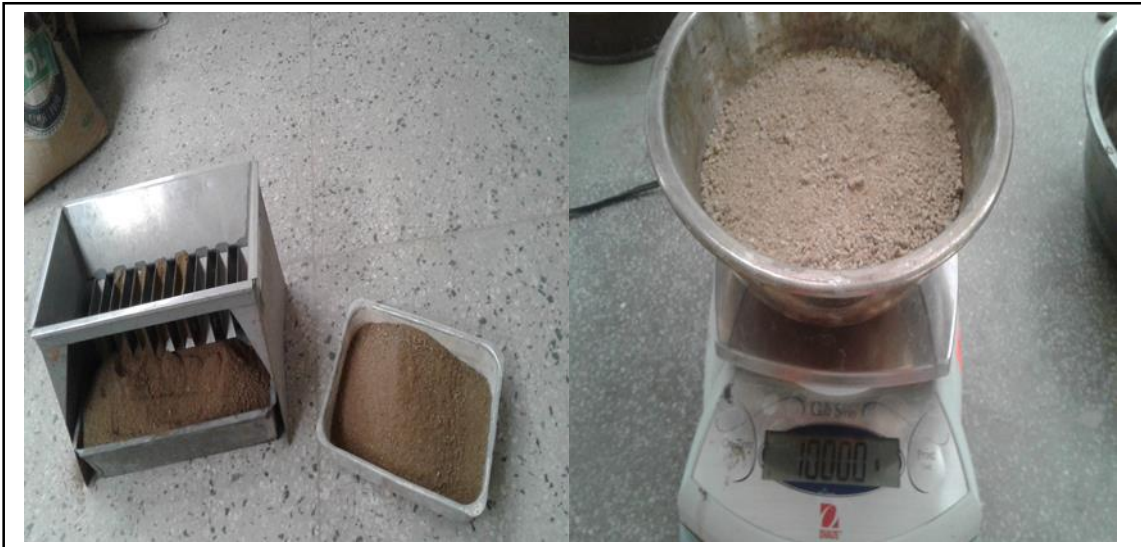
Figura 23. Cuarteo del material y peso de 1000 g de muestra. Fuente: Elaboración propia.
