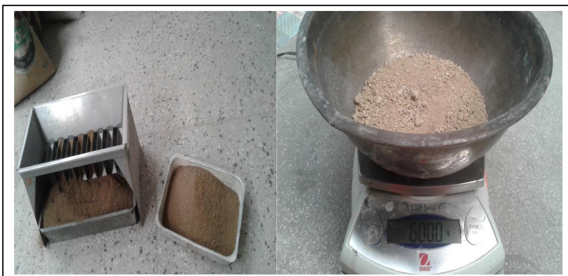
Figura 16. Cuarteo del material y peso de 600 g de muestra. Fuente: Elaboración propia.
