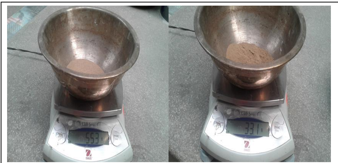
Figura 20. 55.3 y 33.1 g de muestra retenida en la malla N° 100 y fondo. Fuente: Elaboración propia.
