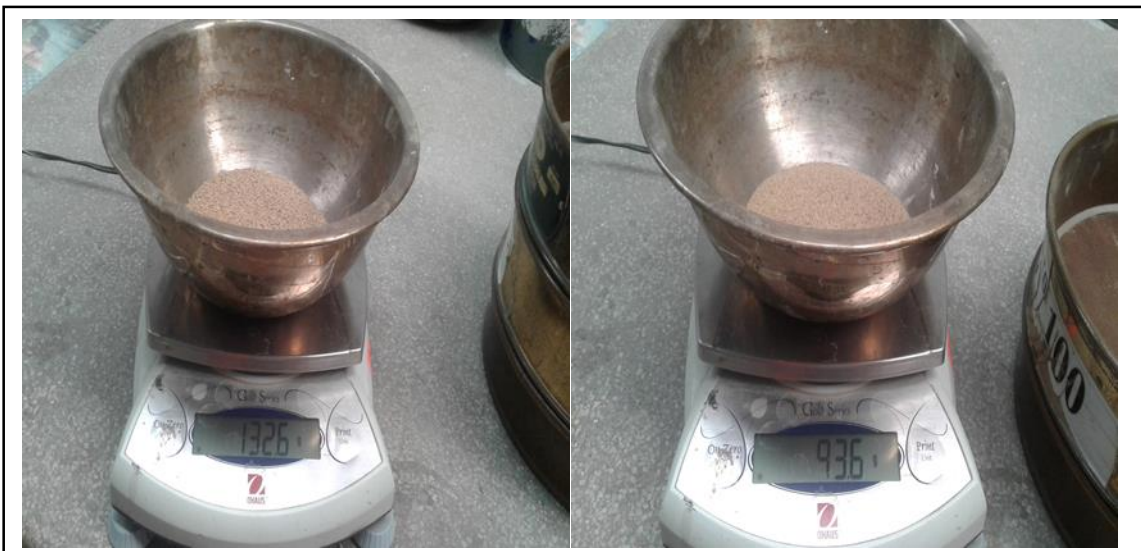
Figura 19. 132.6 y 93.6 g de muestras retenidas en las mallas N° 30 y N° 50. Fuente: Elaboración propia.
