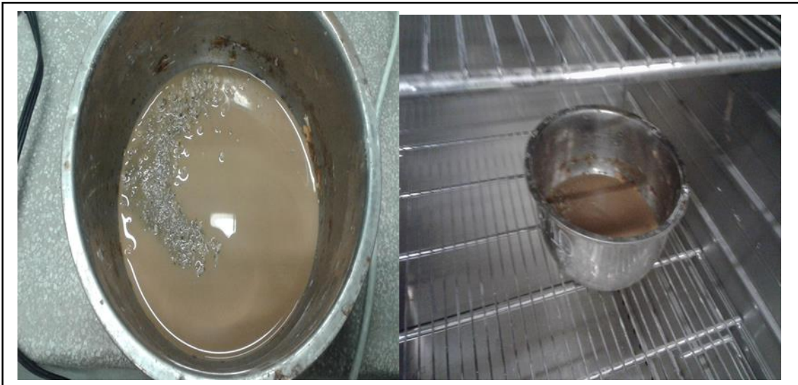
Figura 30. Muestra extraída del picnómetro y llevada al horno a 110 \pm 5^\circ \text{C} . Fuente: Elaboración propia.
