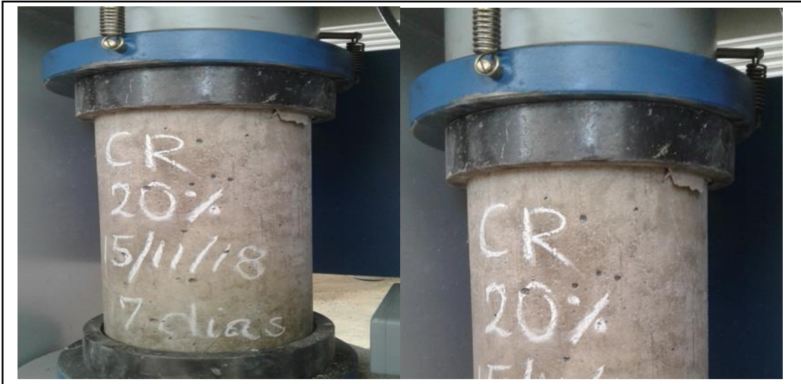
Figura 143. Fallas encontradas en los testigos. Fuente: Elaboración propia.
