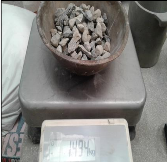
Figura 57. Peso de la muestra seca después de haber retirado del horno. Fuente: Elaboración propia.
