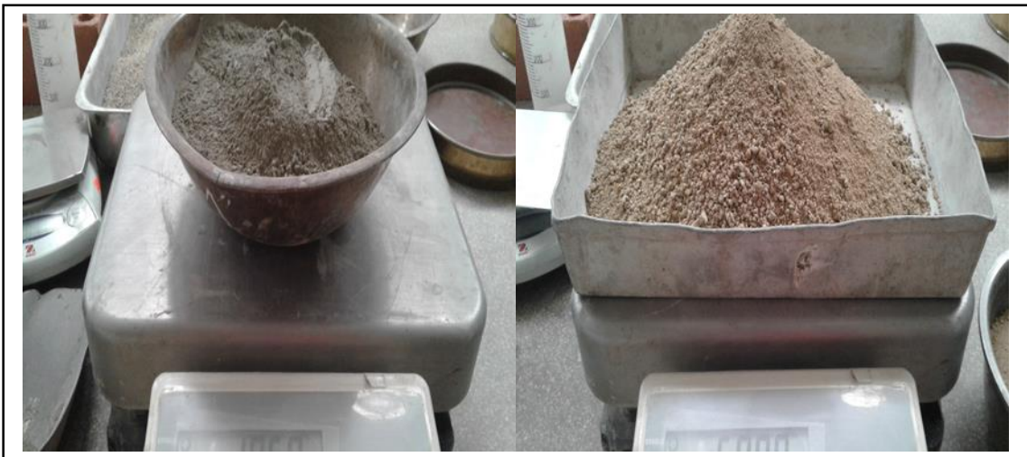
Figura 99. 209 y 561 g del cemento y agregado fino. Fuente: Elaboración propia.
