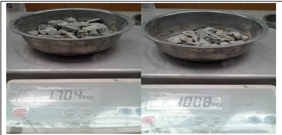
Figura 42. 1704 y 1088 g de muestra retenida en cada malla de ¾ y ½". Fuente: Elaboración propia.
