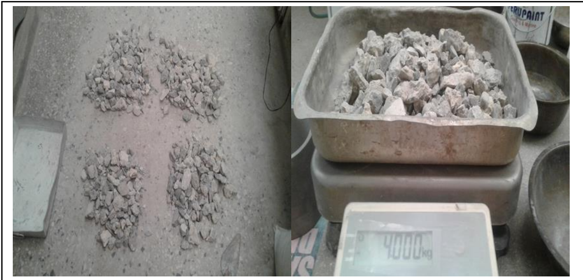
Figura 67. Cuarteo del material tomando 4000 g de agregado grueso reciclado. Fuente: Elaboración propia.
