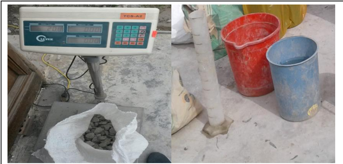
Figura 134. Pesado del agregado grueso reciclado y el agua requerida. Fuente: Elaboración propia.
