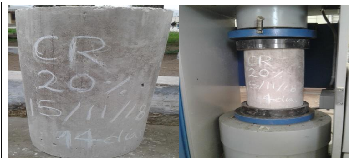
Figura 152. Testigos de resistencia a compresión de 14 días con un 20% de a.g. reciclado. Fuente: Elaboración propia.
