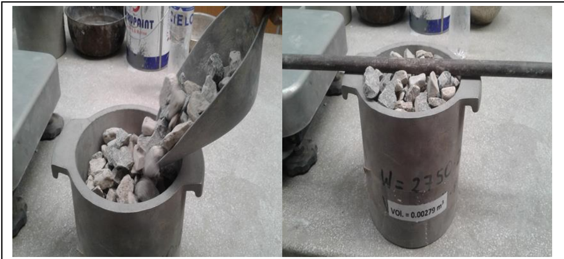
Figura 52. Vertimiento y enrasado de la muestra suelta. Fuente: Elaboración propia.
