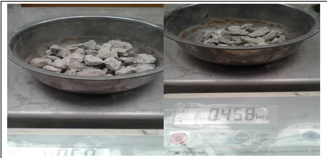
Figura 63. 858 y 458 g de muestras retenidas en las mallas 3/4" y 1/2". Fuente: Elaboración propia.
