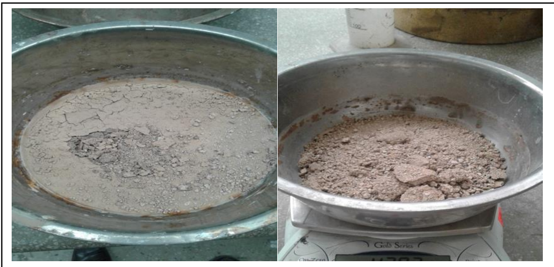
Figura 31. Obtención del peso de la muestra seco del agregado. Fuente: Elaboración propia.
