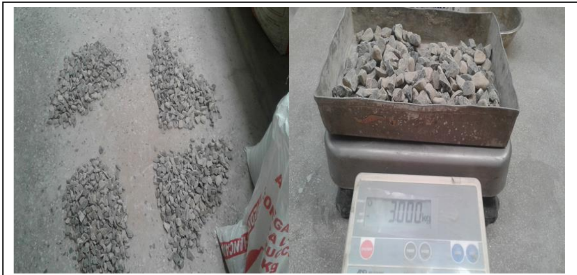
Figura 40. Cuarteo del material tomando una muestra de 3000 g. Fuente: Elaboración propia.
