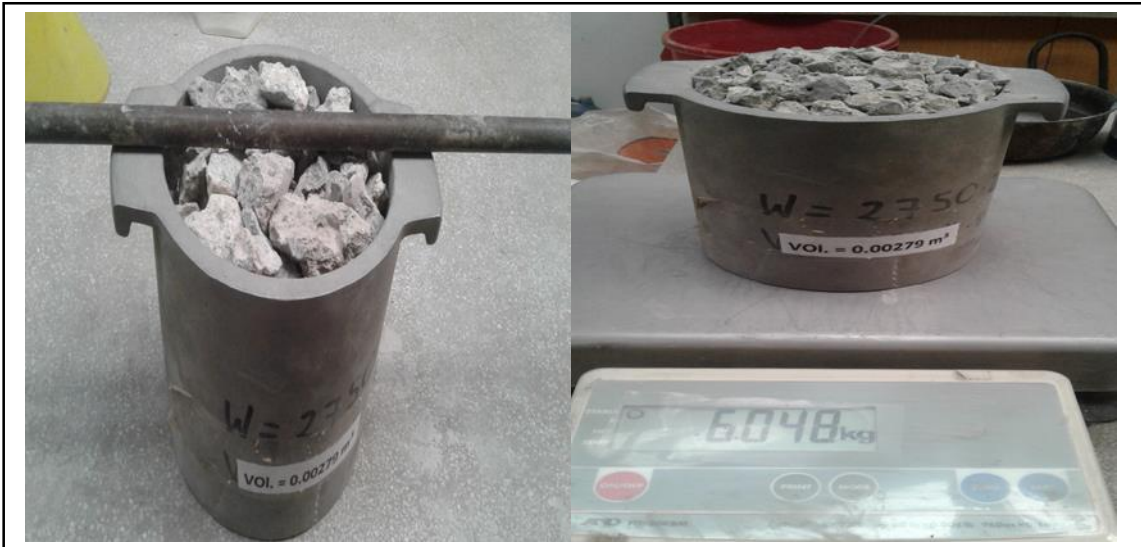
Figura 74. Enrasado de la muestra, obteniendo el peso de la muestra suelta. Fuente: Elaboración propia.
