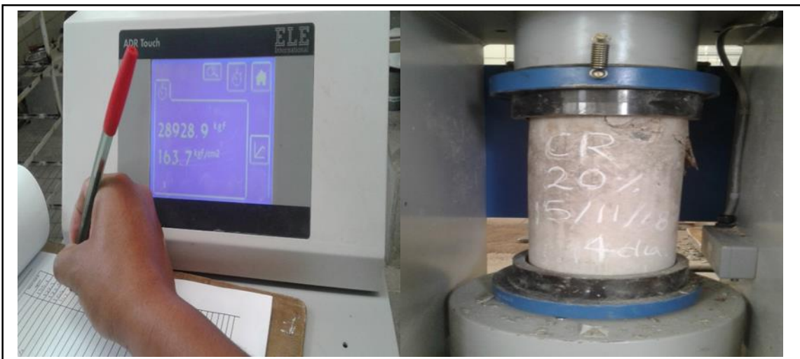
Figura 153. Resistencia registrada de 163.7 kg/cm 2 y las fallas mostradas. Fuente: Elaboración propia.
