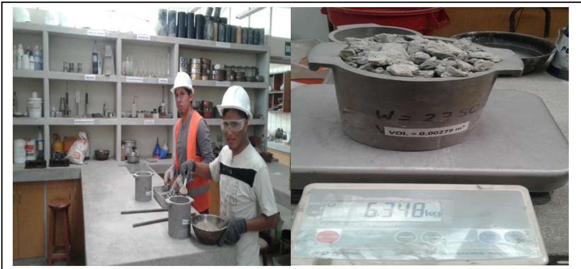
Figura 75. Vertimiento del material al cilindro, obteniendo el peso de la muestra compacta. Fuente: Elaboración propia.
