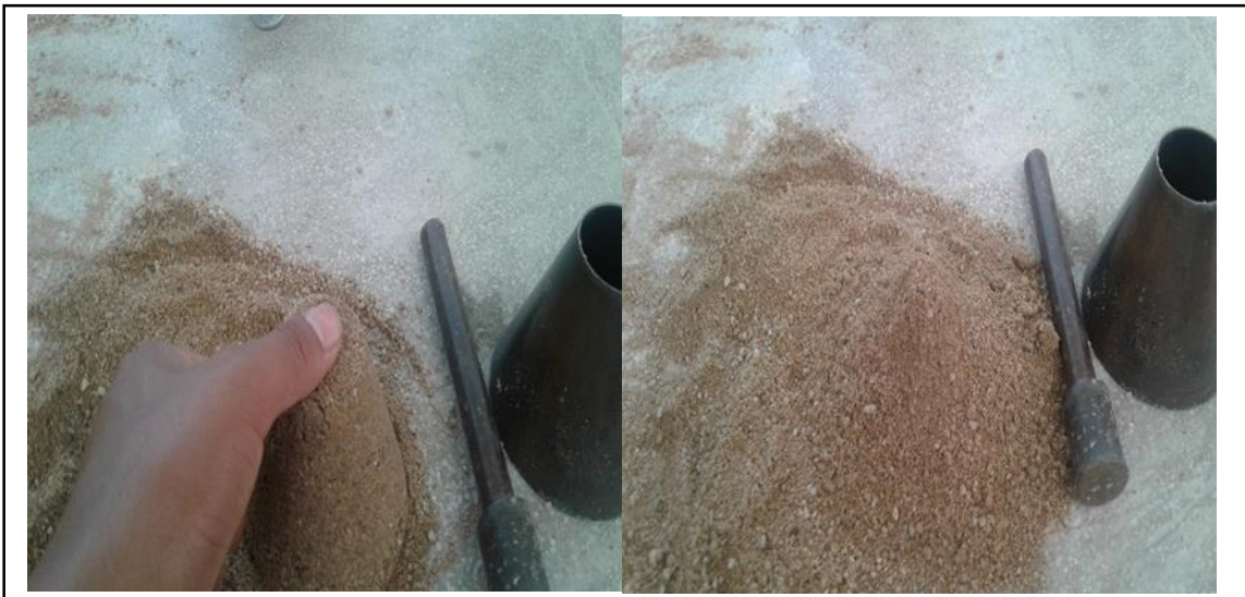
Figura 26. Verificación de la muestra desmoronada pulsando con el pulgar. Fuente: Elaboración propia.
