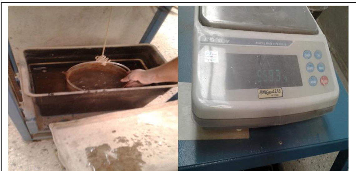
Figura 48. Muestra + cesta sumergida y obteniendo el peso sumergida en agua. Fuente: Elaboración propia.
