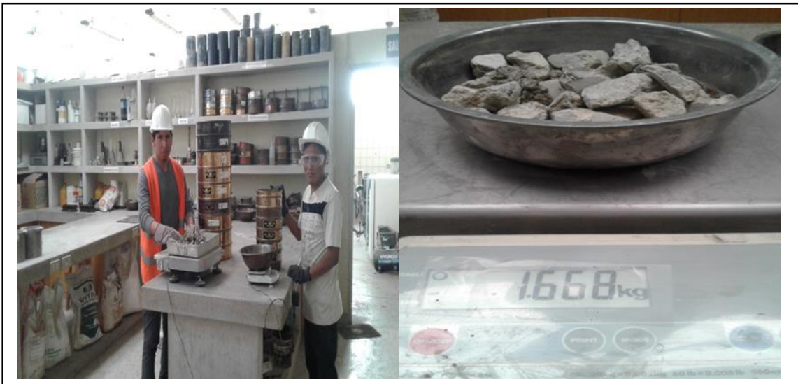
Figura 62. Juego de tamices y 1668 g de muestra retenida en la malla 1". Fuente: Elaboración propia.
