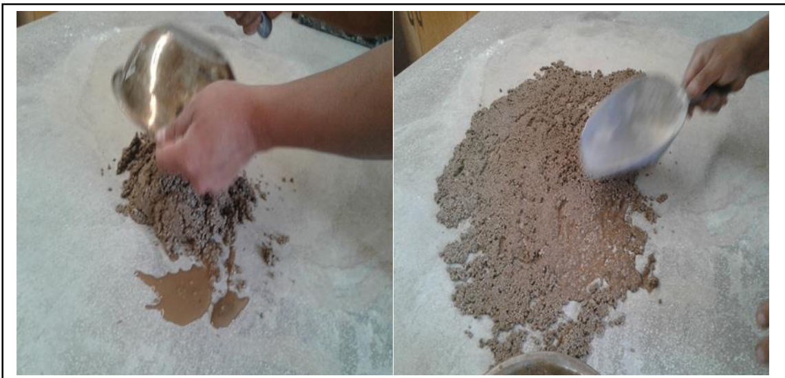
Figura 24. Extender el agregado fino sobre una superficie plana. Fuente: Elaboración propia.
