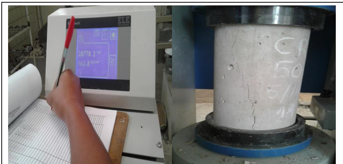
Figura 155. Resistencia registrada de 162.8 kg/cm 2 y las fallas mostradas. Fuente: Elaboración propia.
