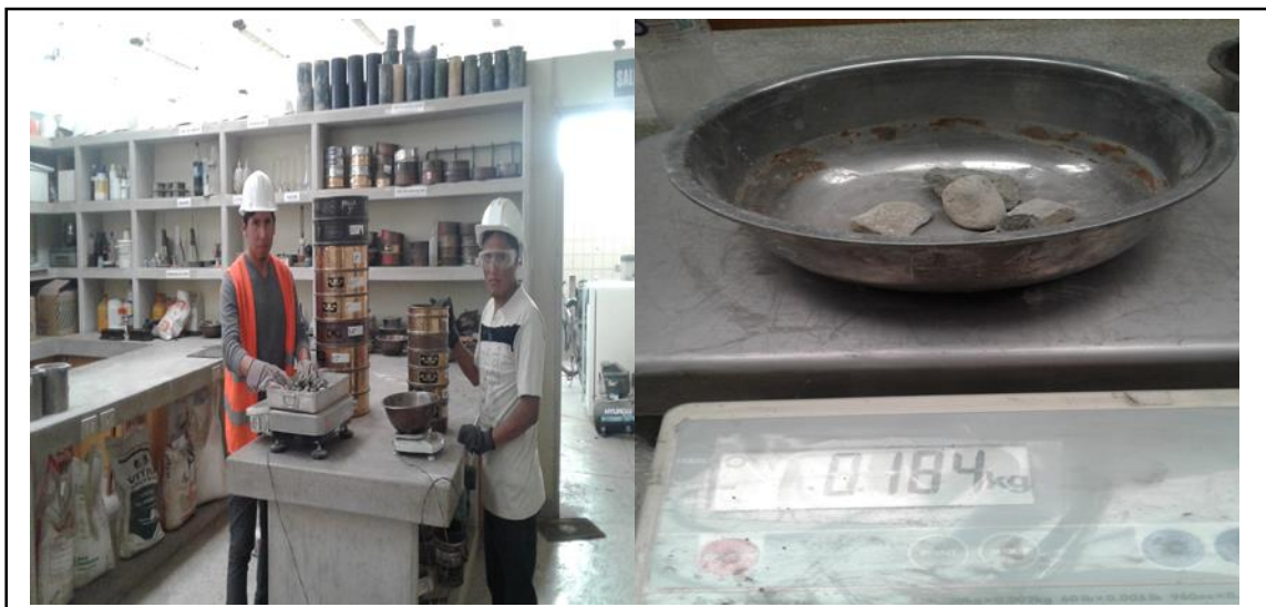
Figura 41. Respectivos tamices y 184 g de muestra retenida en la malla 1". Fuente: Elaboración propia.
