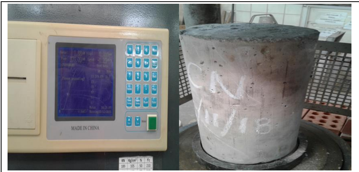
Figura 161. Resistencia de 210.1 kg/cm 2 y las fallas mostradas en el testigo. Fuente: Elaboración propia.
