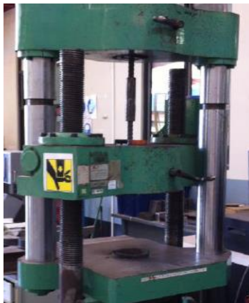
Figura 7. Ensayo de tensión empleando conector mecánico
