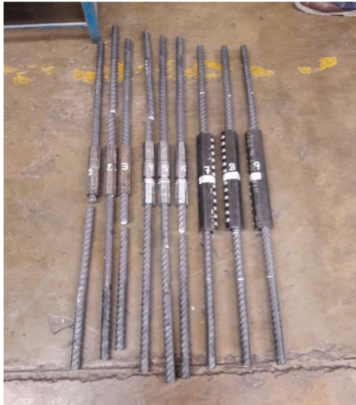
Muestras ensambladas después de la rotura
