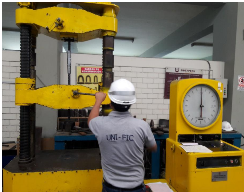
Fijado de las muestras en Máquina Universal
