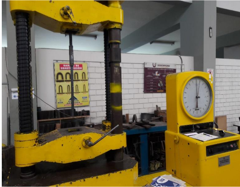
Inicio de ensayo de tracción de las muestras ensambladas
