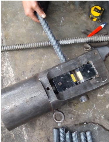
Primer prensado del conector de presión y de presión con rosca tipo 2
