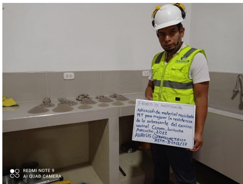
Figura 18. Peso de material retenido en las mallas
