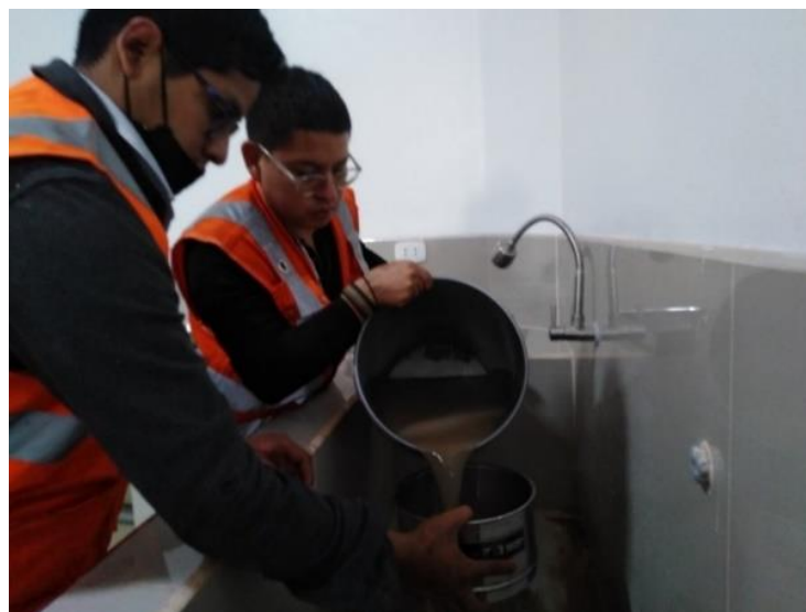
Figura 15. Lavado de muestra – material fino.
