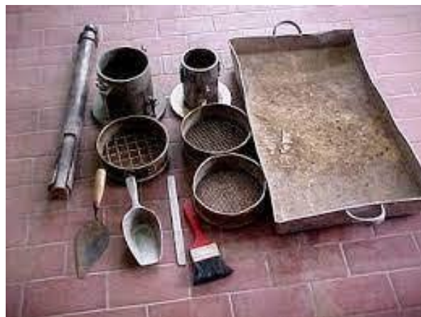
Figura 1. Instrumentos para ensayo de Proctor modificado
