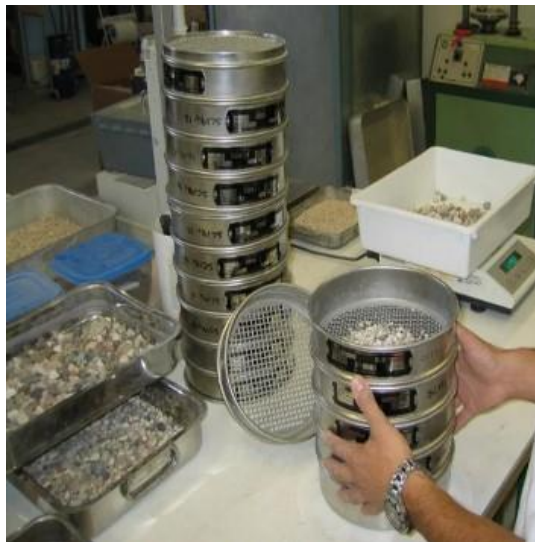
Figura 2. Instrumentos para ensayo de granulometría por tamizado
