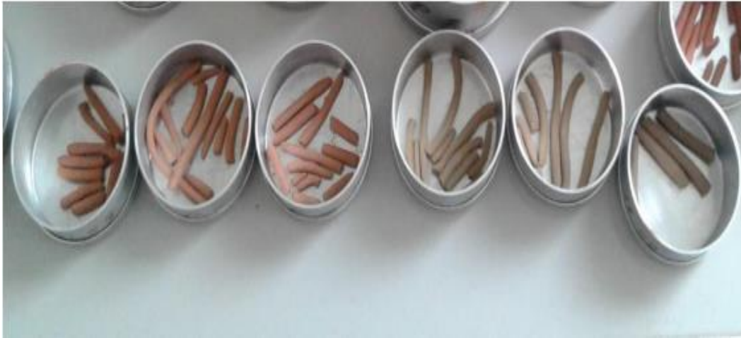
Figura 21. Muestra ensayo de limite plástico.
