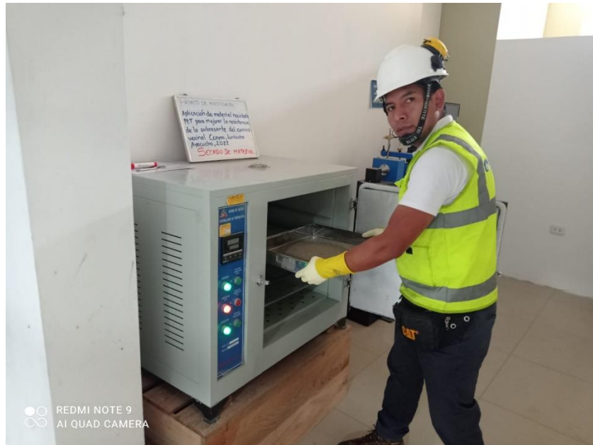
Figura 16. Secado de muestra lavada para tamizado T. 110 \pm 5 \text{ }^\circ\text{C} .
