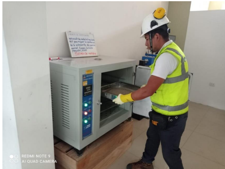
Figura 14. Secado de muestra para ensayo granulométrico T. 110 ± 5 °C.
