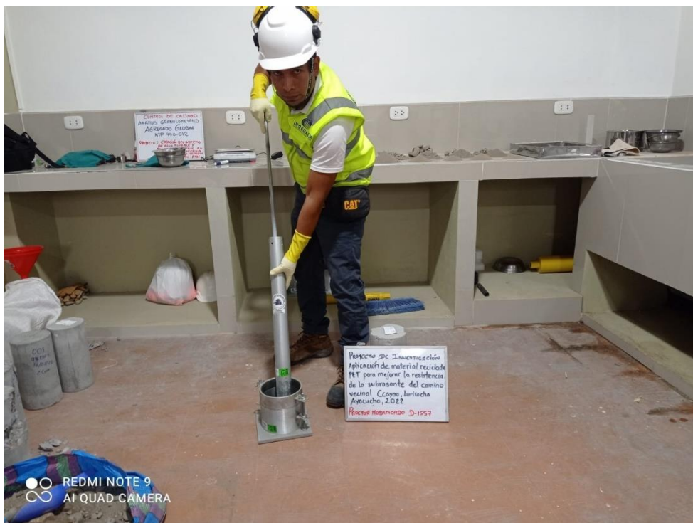
Figura 22. Ensayo de Proctor modificado MTCE - 115
