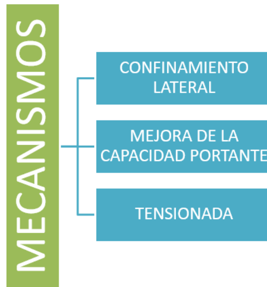
Figura 5. Mecanismos de reforzamiento de las geomallas.
