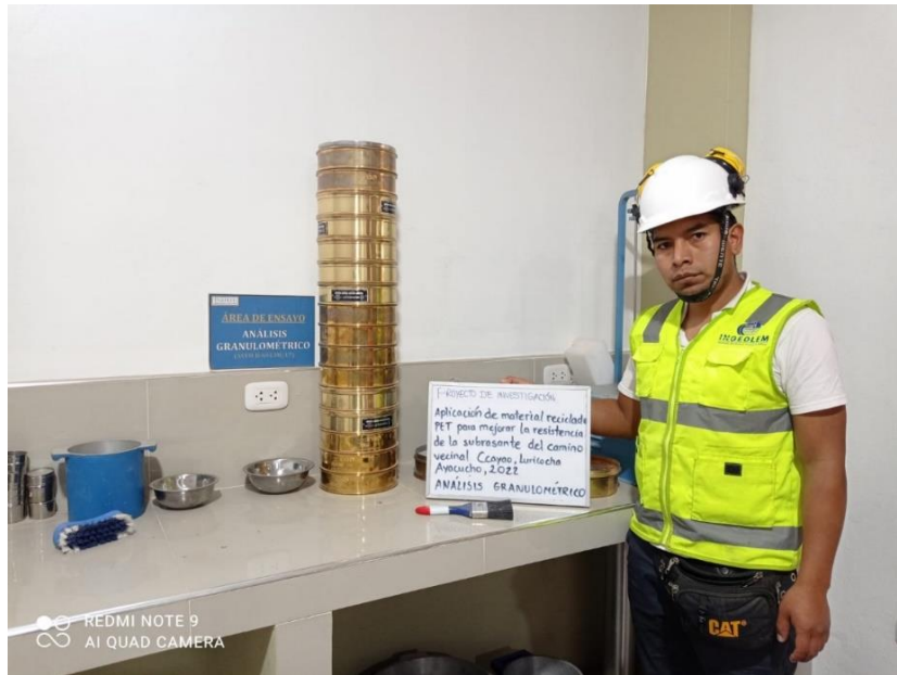
Figura 17. Análisis granulométrico por tamizado
