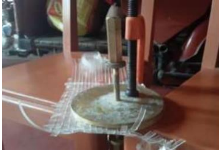
Figura 25. Geomalla biaxial de PET recortado al tamaño del molde.
