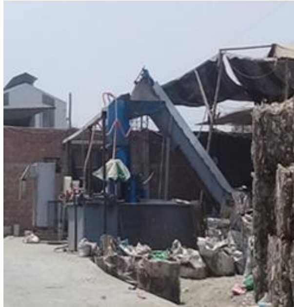
Figura 10. Máquina trituradora de plástico PET
