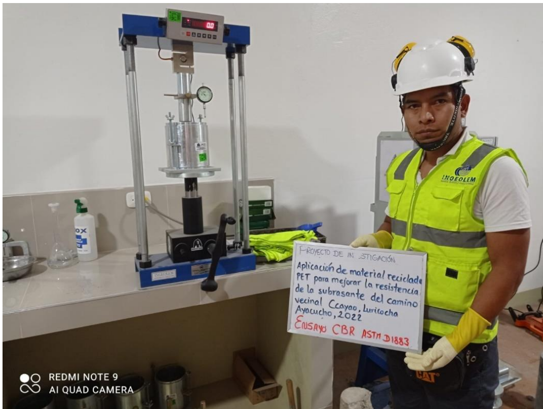
Figura 23. Ensayo de CBR - MTCE - 132
