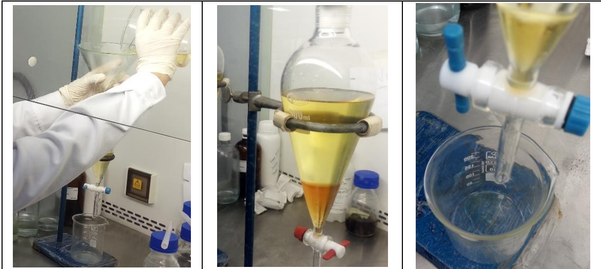
Figura 51. Separación de fases de biocombustible y glicerina en embudo de decantación.
