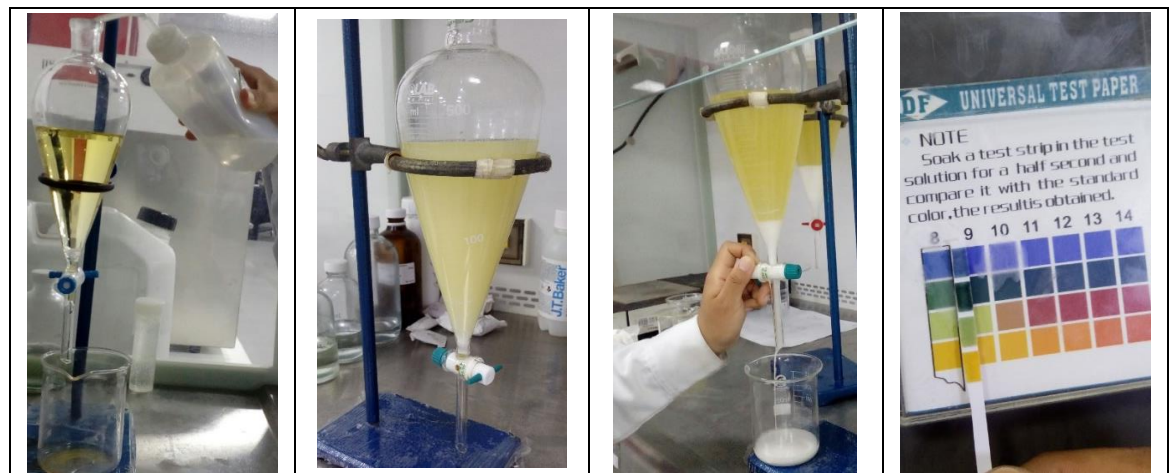
Figura 52. Lavado y agitación de éster metílico, y medición de pH de agua de lavado.
