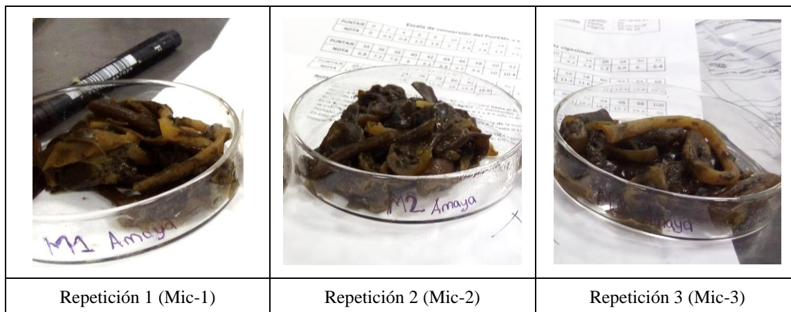
Figura 35. Muestras ya aplicando la destrucción celular por método de microondas.
