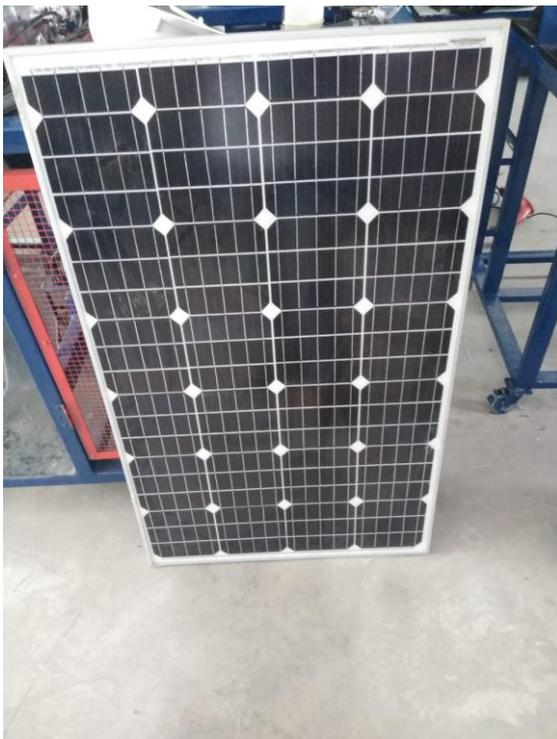
Figura 14.- Panel Fotovoltaico. Fuente: Propia
