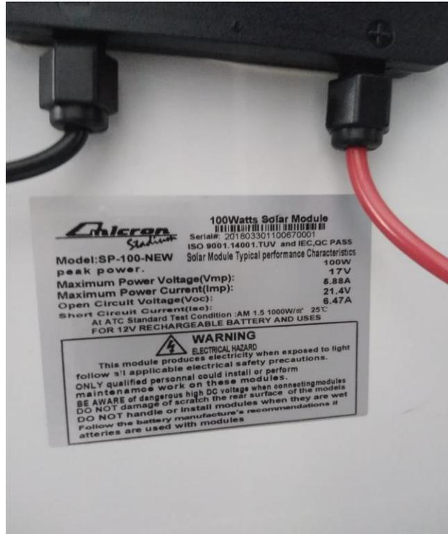
Figura 6.- Características técnicas del módulo. Fuente: Propia
