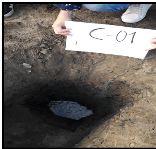
Figura N°3: Inicia a realizar la calicata N°1, napa freática
