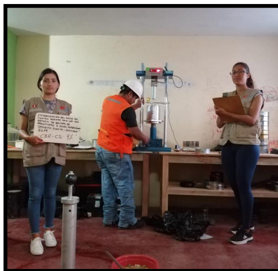
Figura N° 33: Ensayo de CBR Patrón en la prensa.
