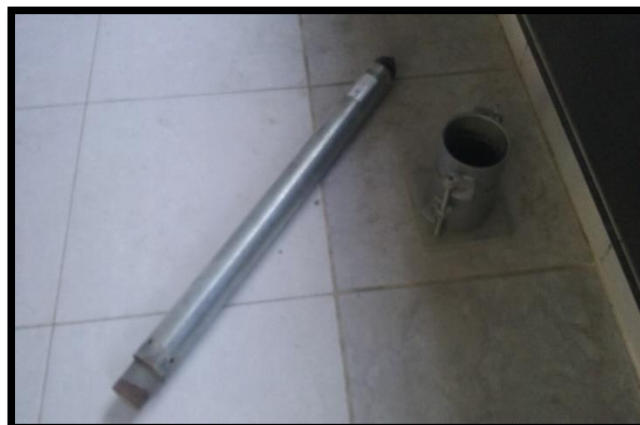
Figura N° 23: Equipos para el ensayo de Proctor Modificado, martillo de 10 lbs y molde.
