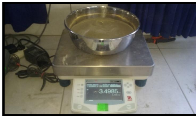
Figura N°20: Amasado del material (3kg) para el ensayo de Proctor Modificado Patrón Calicata N°1, con diferentes % de agua.
