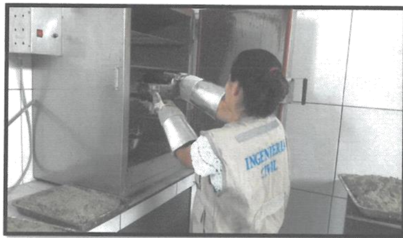
IMAGEN 04. Obtención del contenido de humedad secando la muestra al horno durante 24 horas.
