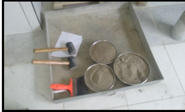
Figura N°19: Peso del material a utilizar para el Proctor Modificado Patrón Calicata N°1.
