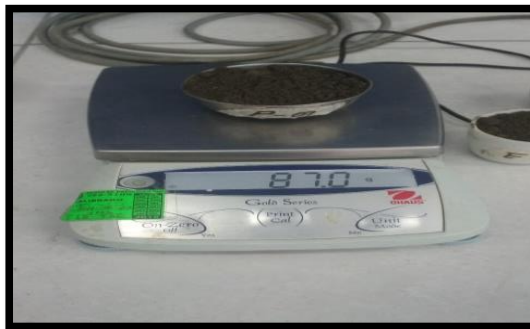
Figura N°11: Material seco de las muestras de la Calicata N°1.
