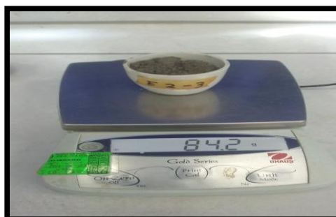
Figura N°12: Peso del material seco de la muestra de la Calicata N°1.
