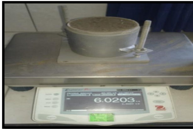
Figura N°26: Peso de la muestra interiormente del ensayo de Proctor Modificado Patrón Calicata N°1.
