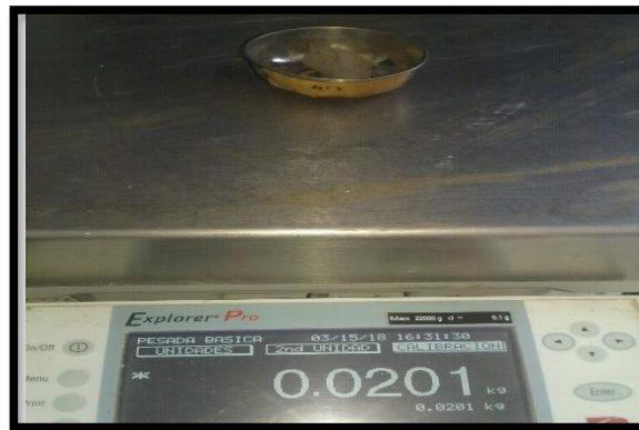
Figura N°17: Peso en seco del Límite líquido de la calicata N°1.
