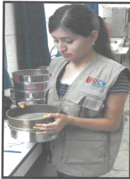
IMAGEN 03. Procedemos a la realización del tamizado para obtener los pesos retenidos clasificar el tipo de suelo.
