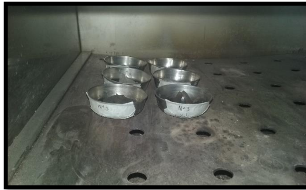
Figura N°17: Peso en seco del Límite líquido de la calicata N°1.
