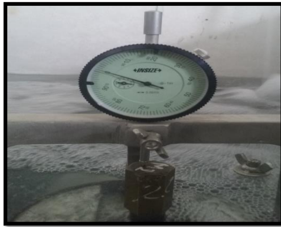
Figura N° 33: Ensayo de CBR Patrón en la prensa.
