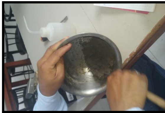
Figura N°15: Muestra del material granulado en la copa de Casagrande de la Calicata N°1.
