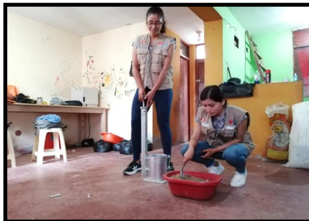
Figura N° 29: Realización del ensayo de CBR Patrón.
