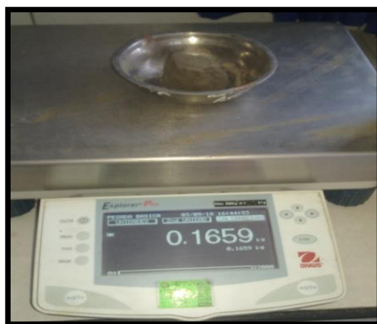
Figura N°26: Peso de la muestra interiormente del ensayo de Proctor Modificado Patrón Calicata N°1.
