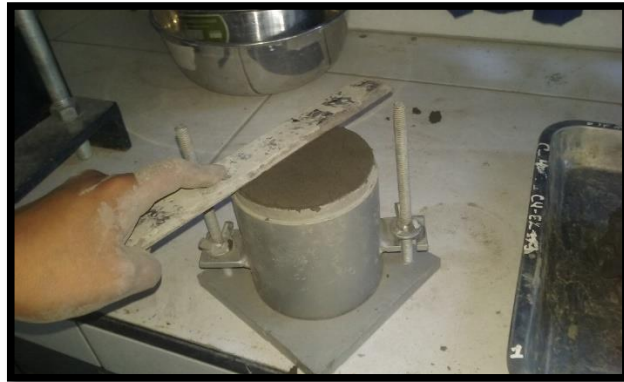
Figura N°25: Peso del 1er anillo del molde - Proctor Modificado Patrón Calicata N°1.
