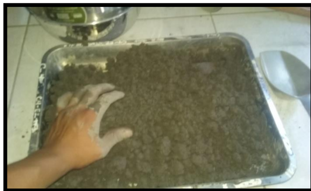
Figura N°20: Amasado del material (3kg) para el ensayo de Proctor Modificado Patrón Calicata N°1, con diferentes % de agua.
