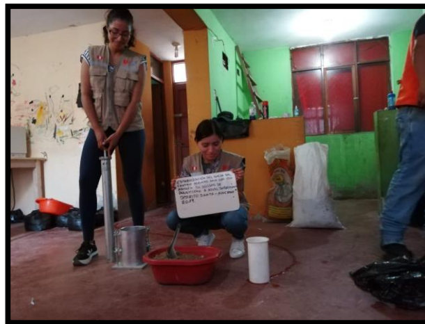
Figura N° 23: Equipos para el ensayo de Proctor Modificado, martillo de 10 lbs y molde.
