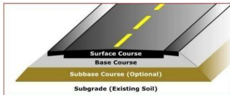
Figura 1.- Paquete estructural de pavimento flexible.
