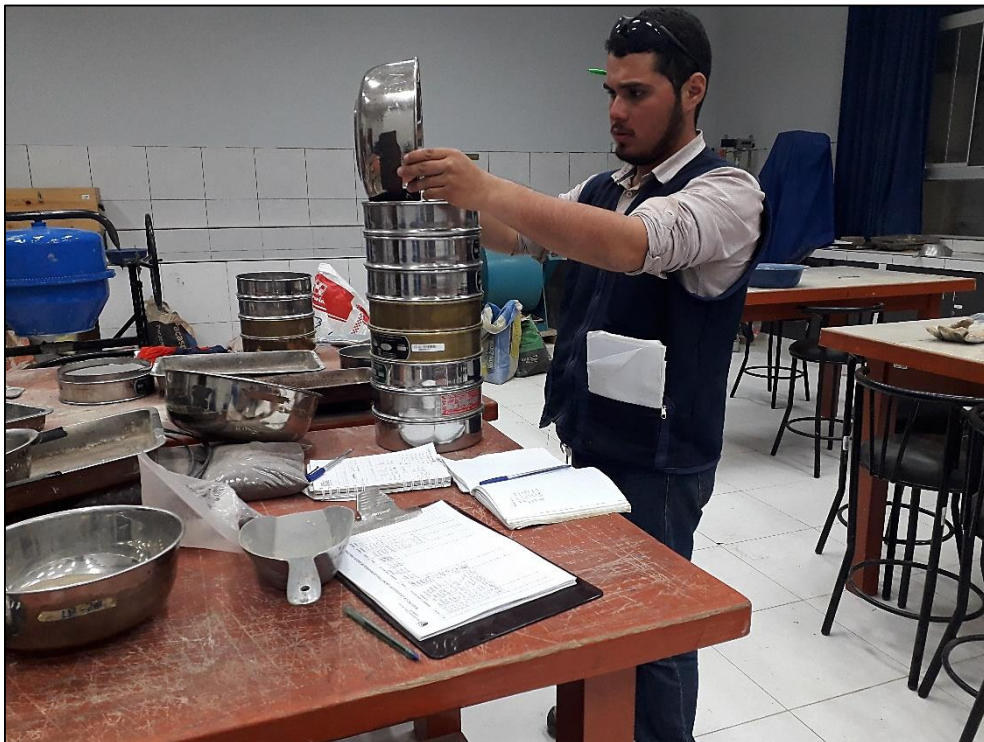
Fotografía N° 12. El tesista Breiner Yzaguirre Caballero realizando ensayo de granulometría en laboratorio.
