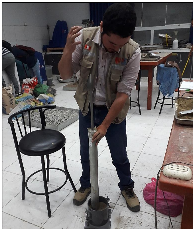
Fotografía N° 15. El tesista Breiner Yzaguirre Caballero realizando golpes de compactación del ensayo de C.B.R en laboratorio.
