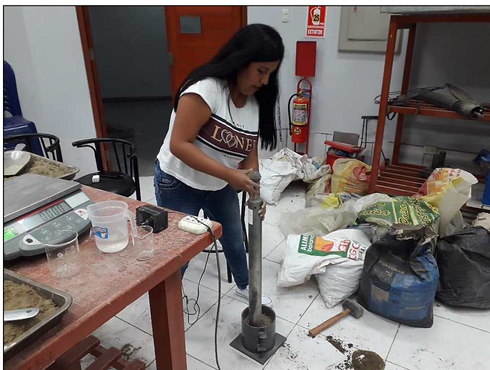
Fotografía N° 16. La tesista Lorena Luna Enriquez realizando golpes de compactación del ensayo de C.B.R en laboratorio.
