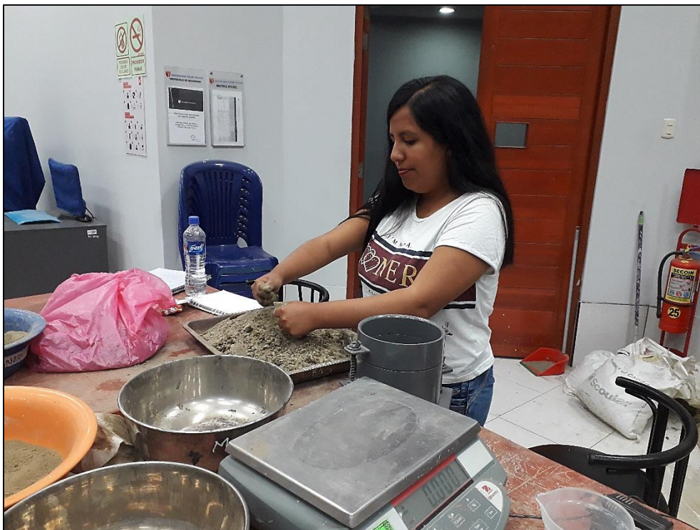
Fotografía N° 14. La tesista Lorena Luna Enriquez realizando ensayo de Proctor Modificado en laboratorio.
