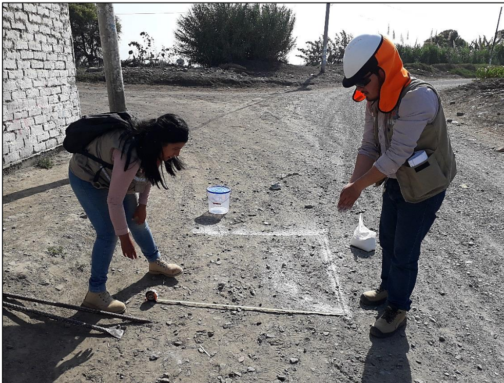
Fotografía N° 08. Los tesisistas Lorena Luna Enriquez y Breiner Yzaguirre Caballero realizando trazos para calicatas en la zona de estudio Red Vial Vecinal AN – 873.
