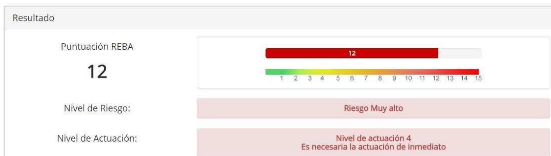
Fig. N° 94: Resultados finales. Evaluación del método Reba en el proceso de almacenaje-trabajador 1 de RAD CHEMICAL EIRL, 2018 Fuente: RAD CHEMICAL EIRL- procesos y operarios, 2018
