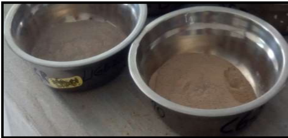
Figura 11: Muestra de la malla #40 y proceder a realizar los límites de consistencia
