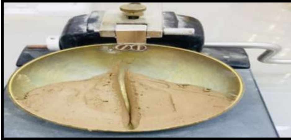
Figura 15: Proceso de numero de golpes hasta que cierre el surco
