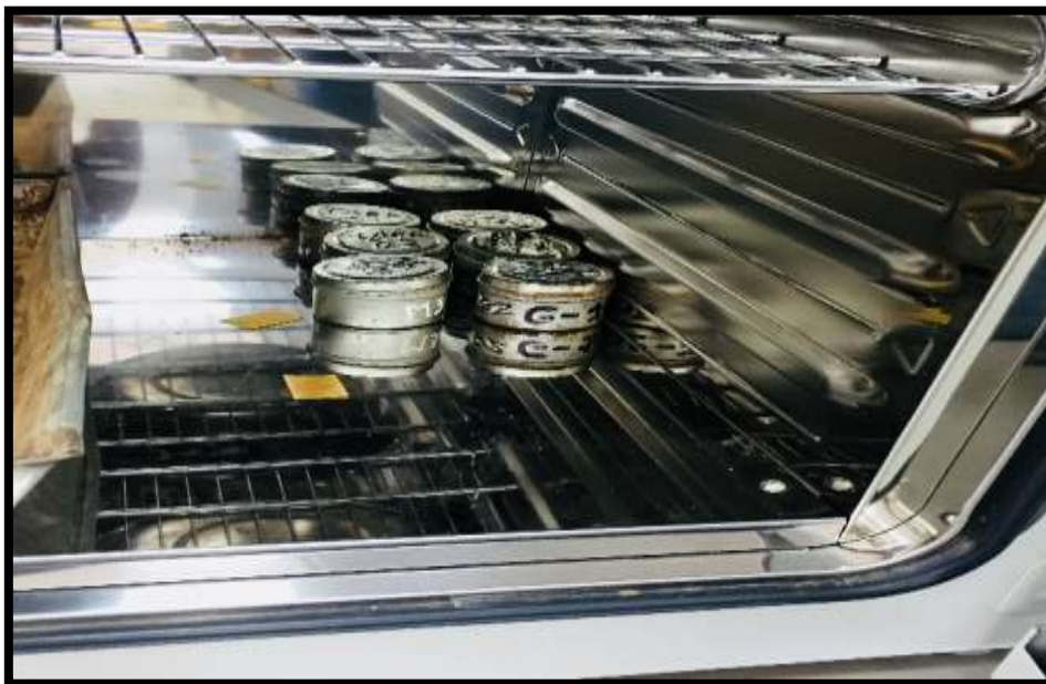
Figura 4: Muestras a secar 24 horas y luego ver la perdida de humedad.
