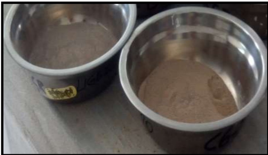
Figura 6: Muestra obtenida de la malla # 40 proceder el lavado
