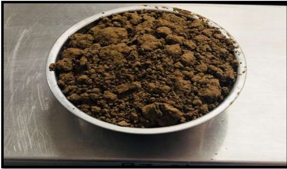
Figura 5: Poner a secar al horno la muestra 24h
