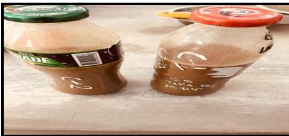
Figura 25: Agitación de la muestra por 1h y dejamos por 24h en reposo hasta tener un líquido claro
