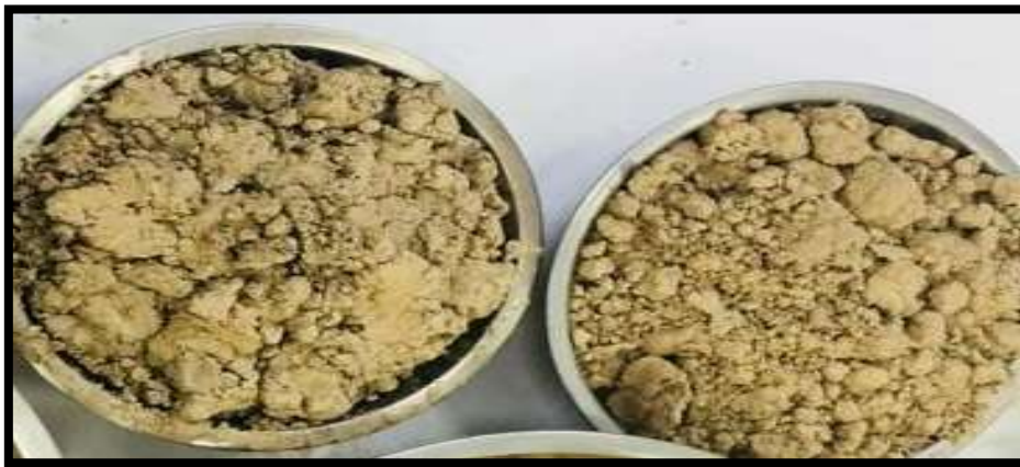
Figura 21: Muestra seca para elaborar el ensayo de sales solubles
