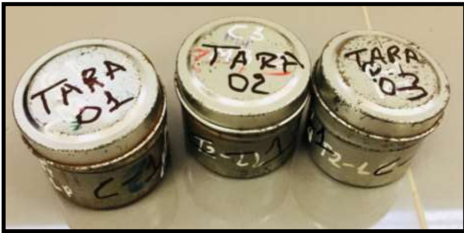
Figura 16: Muestras tomadas 5g de donde se cerró el surco y llevar al horno
