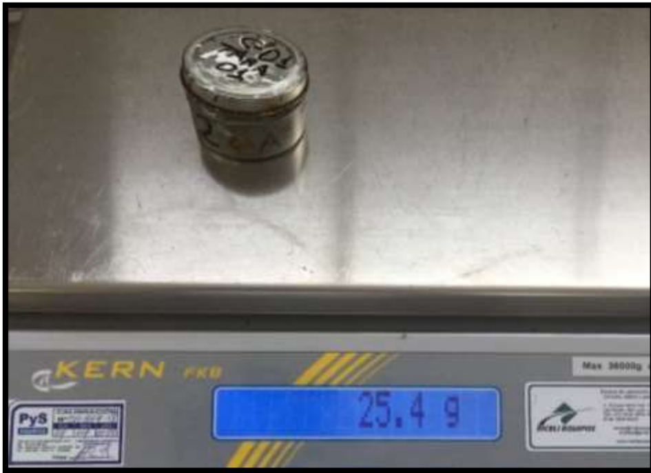
Figura 3: Muestra para el contenido de humedad
