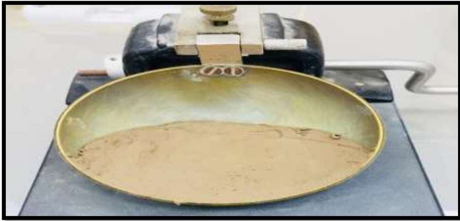
Figura 13: Colocación de muestra húmeda en la copa de casa grande
