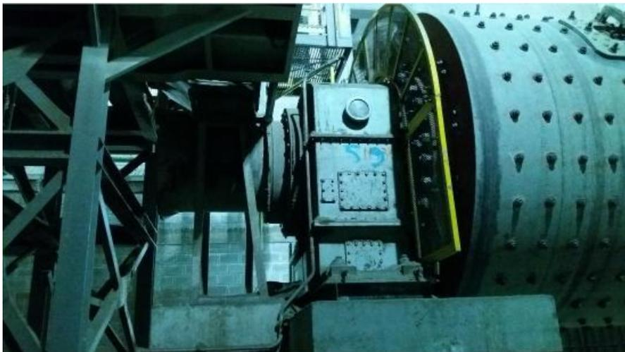
**Molino de bolas cemento 03: Estación de lubricación chumacera de entrada**
