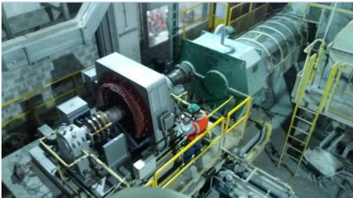
**Molino de bolas cemento 03: Estaciones de lubricación del motor y reductor**
