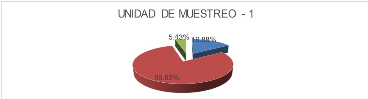
En su grafica nos muestra que el 99.82%, corresponde a la falla de pulimiento de agregados con una severidad (H) alta; el 19.88% corresponde a grietas longitudinales y transversales con severidad alta (H); y por ultimo nos muestra con un 5% a la falla tipo hinchamiento que posee una severidad media.
