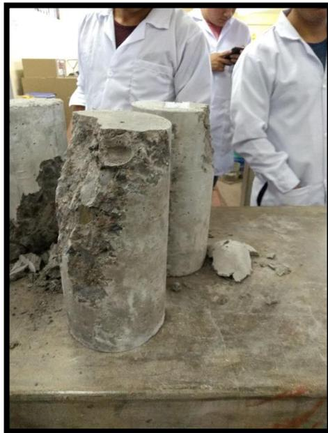
4.- Probetas sometidas al ensayo de Resistencia a la Compresión a los 14 días de curado
