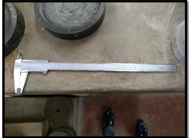
2.- Utilizando el vernier se procedio a medir el diámetro de cada probeta para luego hallar el área de la sección
