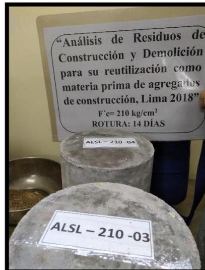
1.-A los 14 días se se trasladaron 2 probetas diseñadas para un F'c 175 kg/cm<sup>2</sup> y 2 probetas diseñadas para un F'c 210 kg/cm<sup>2</sup> de Villa el Salvador hacia el Laboratorio de Ensayo de Materiales de la Universidad Nacional Federico Villareal para realizar el ensayo de Resistencia a la Compresión.
