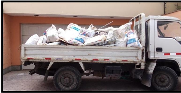
Figura 11. Traslado de RCD.
