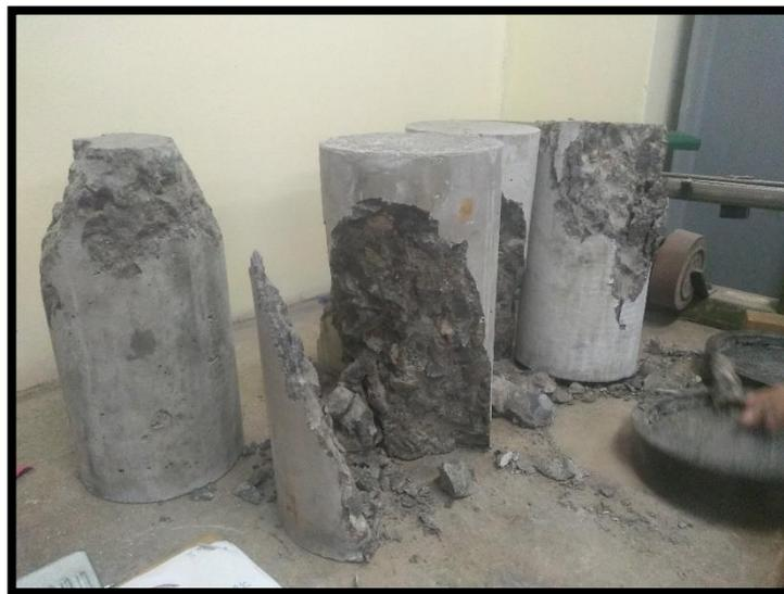
4.- Probetas sometidas al ensayo de Resistencia a la Compresión a los 28 días de curado
