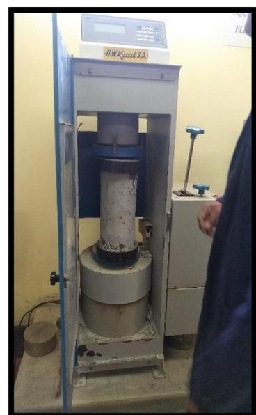
3.- El laboratorio de ensayo de materiales de la U.N.F.V., cuenta con un equipo de compresión digital para realizar el ensayo de Resistencia a la Compresión.
