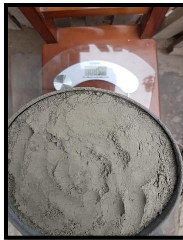
1.- Colocamos cada material (agregado fino, grueso y cemento) en los recipientes metálicos para proceder a pesarlos.
