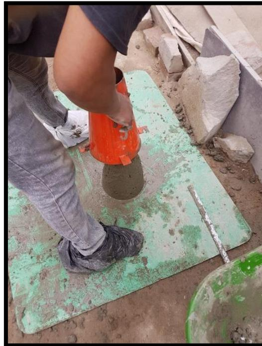
5.- Se procedio a trasladar el concreto elaborado al Cono de Abrams utilizando la cuchara de metal, fue vaciado en tres capas, donde cada capa se compacto uniformemente aplicando 25 golpas, la ultima capa se llena por esceso y se alisas con la varilla compactadora, luego se lavanta el molde de forma vertical y e va medir con wincha el asentamiento.
