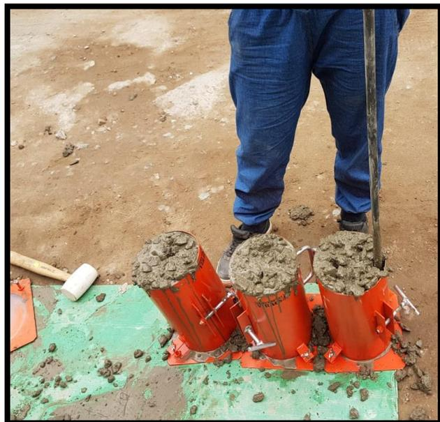
7.- Para la elaboración de las probetas de concreto, se emplearon moldes cilindricos de 6" las cuales como primer paso se cubrio con aceite de carro (que nos va servir como
