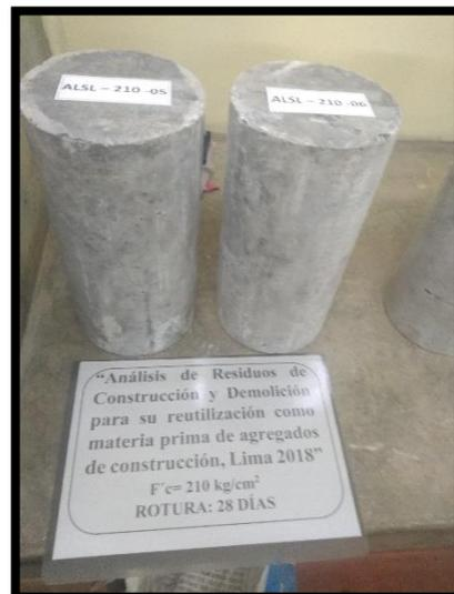
1.-A los 24 días se se trasladaron las últimas 2 probetas diseñadas para un  $F'c$  175 kg/cm<sup>2</sup> y 2 probetas diseñadas para un  $F'c$  210 kg/cm<sup>2</sup> de Villa el Salvador hacia el Laboratorio de Ensayo de Materiales de la Universidad Nacional Federico Villareal para realizar el ensayo de Resistencia a la Compresión.
