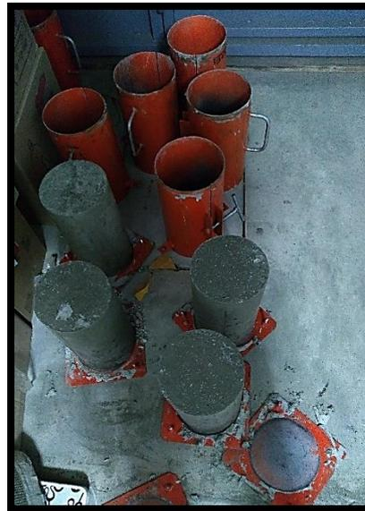
9.- Al día siguiente se procedio a desmoldar y a realizar el curado hasta los días que se tenga que realizar el ensayo, para verificar la resitencia obtenida.
