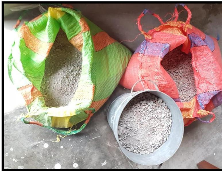
*Figura 15.* Agregado reciclado triturado en UNALM.
