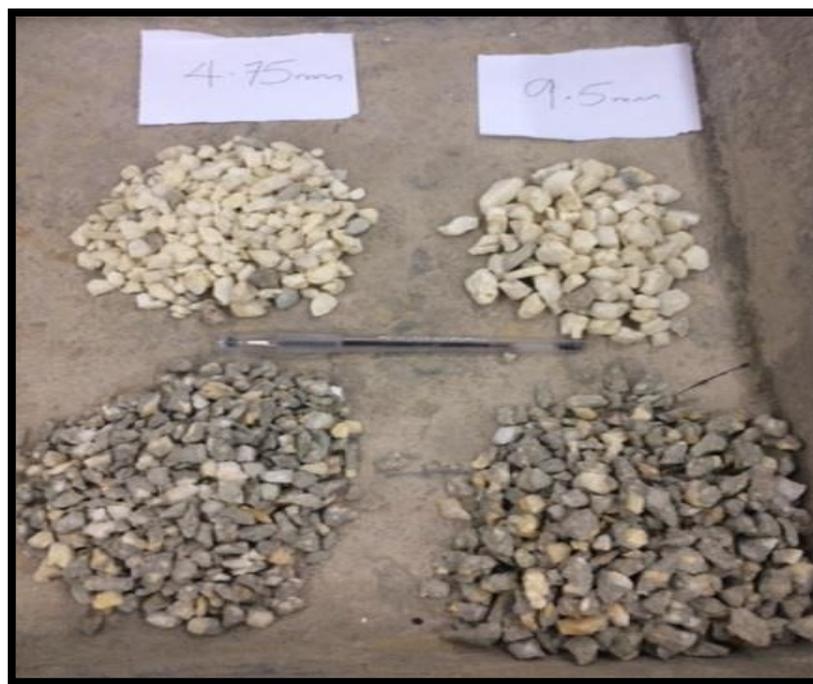
*Figura 1.* Comparación entre agregados naturales (crema en color) y agregados reciclados (color gris).
