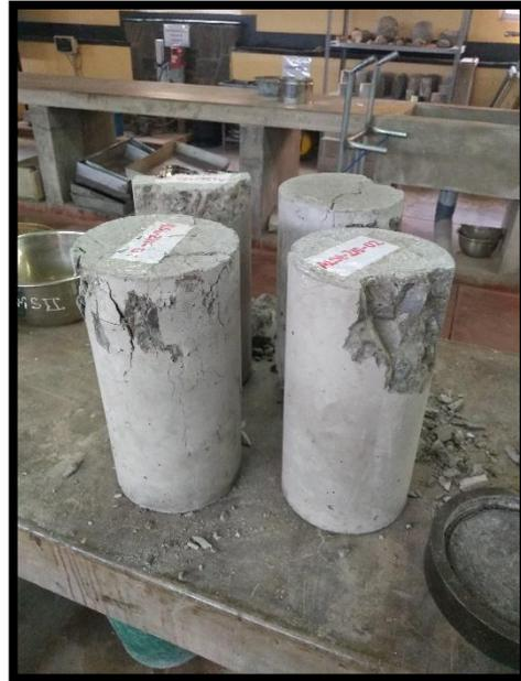
4.- Probetas sometidas al ensayo de Resistencia a la Compresión a los 7 días de curado
