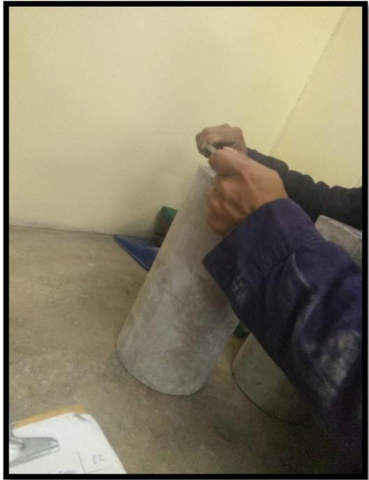
2.- Utilizando el vernier se procedio a medir el diámetro de cada probeta para luego hallar el área de la sección
