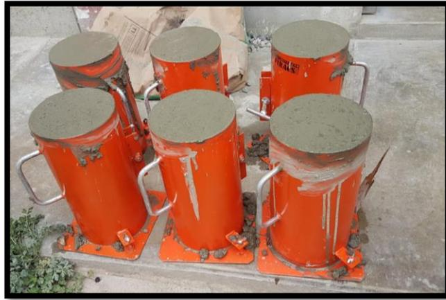
8.- Se va nivelar la superficie de cada probeta, además se tiene que identificar las mismas.
