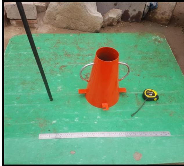
4.- Mezclamos con la cuchara de muestreo y se va realizar el ensayo del concreto en esta fresco “Asentamiento del concreto” para los dos diseños de mezclas.
