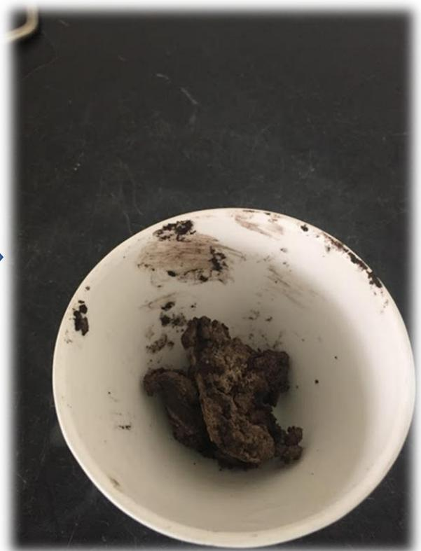
Anexo n°6 : Proceso de Pirolisis , se llevó la muestra secada a la mufla a las diferentes temperaturas
