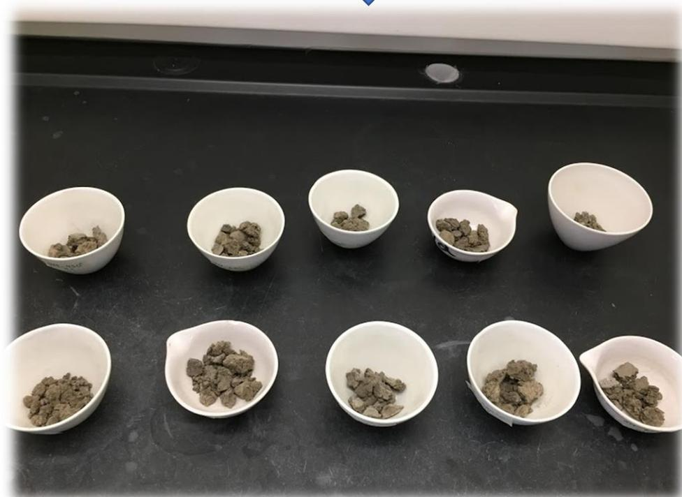
**Anexo n° 5** Proceso de activación con ácido fosfórico, se añadió 15 ml de ácido fosfórico se introdujo un magneto y se llevó al agitador magnético a una temperatura de 85°C, durante 2 horas y se llevó al horno para secarlo durante 2 horas.
