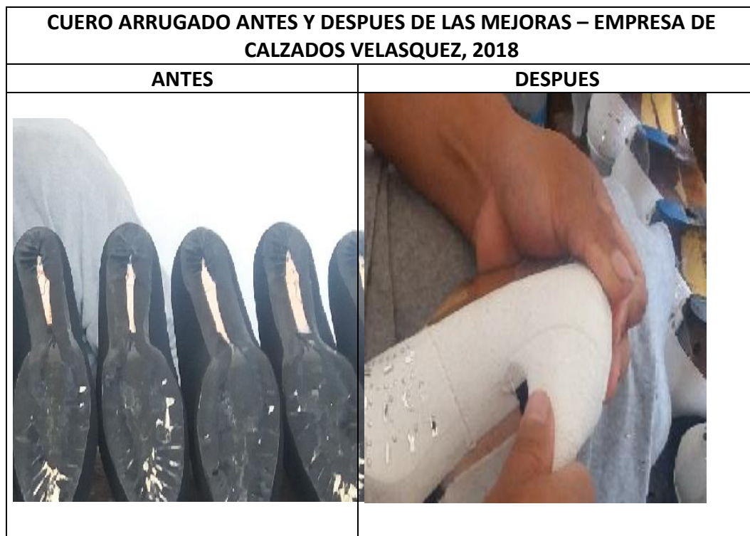
Figura 15: Falla de cuero de talón arrugado de calzado modelo tacos para dama, empresa de calzados Velásquez, octubre 2018.
