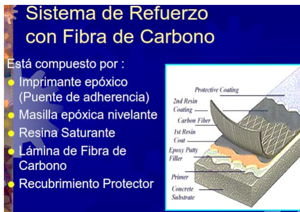
Figura 20 Proceso de instalación de fibra de carbono en un elemento estructural
