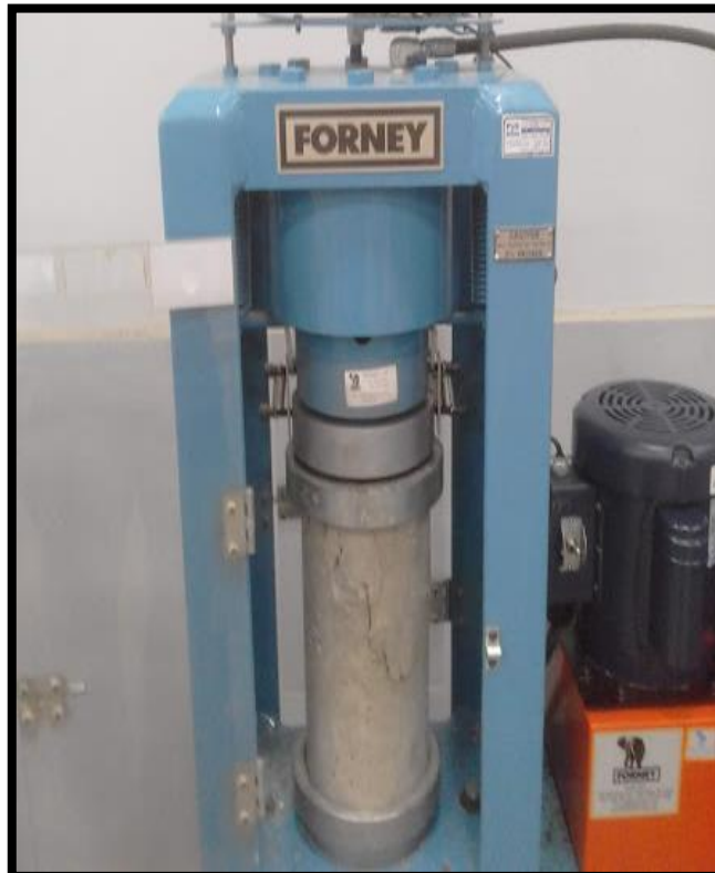
Ilustración 25. Rotura del testigo con falla de tipo 5
