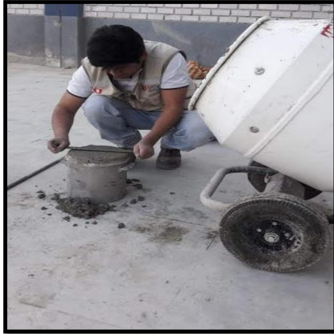
Ilustración 18. Se realizó el peso unitario del DP y DP – PT
