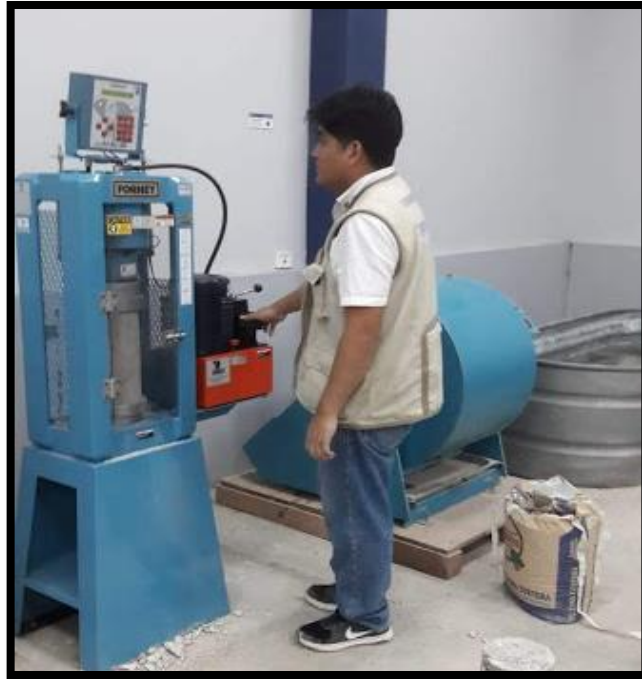
Ilustración 24. Rotura en la Prensa hidráulica
