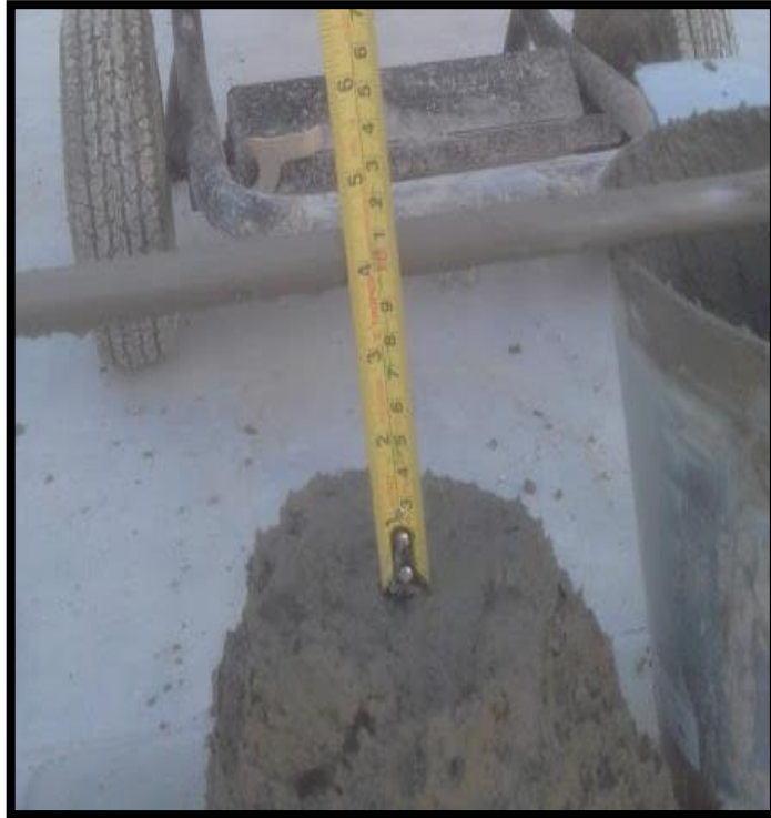
Ilustración 20. El asentamiento del diseño patrón
