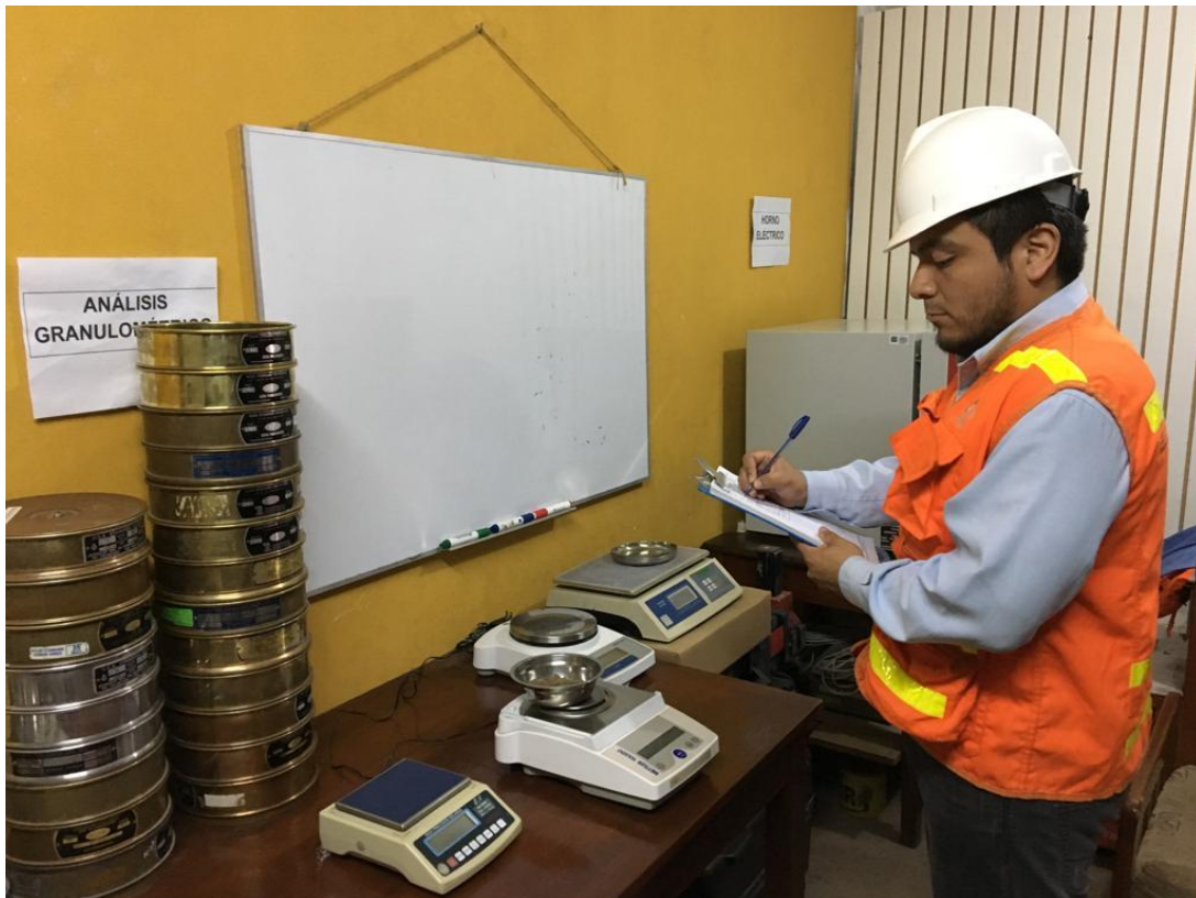
Imagen No. 7. Pesado de muestra de suelo para determinar el contenido de humedad.
