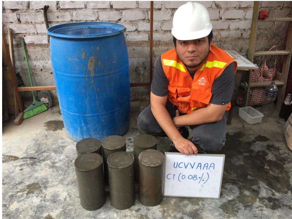
Imagen No. 11 Probetas con tiras al 0.08%.
