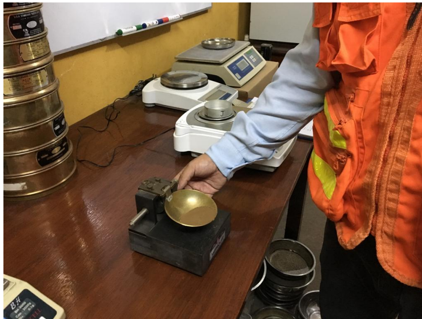
Imagen No.9. Determinación del ensayo de Límite líquido.
