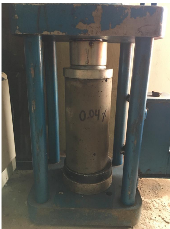
Imagen 12. Proceso de rotura de probeta antes de ser ensayada.
