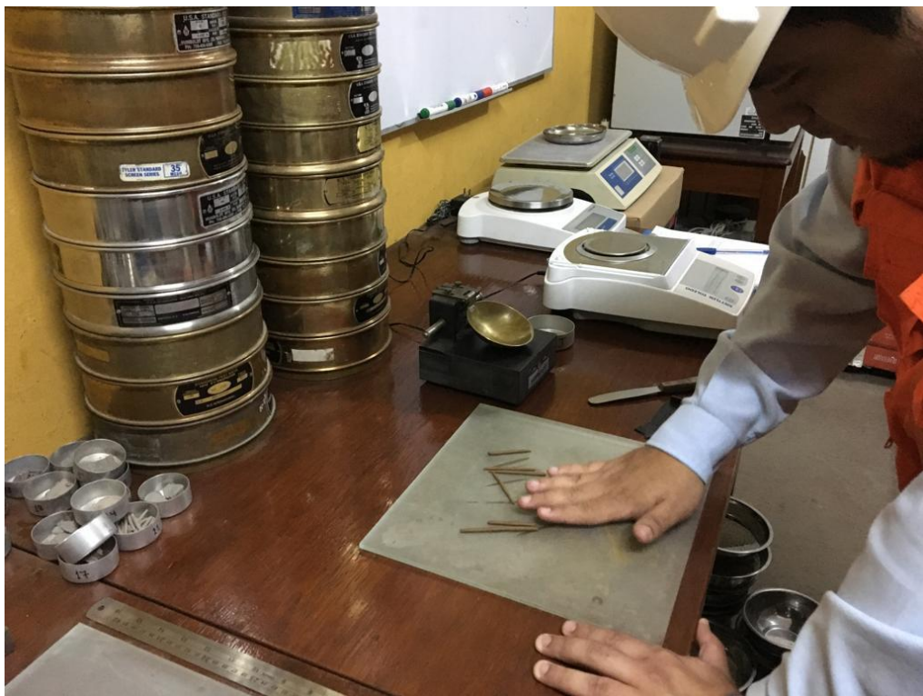
Imagen No.10. Determinación del ensayo de Límite plástico.
