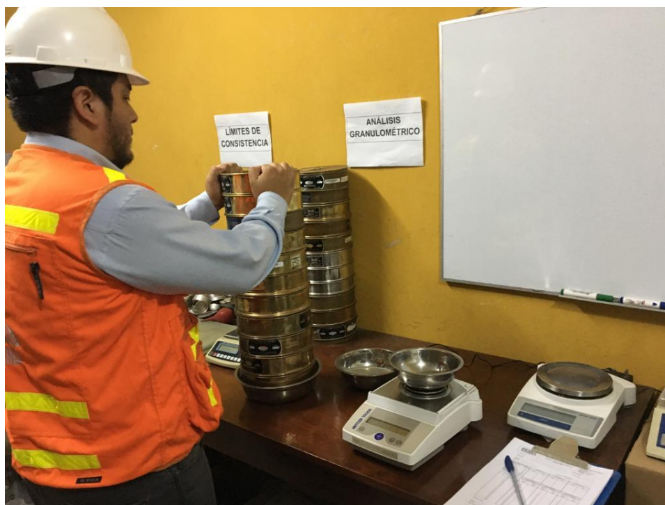
Imagen No.5: Juego de tamices utilizados para el análisis granulométrico.
