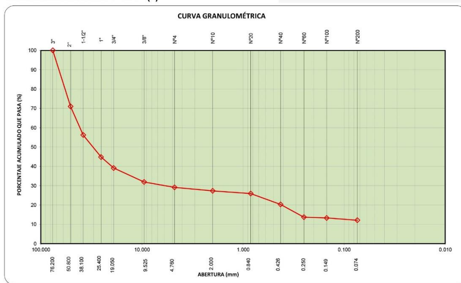
Figura No. 7: Curva granulométrica: Sub Base.
