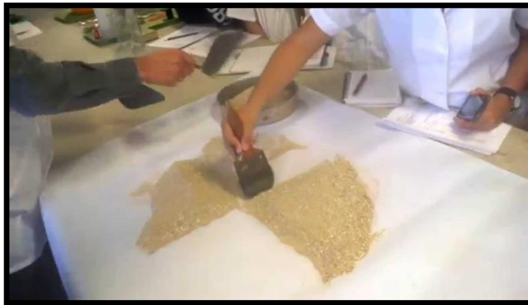
Figura 16: Cuarteo de la muestra, para que posteriormente sea colocado en la probeta.
