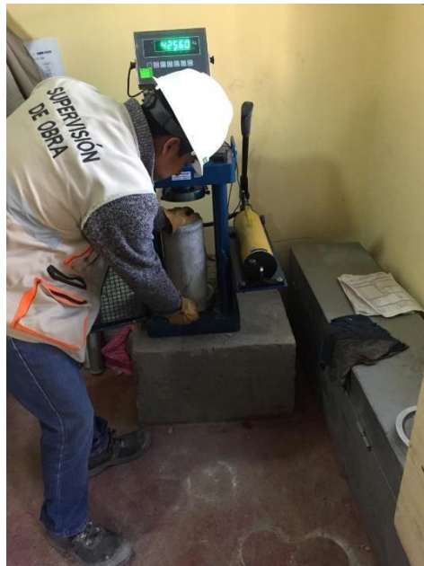
Figura 18: Extracción de la muestra de concreto fisurada.
