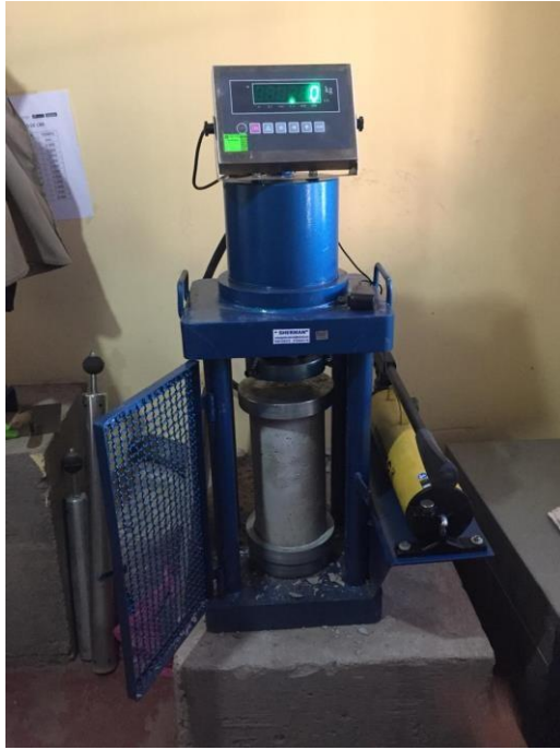
Figura 17: Colocación de la muestra de concreto en la prensa hidráulica.
