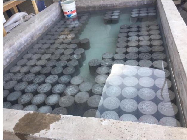
Figura 19: Curado de probetas de concreto autocompactante y convencional
