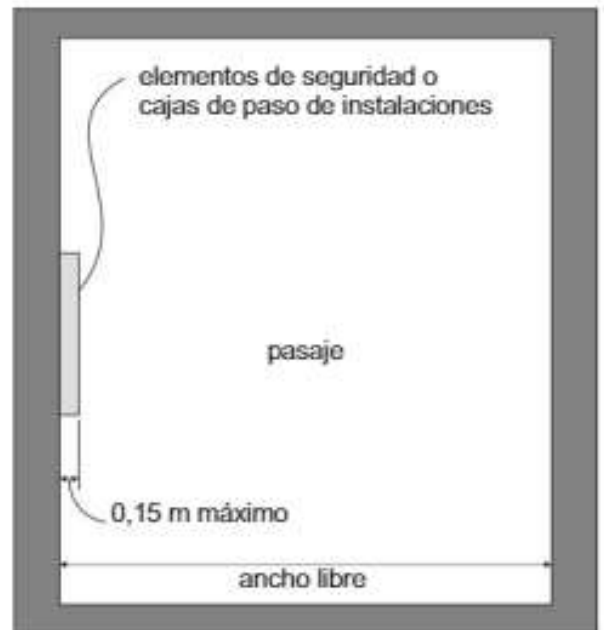
Figura 95: Elementos de Seguridad en Vía de Evacuación
