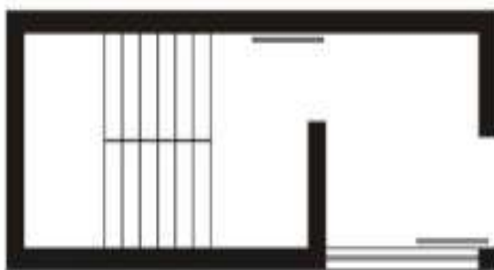
Figura 105: Cerramiento con Puerta Corta Fuego.
